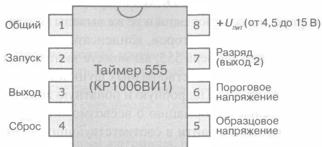
Рис. 11.14. Цоколевка микросхемы таймера 555
