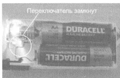
Рис. 3.3. Замыкание контактов переключателя создает проводящий путь в цепи электрического фонарика, обеспечивая, таким образом, устойчивый поток электронов
