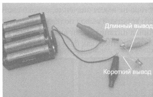
Рис. 3.7. Соединение компонентов в этой простой схеме со светодиодом выполняется с помощью зажимов типа “крокодил”
