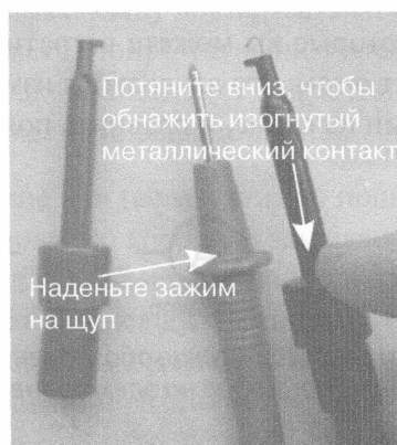
Рис. 16.2. Подпружиненные зажимы мультиметра предотвращают случайный контакт с какой-либо другой частью схемы
