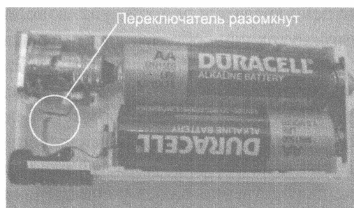
Рис. 3.2. Переключатель, переведенный в разомкнутое положение, отключает лампочку фонарика от батарейки, создавая, таким образом, разомкнутую цепь
