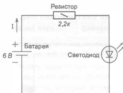
Рис. 3.6. Ток переносит электрическую энергию от источника питания (в данном случае — от батареи) к резистору и светодиоду
