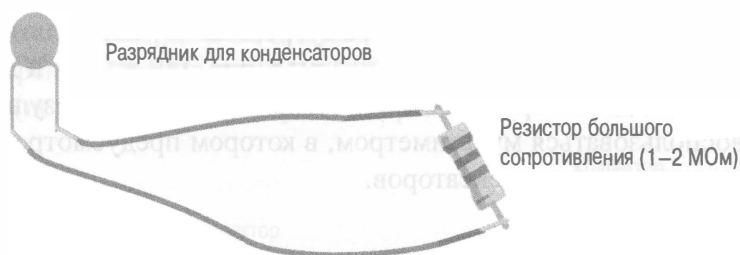
Рис. 16.11. Приобретите или изготовьте самостоятельно специальный разрядник, который используется для снятия остаточного заряда с конденсатора
