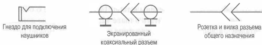
Рис. 14.12. УГО разъемных соединений
