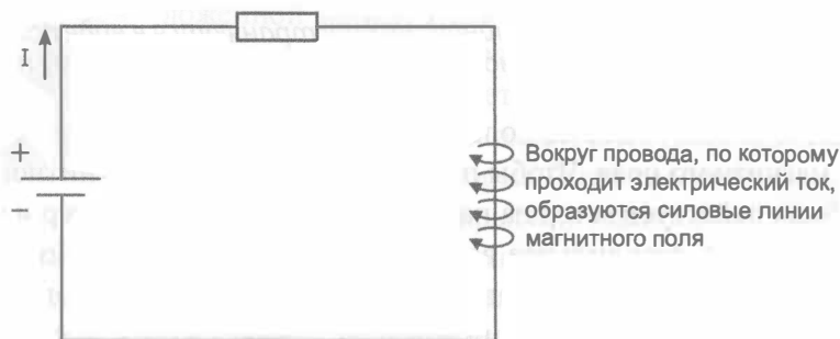
Рис. 8.2. Ток, проходящий через провод, создает вокруг этого провода слабое магнитное поле
