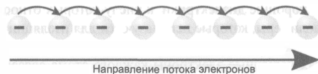
Рис. 1.4. Поток электронов через проводник является аналогией движения ведер с водой по цепочке людей при тушении пожара
