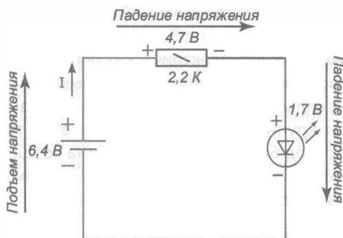
Рис. 3.13. Напряжение батарейного источника питания распределяется между резистором и светодиодом
