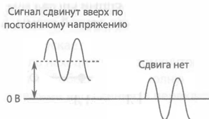
Рис. 10.8. Блокирующий конденсатор C1 помогает поддерживать смещение транзистора на должном уровне; он убирает постоянную составляющую входного сигнала перед его подачей на базу транзистора
