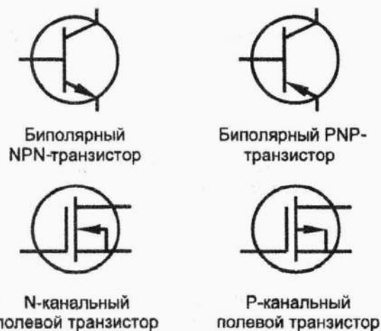
Рис. 6.5. Вариации на одну тему. Символы, обозначающие различные типы транзисторов
