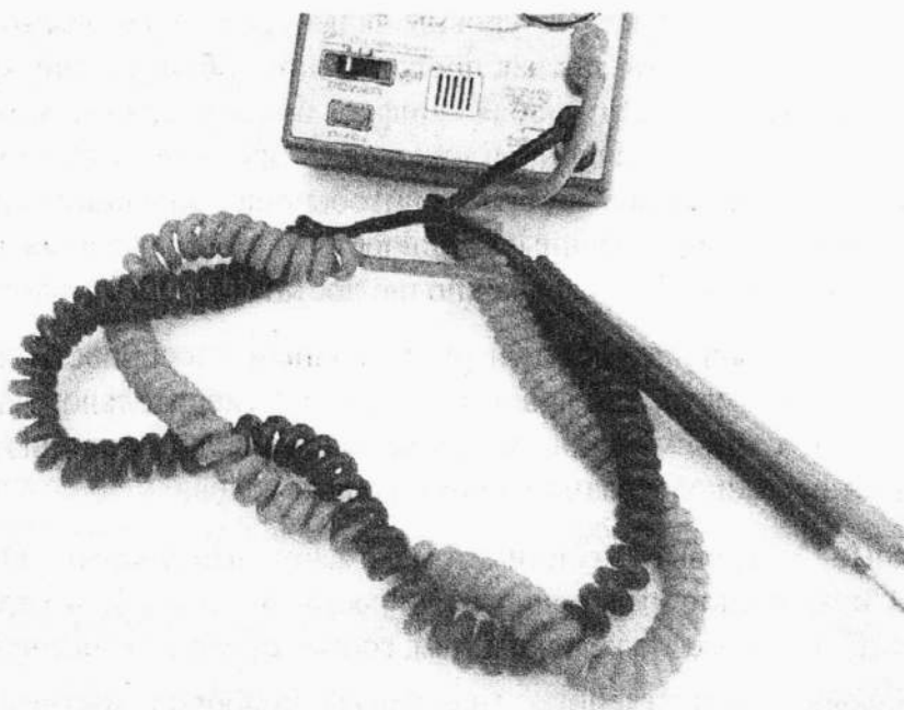
Рис. 9.5. Скрученные в спираль выводы можно при необходимости растянуть, а на время хранения вернуть в первоначальное состояние, чтобы они не занимали место
