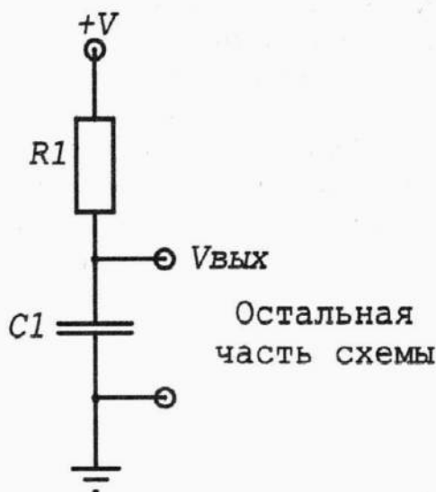
Рис. 7.8. Схема, состоящая из последовательно соединенных резистора и конденсатора
