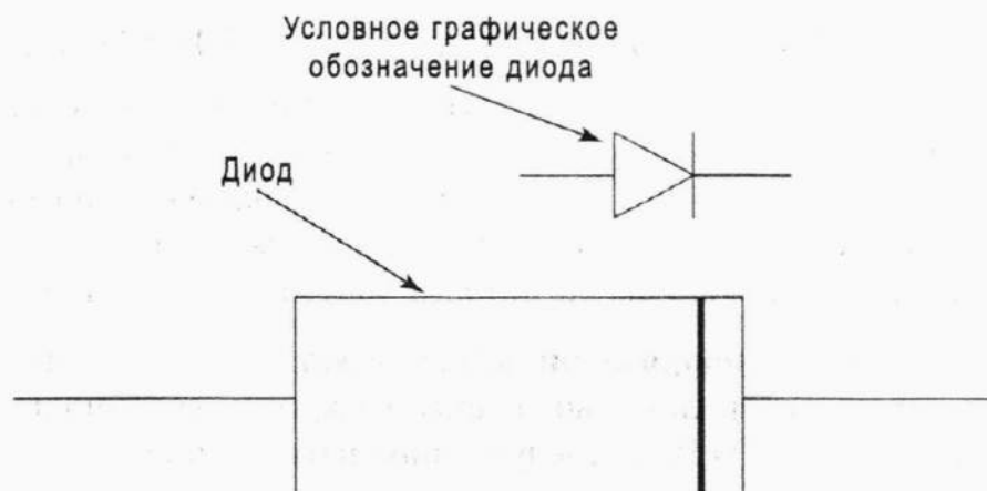
Рис. 4.8. Используя диоды, всегда помните об их полярности. Полоска на одном из концов корпуса диода указывает его катод
