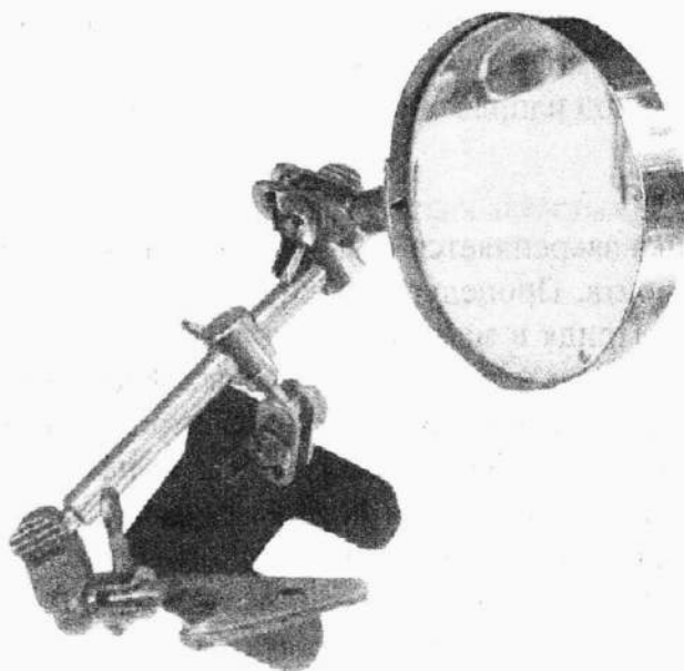
Рис. 8.2. Зажим в виде струбцины служит для крепления деталей во время пайки. Лучше купить его сразу с увеличительным стеклом
