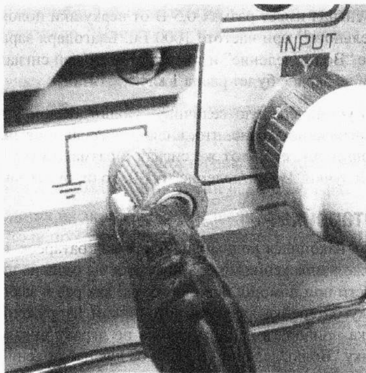
Рис. 10.10. Подключите земляной щуп к специальному гнезду на корпусе осциллографа
