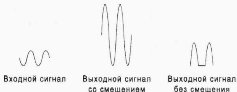
Рис. 7.12. Посередине показан сигнал, усиленный полностью благодаря смещению базы транзистора
