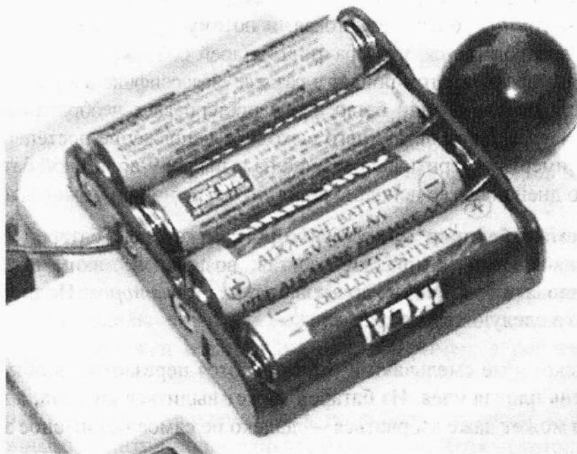
Рис. 5.5. Четыре 1,5-вольтовых батареи, уложенные в специальный отсек, позволяют получить на его выводах напряжение 6 В
