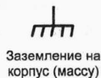
Рис. 6.2. Обычное заземление и заземление на массу — не одно и то же, и поэтому они имеют разные схемотехнические обозначения
