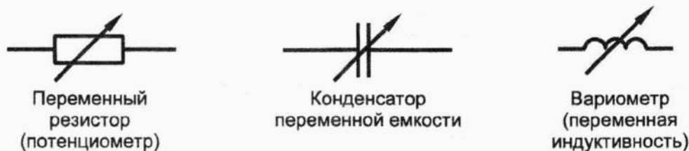
Рис. 6.8. Условные символы переменных компонентов; стрелка или другая специальная метка указывают на то, что элемент имеет изменяемый параметр
