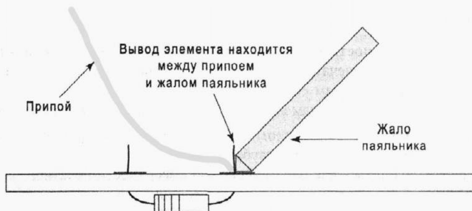
Рис. 8.5. Прикладывайте разогретый наконечник паяльника к радиоэлементу, а не к припою! Именно разогрев выводов радиоэлементов обеспечивает хорошее соединение пайкой
