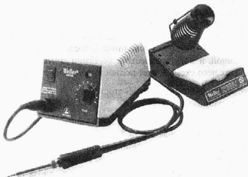
Рис. 8.1. Наиболее продвинутые модели паяльников имеют регулятор температуры и подставку
