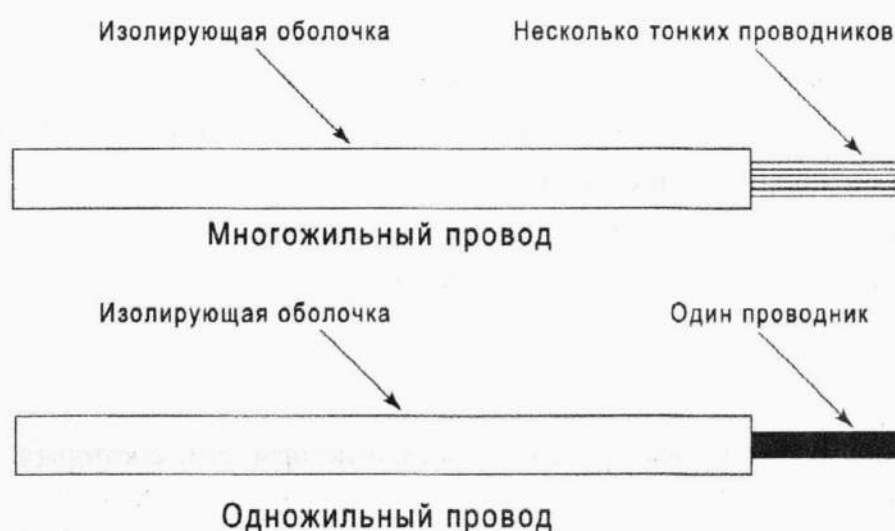
Рис. 5.1. Думаете, провод — такая простая штука? Как бы не так — он бывает двух разных типов
