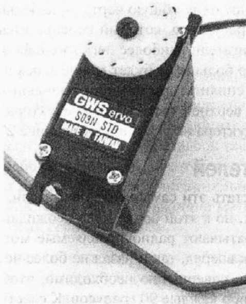
Рис. 15.11. Стандартный управляемый по радио серводвигатель
