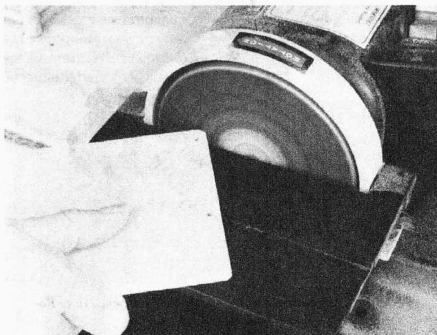
Рис. 15.3. Снимите с острых углов выпиленных пластин фаску, чтобы обезопасить себя от ненужных царапин
