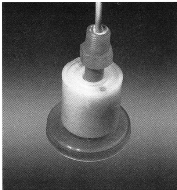
Рис. 29.4. Простой и дешевый датчик уровня жидкости — магнит внутри поплавка активирует геркон, установленный в пластмассовом стержне, по которому перемещается поплавок
