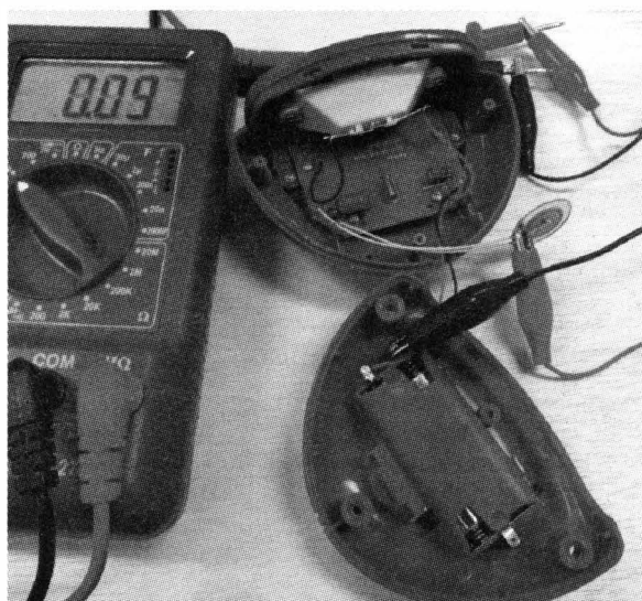
Рис. 7.10. Замеры напряжения на зуммере внутри часов выполняйте, используя соединительные провода с «крокодилами» для закрепления щупов в нужном месте, — чтобы руки оставались незаняты. Зуммер в этих часах — маленький тонкий полупрозрачный диск, на одном из паяных соединений которого закреплен «крокодил»
