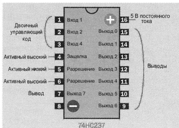
Рис. 20.6. Цоколевка микросхемы дешифратора 74HC237
