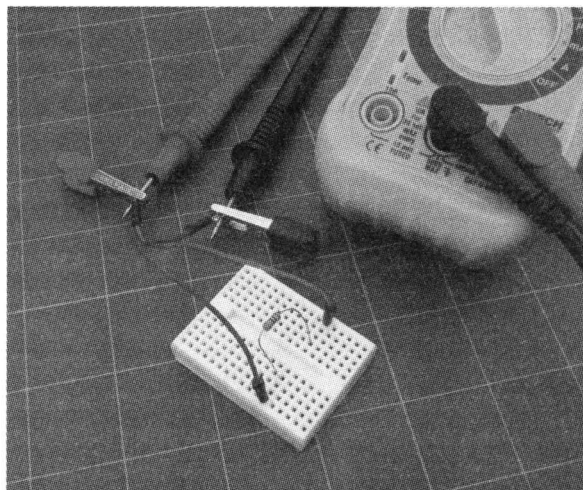
Рис. О.16. Простая схема для быстрой проверки номиналов резисторов, прежде чем использовать их в проекте
