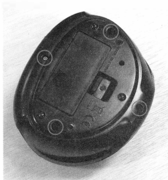
Рис. 7.5. Чтобы вскрыть корпус этих часов, нужно выкрутить четыре винта (обведены светлыми кружками) на нижней панели корпуса
