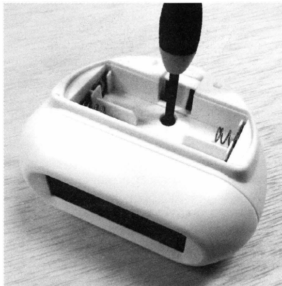
Рис. 7.6. Корпус этих часов удерживается закрытым только одним винтом, но он спрятан в отсеке для батареек
