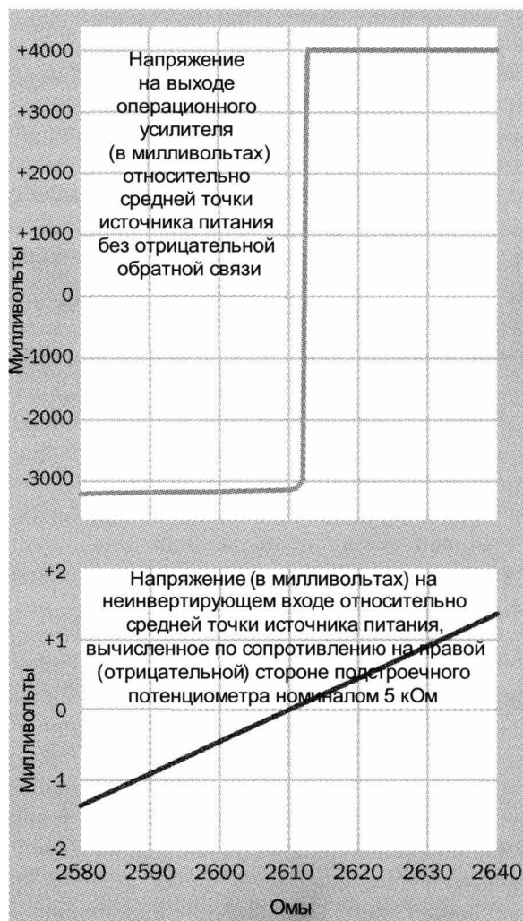
Рис. 11.2. Линейное изменение напряжения на неинвертирующем входе операционного усилителя (нижний график). Напряжение на выходе операционного усилителя, соответствующее напряжению на входе, равному половине напряжения питания операционного усилителя (верхний график)
