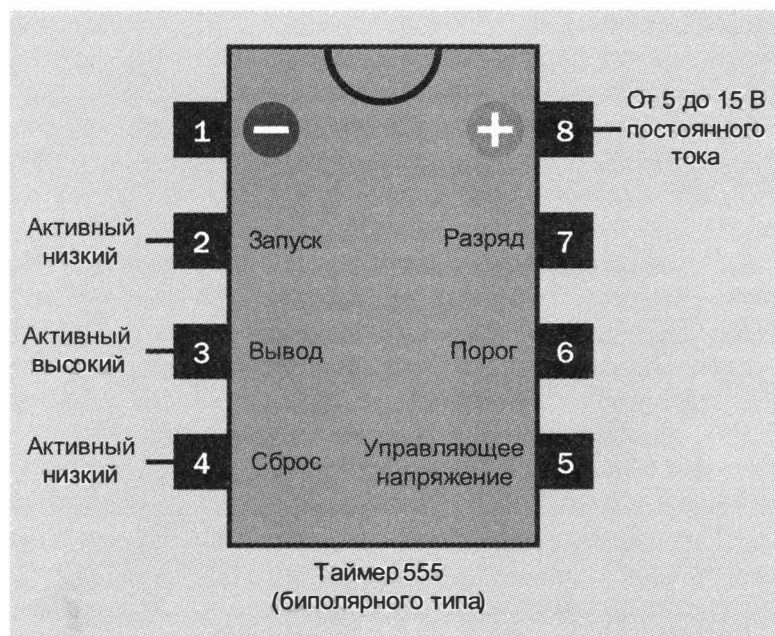
Рис. 3.4. Цоколевка микросхемы таймера 555. Диапазон напряжений источника питания применим только к оригинальной версии микросхемы биполярного типа
