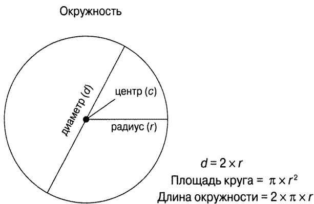
Рис. 12.7. Определение площади круга и длины окружности по ее радиусу ( r )
