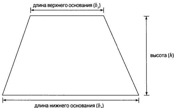
Рис. 12.4. Площадь трапеции определяется по длине двух оснований ( b_1 и b_2 ) и высоте ( h )
