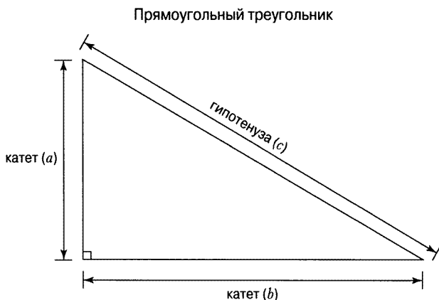
Рис. 12.6. Определение длины гипотенузы (c) прямоугольного треугольника по теореме Пифагора
