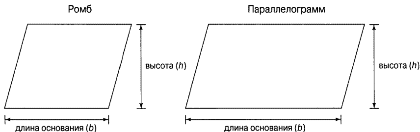
Рис. 12.3. Площадь ромба или параллелограмма определяется по длине его основания ( b ) и высоте ( h )
