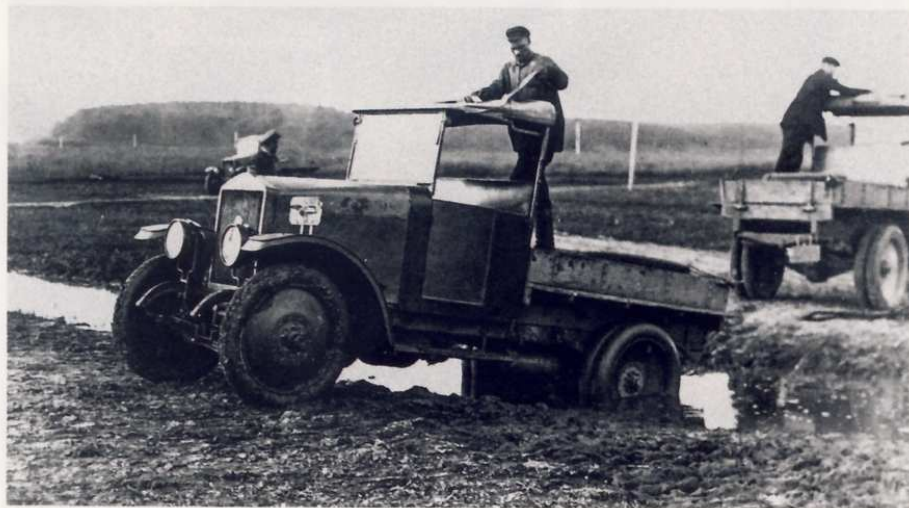
Грузовик АМО Ф-15, послуживший базой для автобусов
