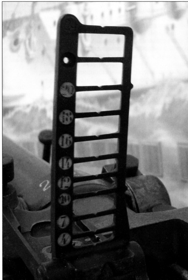
Рамочный откидной прицел для орудий системы Гочикиса
