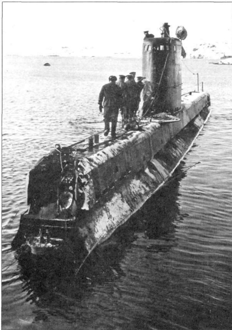
Подводная лодка «М-174» после подрыва на противолодочной контактной мине УМВ 23 марта 1943 г.
