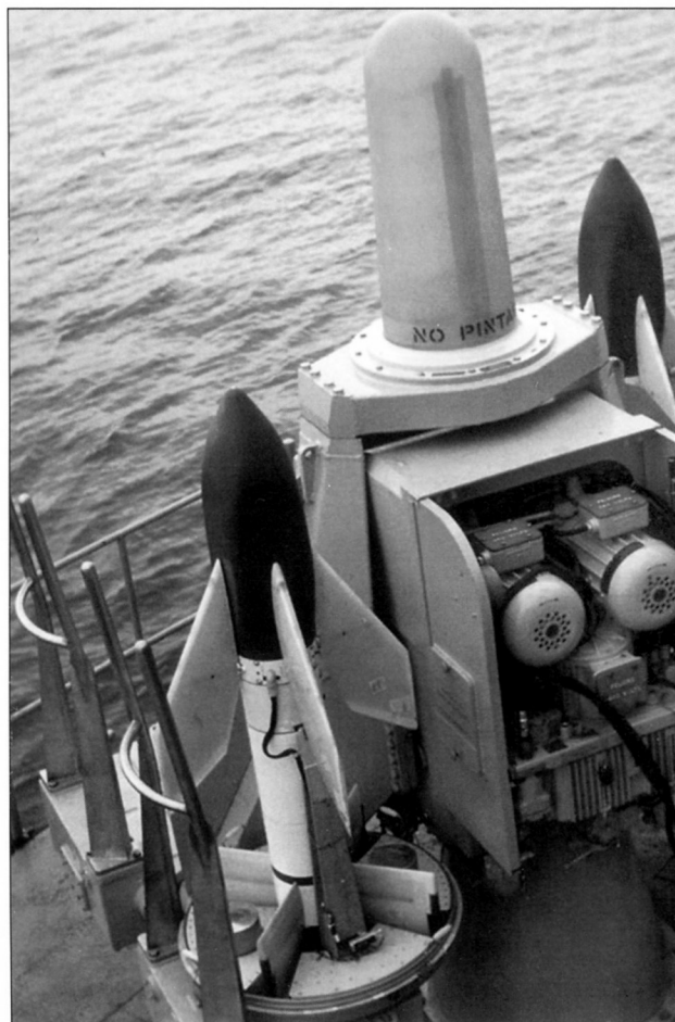
«Генерал Бельграно» оказался единственным «бруклином», получившим на вооружение зенитно-ракетный комплекс. Пусковые установки «Си Кэт» (внизу) располагались на кровлях мостика (вверху)
