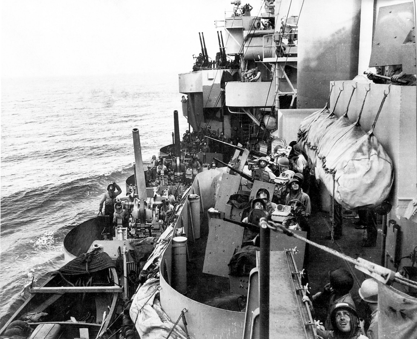
Вверху: зенитная батарея 127-мм орудий, 40-мм «бофорсов» и 20-мм «эрликонов» крейсера «Феникс», декабрь 1944 года
