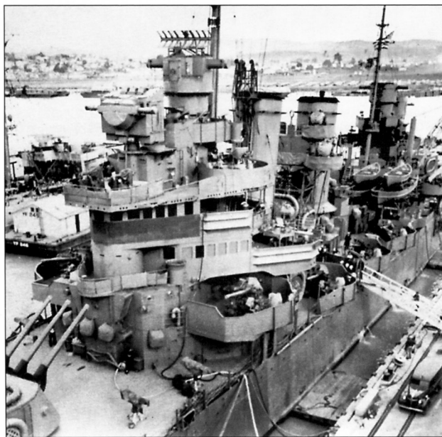
Приборы управления огнем крейсера «Гонолулу». Командно-дальномерные посты главного (Mk.34) и зенитного (Mk.33) калибров на носовой (слева) и кормовой (справа) надстройках. Снимки сделаны на верфи «Мэйр Айленд» в январе 1942 года в ходе ремонта, когда на носовом КДП главного калибра была смонтирована антенна РЛС управления огнем Mk.3
