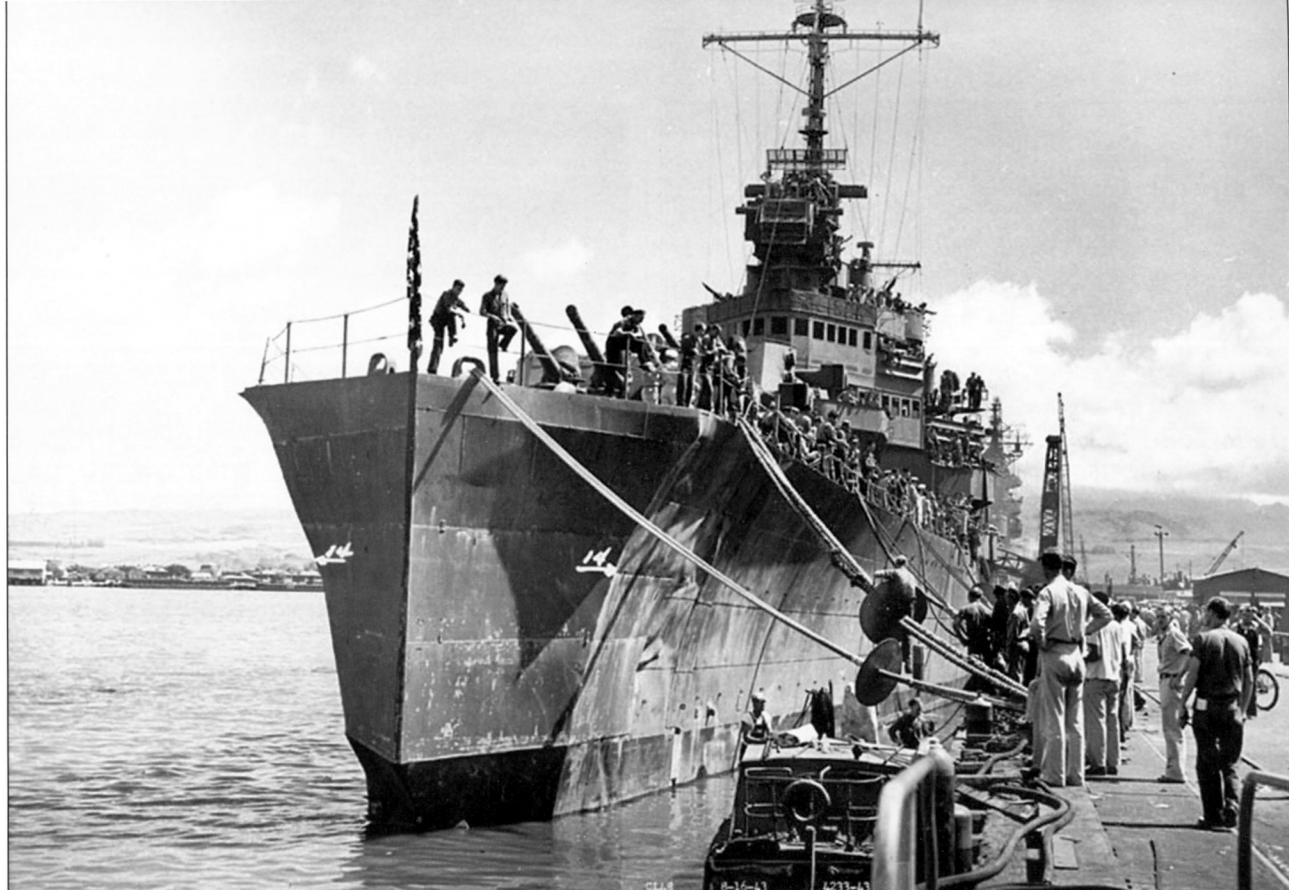
«Гонолулу» на верфи Перл Харбора 16 (вверху) и 18 (внизу) августа 1943 г. На верхнем снимке хорошо видна конструкция временной носовой оконечности. На нижнем снимке временный нос уже демнтирован до 21 шпангоута, корабль готовится к вводу в док
