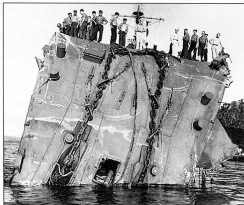
Повреждения «Гонолулу», полученные в результате торпедного попадания во время боя у Коломбангара 17 июля 1943 года. Оба снимка сделаны в Тулаги
