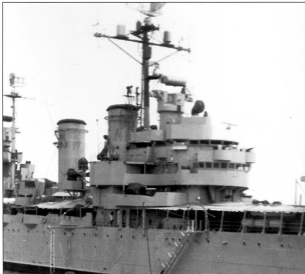
«Генерал Бельграно» оказался единственным «бруклином», получившим на вооружение зенитно-ракетный комплекс. Пусковые установки «Си Кэт» (внизу) располагались на кровлях мостика (вверху)
