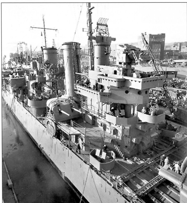
«Хелена» по окончании ремонта и модернизации на верфи «Мэйр Айленд», 27 июля 1942 года. На КДП Mk.34 и Mk.33 смонтированы антенны РЛС управления огнем Mk.3 и Mk.4
