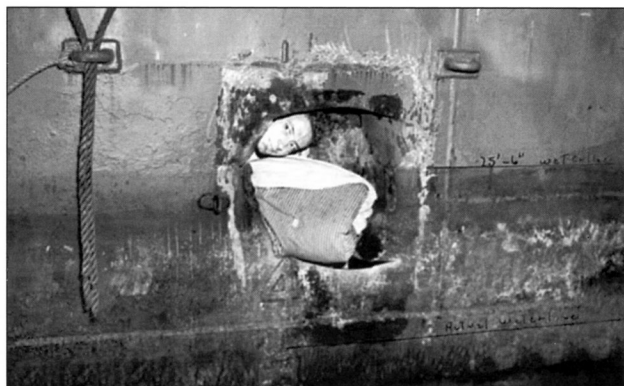
Пробоина от невзорвавшейся торпеды в корме «Гонолулу». Тулаги, 13 ибля 1943 г.
