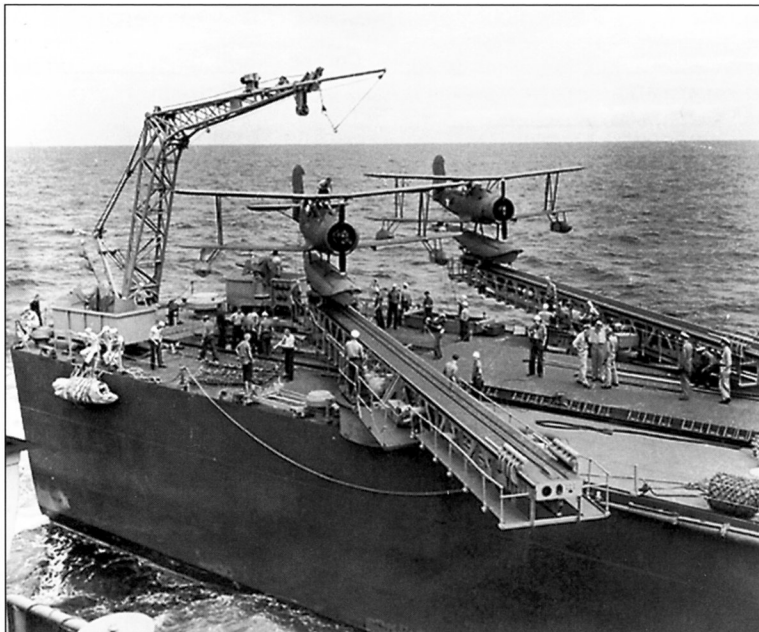
Вверху: гидросамолеты SOC «Сигалл» на катапультных устройствах одного из крейсеров типа «Бруклин», январь 1943 года
