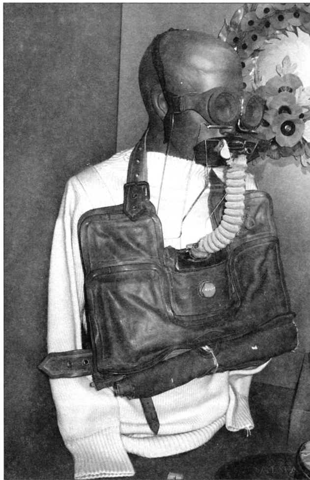
Дыхательный аппарат для водителей «Чериотов» создавался на основе такого аппарата конструкции Дэвиса
