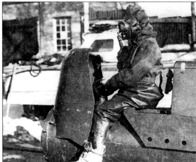
Командир боевой «двойки» на своем месте. Обратите внимание, что боевое зарядное отделение на данном «Чериоте» отстыковано. В таком варианте «Чериоты» активно использовались для разведки районов побережья противника в местах планируемых морских десантных операций
