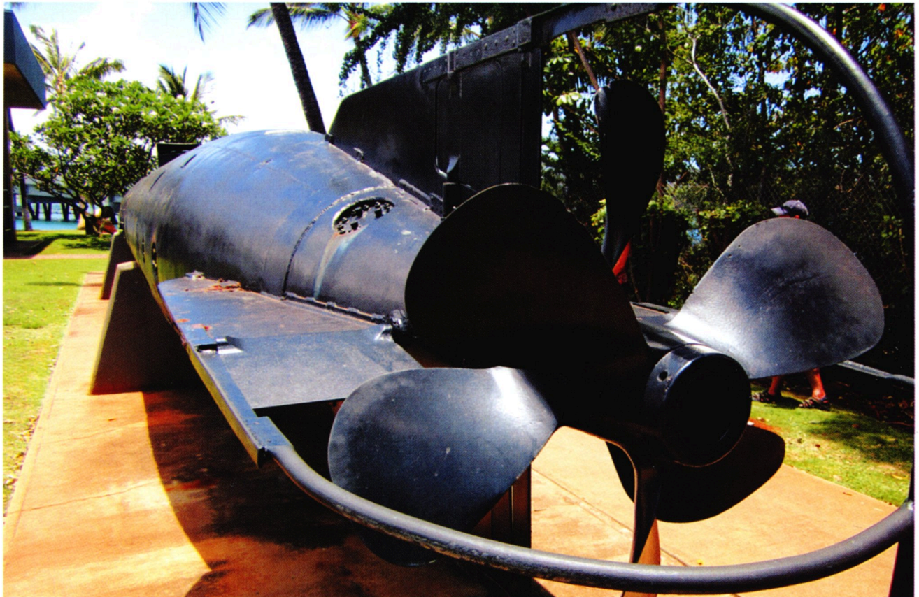
Вид на винто-рулевую группу человекоуправляемой торпеды «Кайтен Тип 4»
