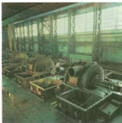
Сборка уникальных турбин.
