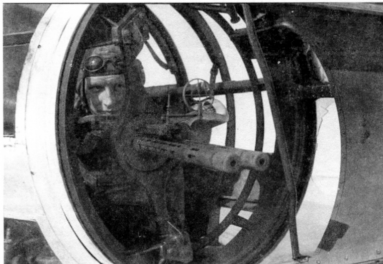
Вверху: верхняя стрелковая установка самолета Fw 189A-2 со спаренным пулеметом MG 81Z
