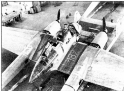
Завершающий этап сборки Fw 189A-1 на заводе в Бремене
