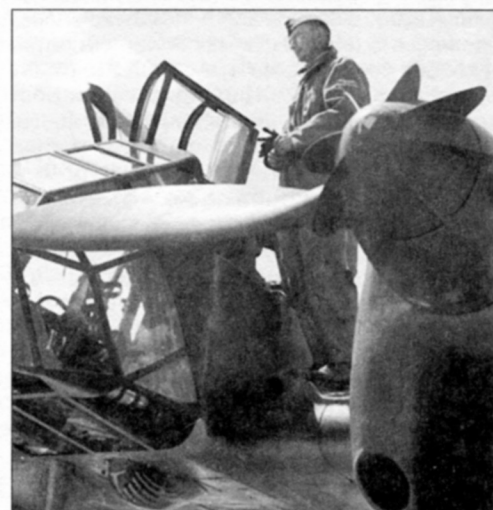
«Рама» на стоянке. Видно, каким образом открывались створки фонаря, обеспечивая экипажу доступ в кабину
