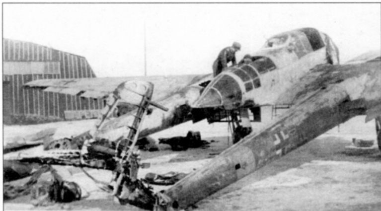
Сильно поврежденный Fw 189A-1 из отряда 12.(Н)/AufklGr 13. Машина имеет усиленное вооружение: в верхней установке сохранен одиночный пулемет MG 15, но в хвостовом конусе установлена спарка MG 81Z от самолета Fw 189A-2. Восточный фронт, конец 1943 г.
