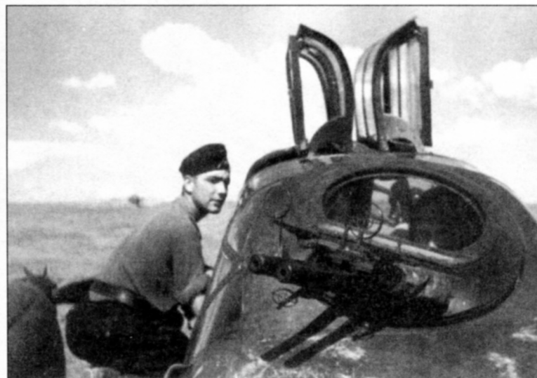
Подготовка к вылету Fw 189A-2. Видны верхняя стрелковая установка и откинутые створки фонаря
