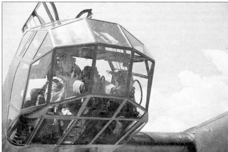
Богато остекленная кабина Фв 189 обеспечивала прекрасный обзор. Все остекление набрано из плоских панелей, дабы не искажать изображение
