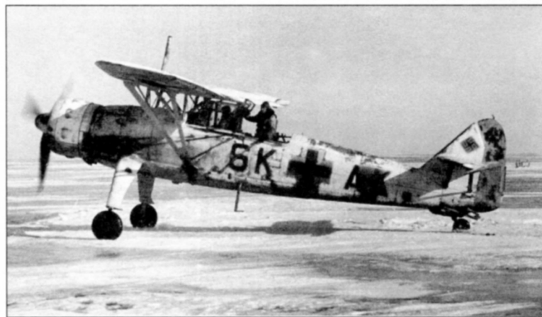
Hs 126 из отряда 2.(H)/AufklGr 23 на поле аэродрома в районе Калинина, начало зимы 1941 г. Ранее самолет использовался в качестве буксировщика десантных планеров — за хвостовым колесом видно сцепное устройство
