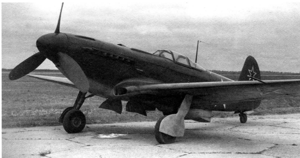
Як-9У с ВК-107А с металлическим крылом (заводской № 01-03, построен в Новосибирске). Государственные испытания. Сентябрь 1946 г.
