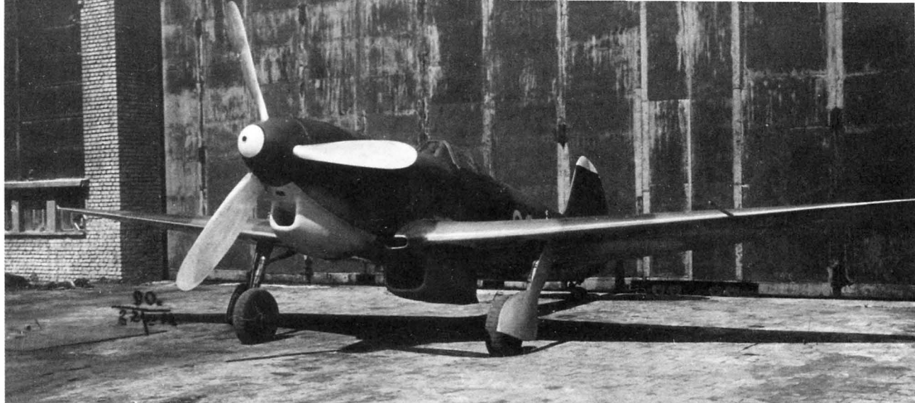
Як-9ПД с двигателем ВК-105ПД после исследований радиаторных установок в аэродинамической трубе ЦАГИ Т-104
