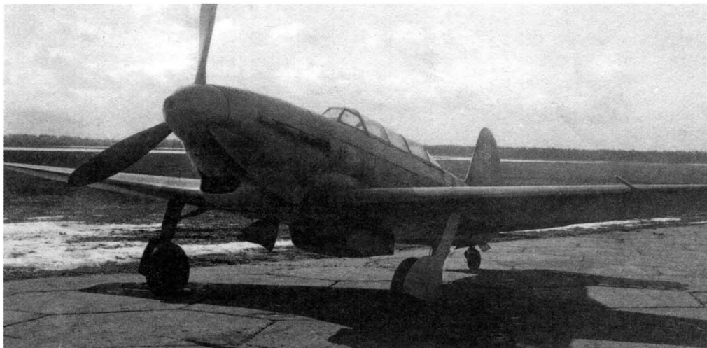
Як-9В с ВК-105ПФ на государственных испытаниях. Заводской № 11-01, построен в Омске, модифицирован в спарку на заводе № 301. Март 1945 г.
