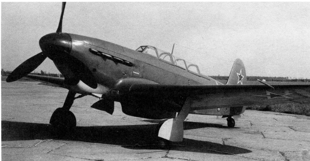
Як-9В с двигателем ВК-105ПФ (заводской № 05-24, выпущен заводом № 153). Государственные испытания. Лето 1946 г.
