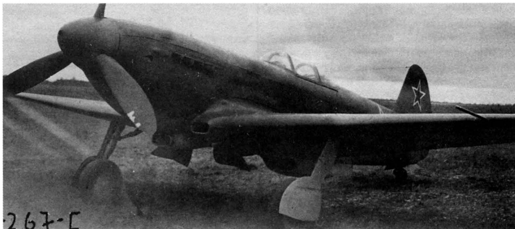
Як-9 с двигателем ВК-105ПВ оснащенным нагнетателем Э100
