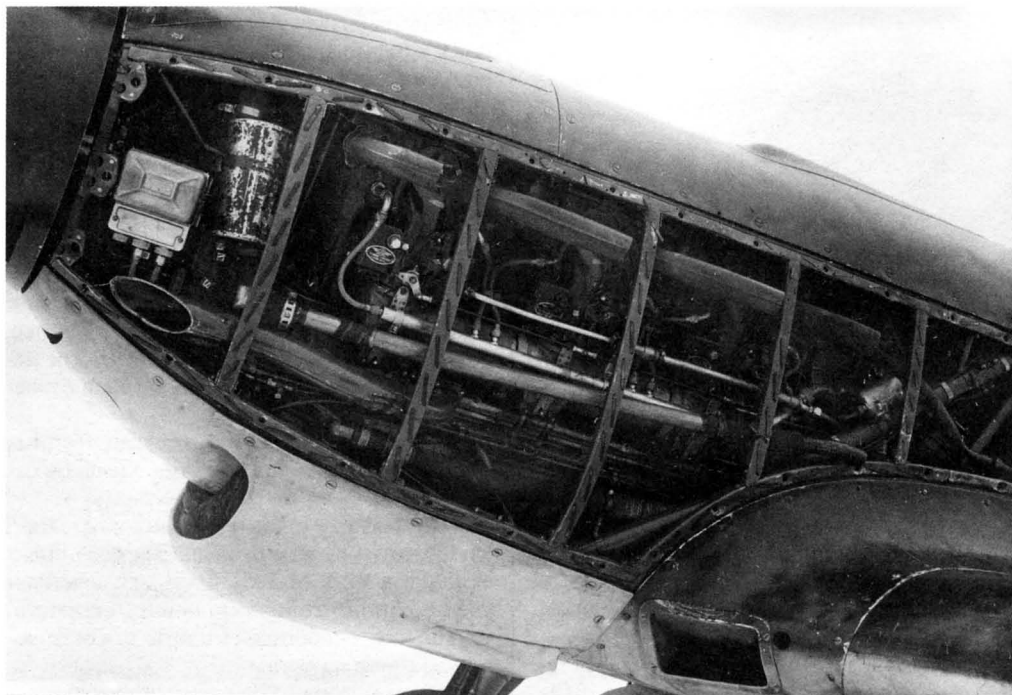
Маслосборный бачок с отсасывающим дренажом, выведенным за капот мотора самолета Як-9 с мотором М-106-1ск и ВИШ-61П (№ 2391, завод №115). Госиспытания, октябрь 1942 г.
