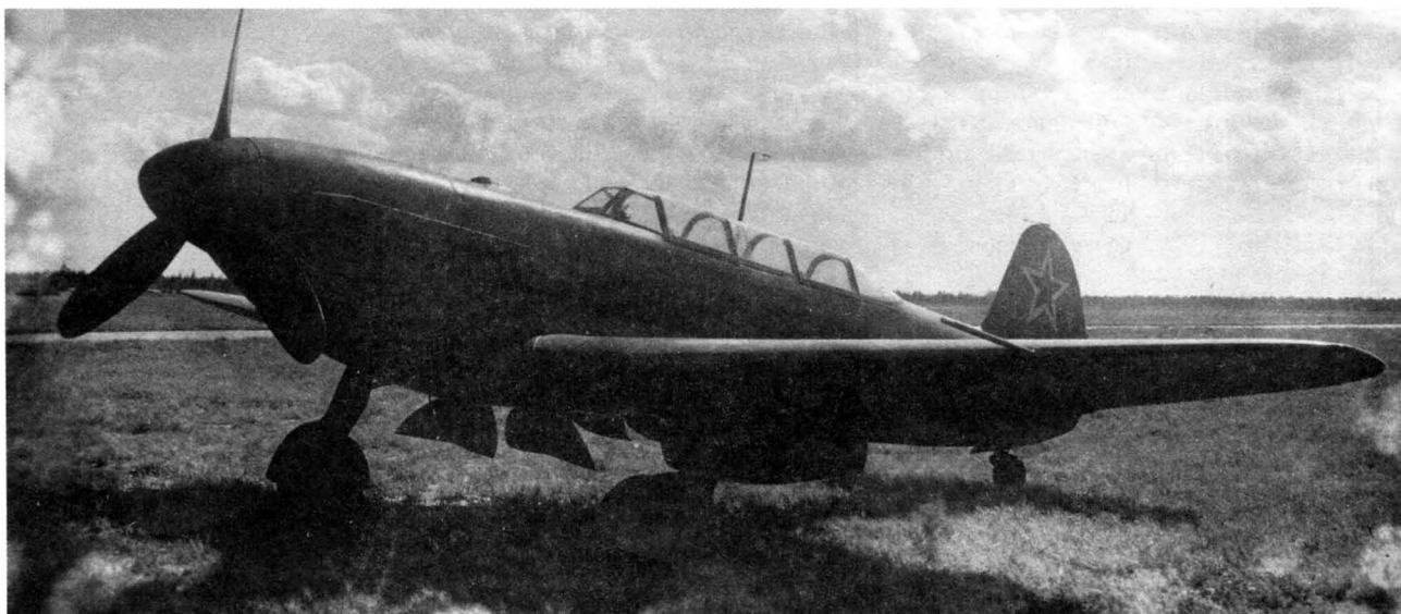
Як-9УВ с двигателем ВК-107А и винтом ВИШ-107ЛО (заводской № 0000, завод № 82, выпущен в июле 1945 г.) Государственные испытания. Сентябрь 1945 г.
