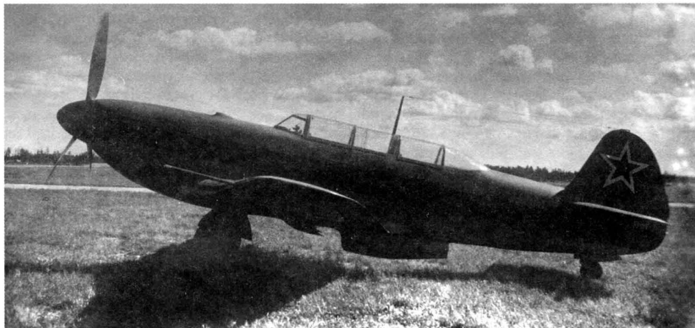
Як-9УВ с двигателем ВК-107А и винтом ВИШ-107ЛО (заводской № 0000, завод № 82, выпущен в июле 1945 г.) Государственные испытания. Сентябрь 1945 г.
