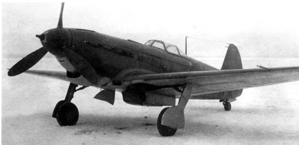
Опытный Як-9 с М-105ПФ и винтом ВИШ-105СВ, выпущенный заводом № 153 (модификация завода №115) и оснащенный 37 мм пушкой МП-37
