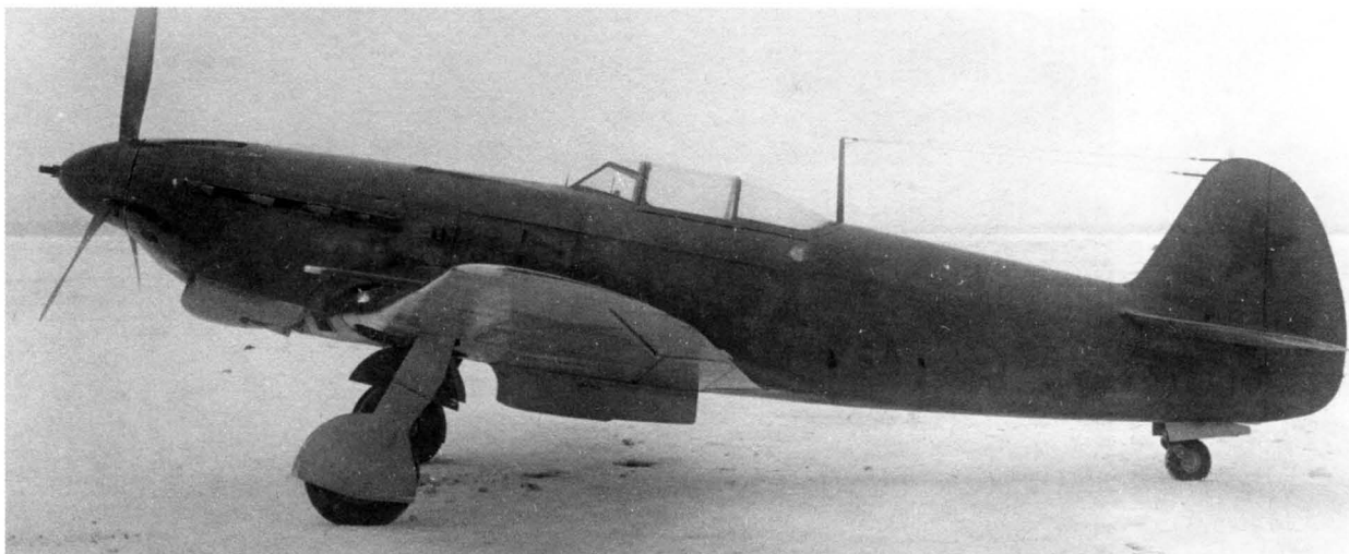
Опытный Як-9 с М-105ПФ и винтом ВИШ-105СВ, выпущенный заводом № 153 (модификация завода №115) и оснащенный 37 мм пушкой МП-37
