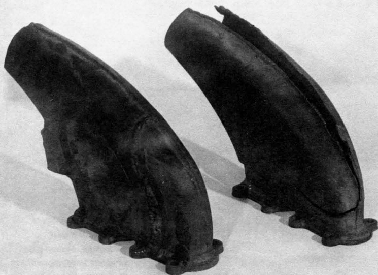
Разрушение выхлопных патрубков в полете. Як-9 с мотором М-106-1ск и ВИШ-61П (№ 2391, завод №115). Госиспытания, октябрь 1942 г.
