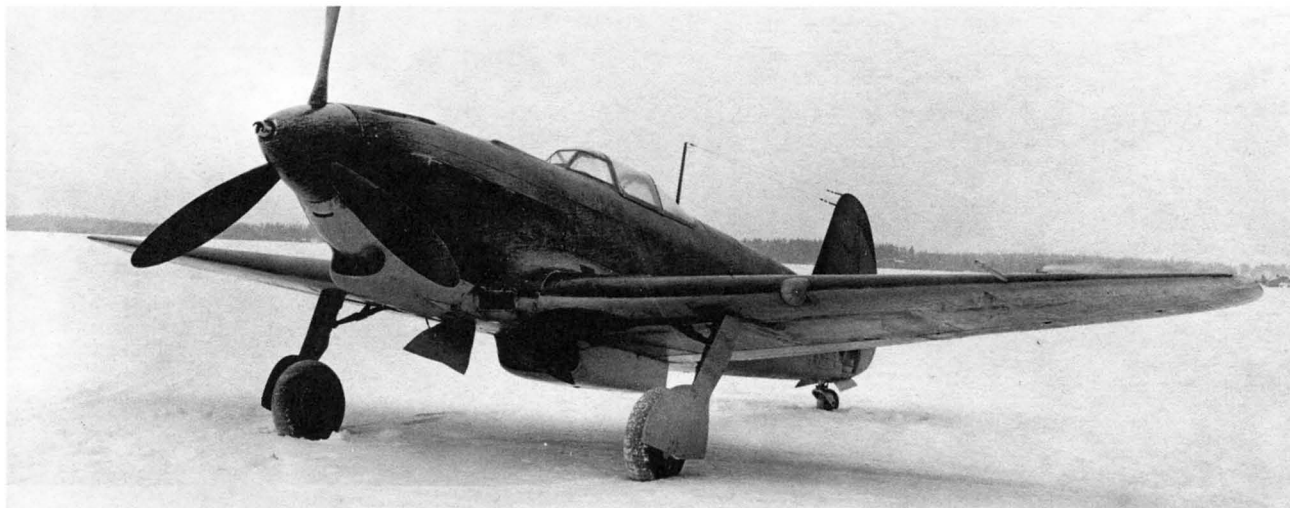
Як-9 с мотором М-106-1ск и ВИШ-61П (№ 2391, завод №115). Госиспытания, октябрь 1942 г.
