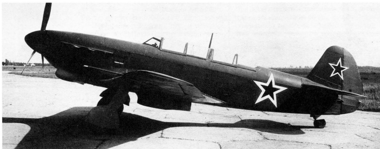
Як-9В с двигателем ВК-105ПФ (заводской № 05-24, выпущен заводом № 153). Государственные испытания. Лето 1946 г.
