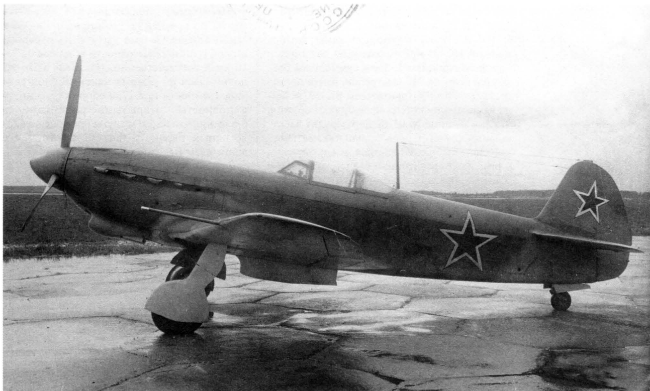
На обоих снимках: Як-9С с ВК-105ПФ и винтом ВИШ-105СВ (заводской № 01-01 производства завода № 153, выпущен в мае 1945 г.). Самолет оснащен мотор-пушкой НС-23 и двумя синхронными орудиями Б-20С. Государственные испытания, октябрь 1945 г.
