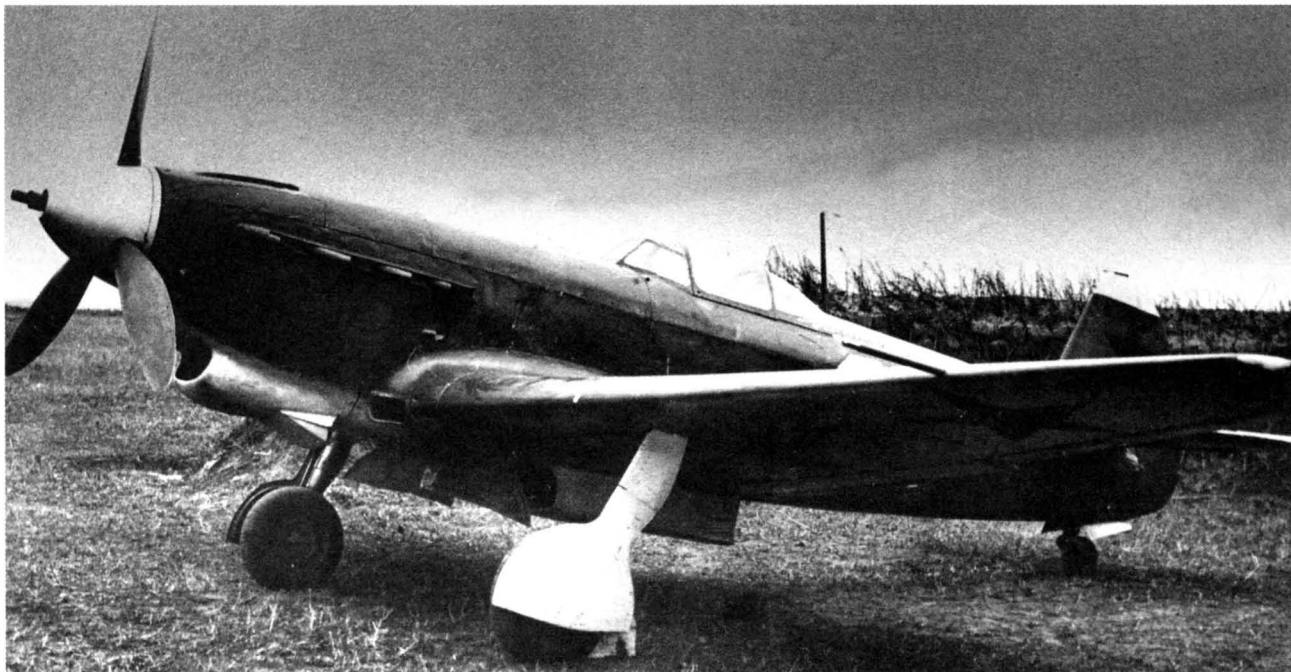
Як-9Т с двигателем М-105ПФ и пушкой НС-37 на войсковых испытаниях. 1943 г.
