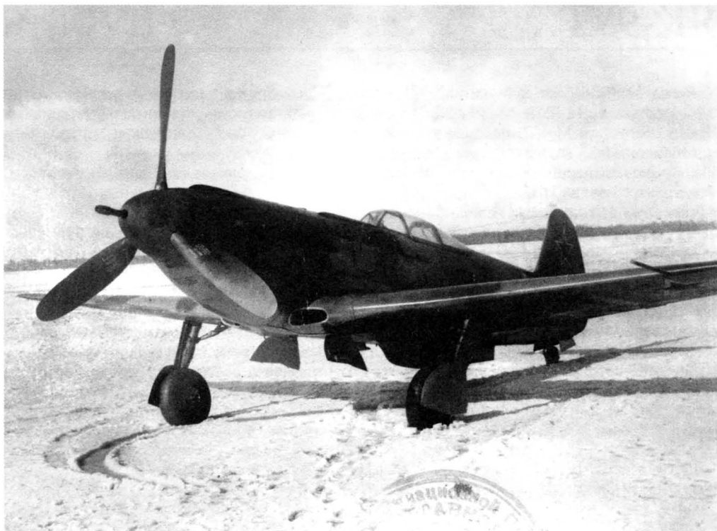
Як-9УТ с мотором ВК-107А (заводской № 40-022 завода № 166) Самолет оснащен пушкой Н-37 и двумя синхронными орудиями Б-20. Государственные испытания. Апрель 1945 г.
