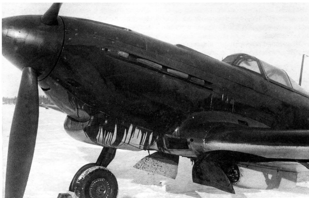
В ходе госиспытаний Як-9 с мотором М-106-1ск и ВИШ-61П (зав. № 2391, завода №115) в октябре 1942 года обнаружился выброс масла в полете при 2700 оборотах двигателя в минуту (заправка масла — 40 литров)
