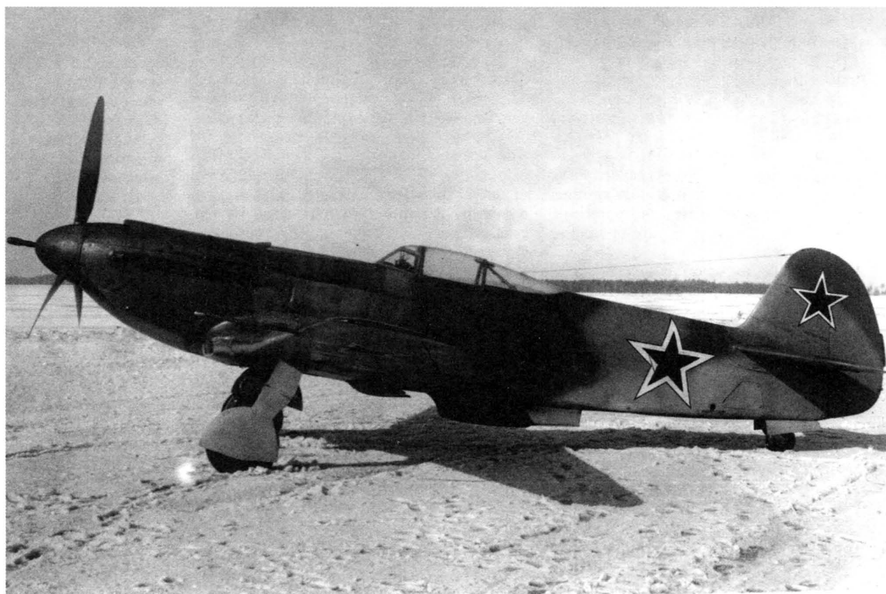
Як-9УТ с мотором ВК-107А (заводской № 40-022 завода № 166) Самолет оснащен пушкой Н-37 и двумя синхронными орудиями Б-20. Государственные испытания. Апрель 1945 г.
