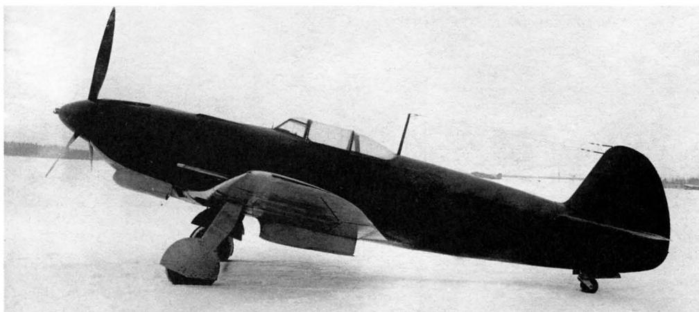
Як-9 с мотором М-106-1ск и ВИШ-61П (№ 2391, завод №115). Госиспытания, октябрь 1942 г.
