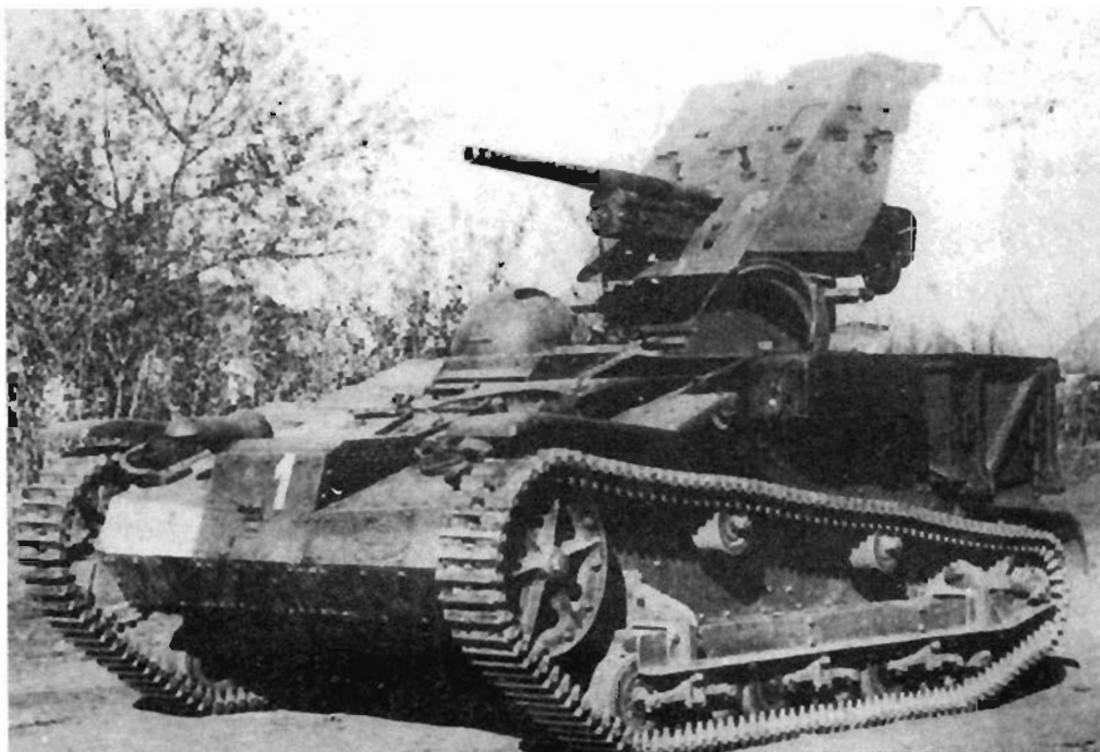
Часть трофейных танкеток Renault UE немцы переоборудовали в САУ с 37-мм противотанковыми пушками.
