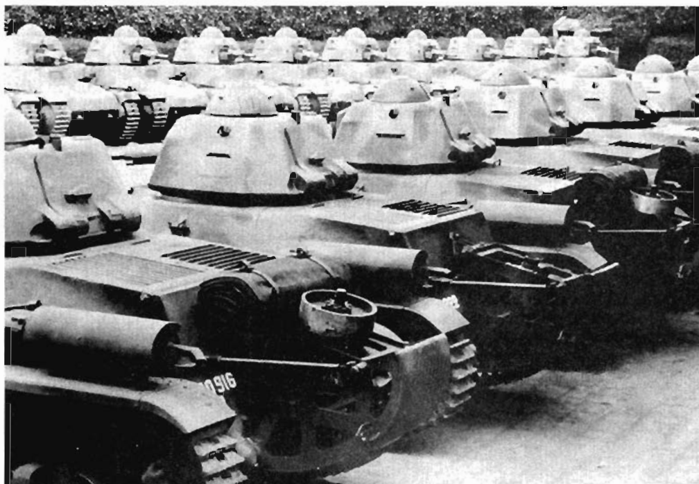
Танки H39 на заводском дворе. Все машины оборудованы «хвостами».
