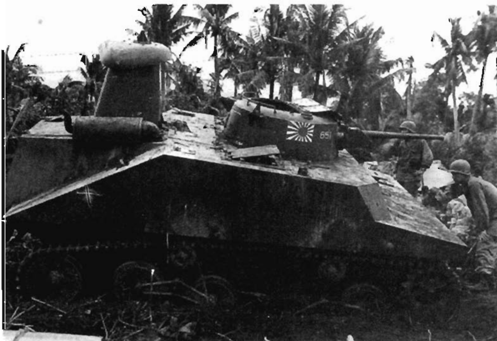
Подбитый плавающий танк «Ка-ми». Хорошо видны гребные винты.
