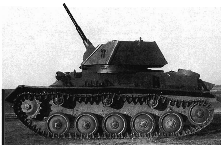
Легкий танк Т-80. Орудие поднято на максимальный угол возвышения.
