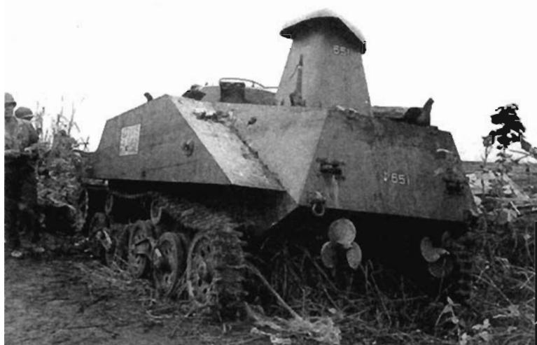
Подбитый плавающий танк «Ка-ми». Хорошо видны гребные винты.
