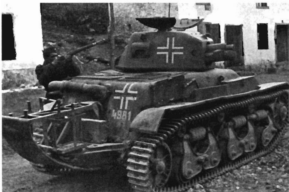
Легкий танк R35 в Вермахте. Балканы, 1943 г. На трофейных танках немцы заменяли куполообразную крышку башенного люка простой двухстворчатой.
