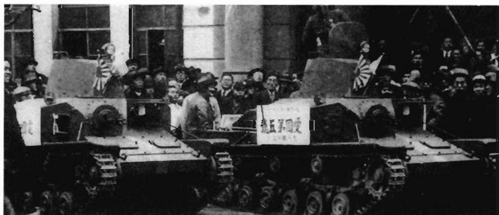
Легкие танки 2592, вооруженные 6,5-мм пулеметами.
