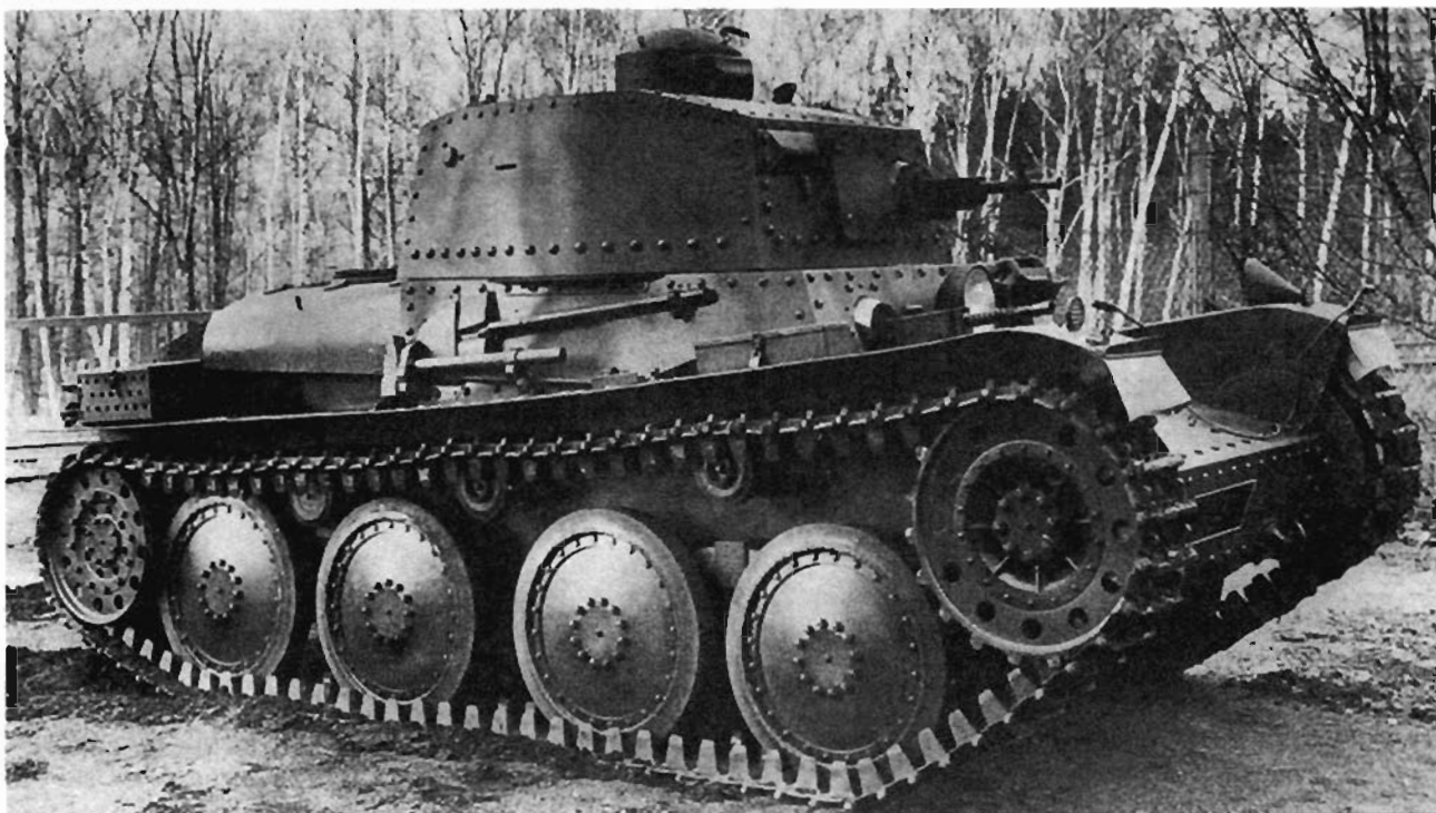
Легкий танк LT vz. 40. с пулеметным вооружением.
