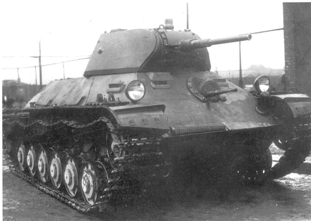
Опытный образец танка Т-126СП (с броней 45 мм), общие виды. Башня изготовлена из катаных бронелистов, машина имеет опорные катки с внутренней амортизацией (РГВА).
