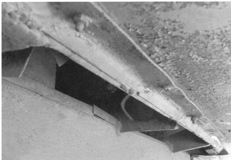
Отверстие для выброса охлаждающего воздуха от двигателя и выхлопных газов над левой гусеницей танка.
