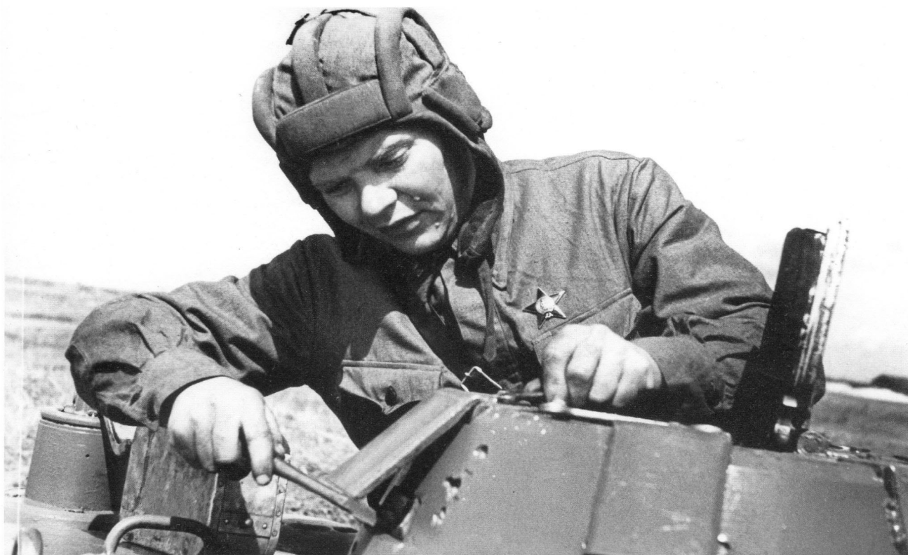
Техник старший лейтенант Ланкин ремонтирует командирскую башенку танка Т-50. Ленинградский фронт, 1942 год. Обратите внимание на следы от попаданий пуль или осколков на корпусе башенки (РГАКФД).
