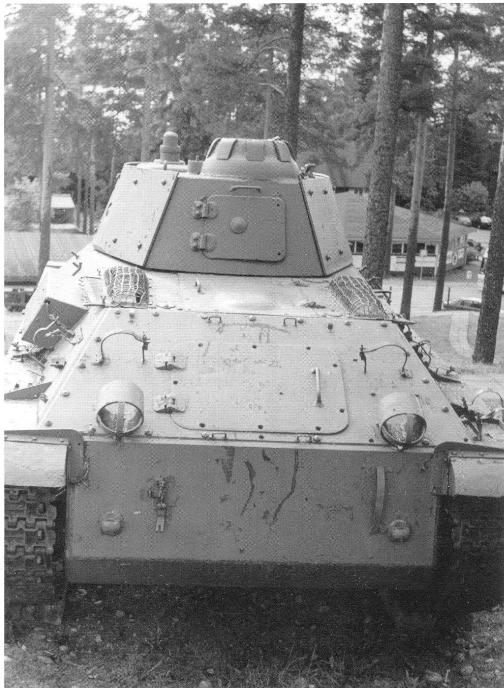
Трофейный танк Т-50 в экспозиции танкового музея в Пароле, Финляндия, вид сзади. На корме видны крепления для домкратов и другого ЗИПа, сделанные финнами.
