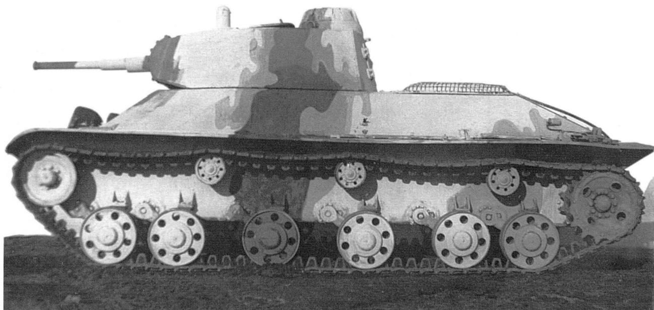
Танк Т-50 во время испытаний зимней маскировочной окраски, вид слева. НИБТ полигон, сентябрь-октябрь 1941 года (ЦАМО).
