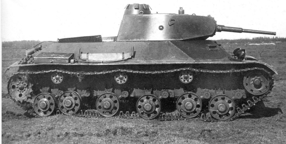
Опытный танк Т-50 во время испытаний на АНИОПе, вид справа. Апрель-май 1941 года. Пушка на максимальном угле снижения (ЦАМО).
