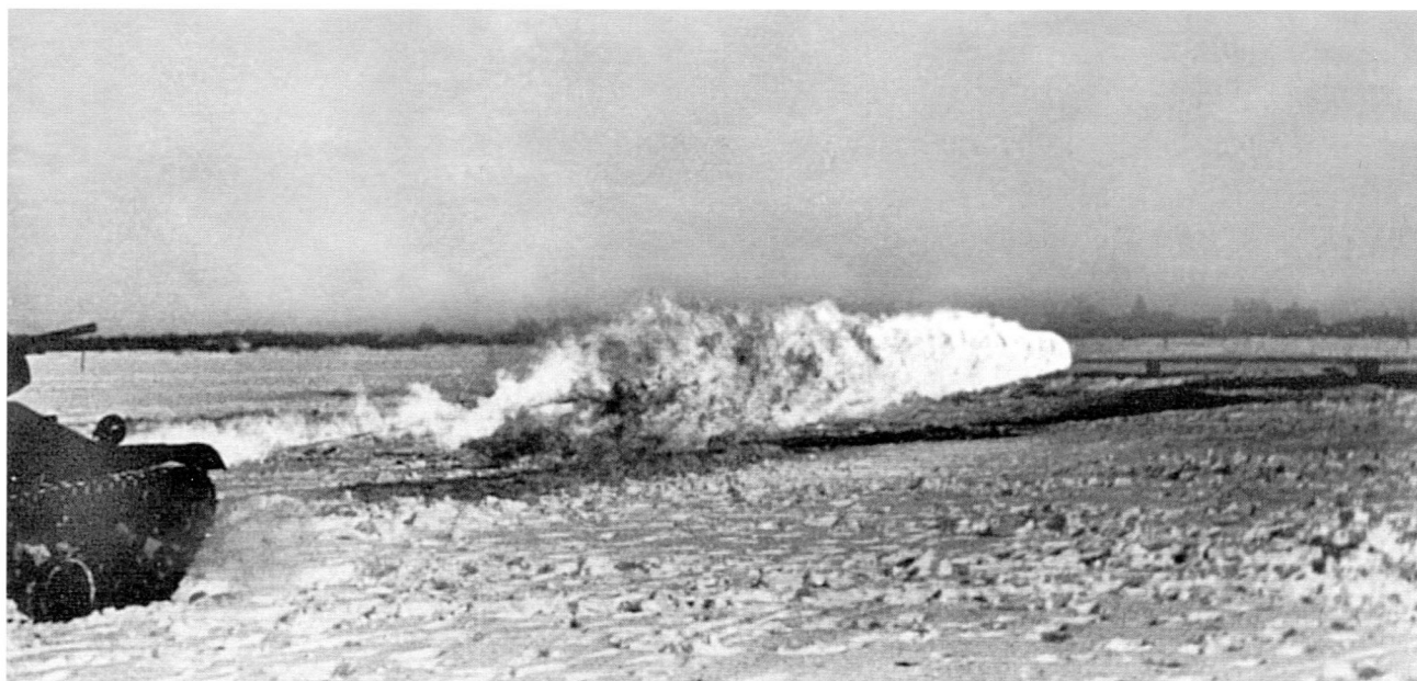
Испытания порохового огнемёта в танке Т-50 – стрельба с хода стандартной огнесмесью (ЦАМО).
