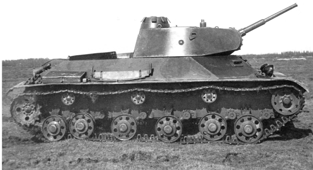
Опытный танк Т-50 во время испытаний на АНИОПе, вид справа. Апрель-май 1941 года. Пушка на максимальном угле возвышения (ЦАМО).
