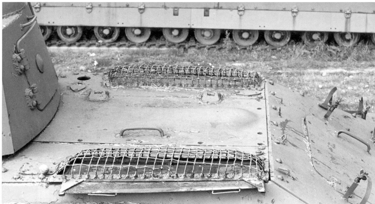
Крыша моторного отделения танка Т-50, находящегося в танковом музее в Пароле (Финляндия).
