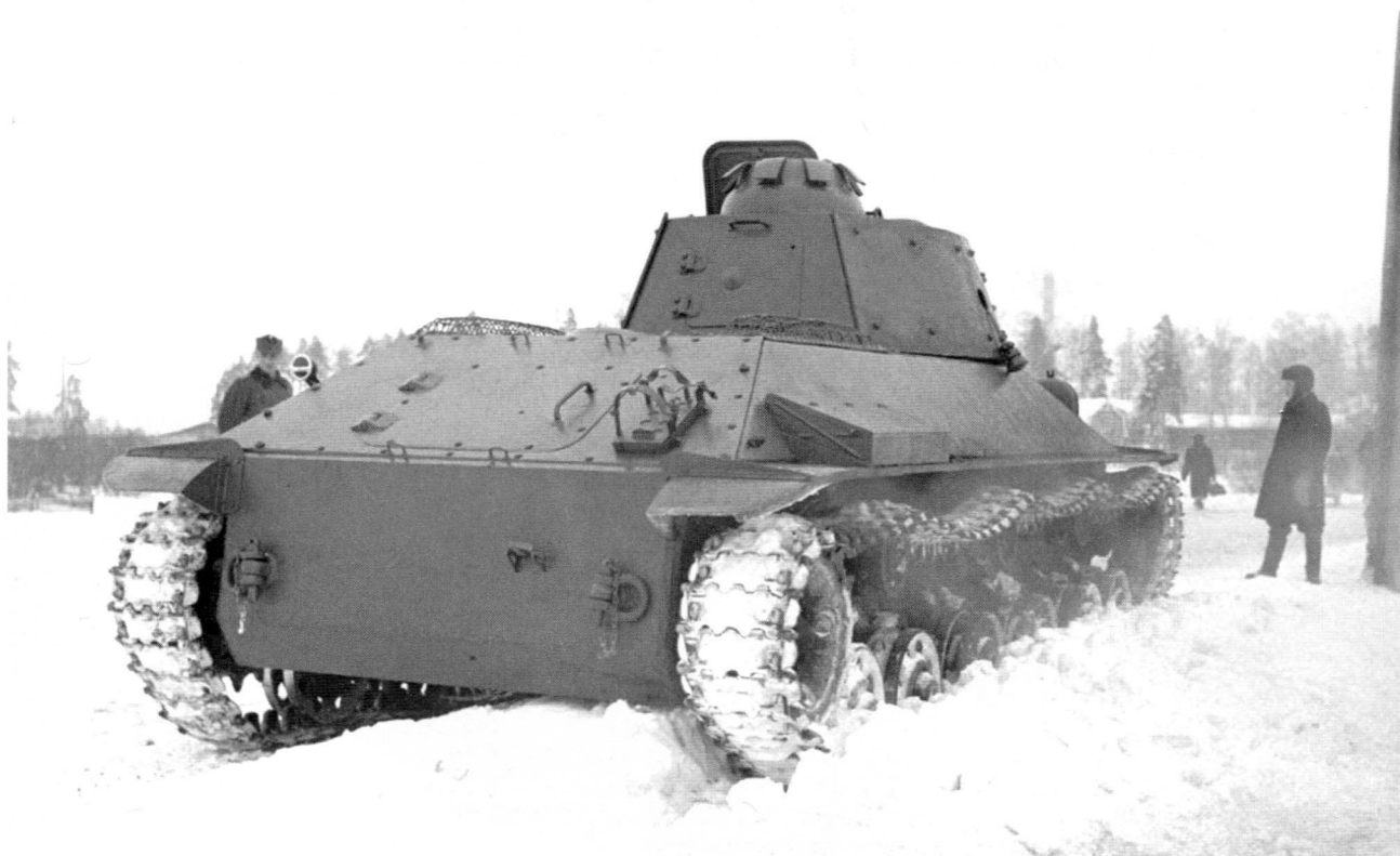
Испытания экранированного танка Т-50 в Варкаусе, вид сзади. Зима 1942 года. Хорошо видна укладка домкрата и ящик ЗИП на правой надгусеничной полке. (SA-Kuva).
