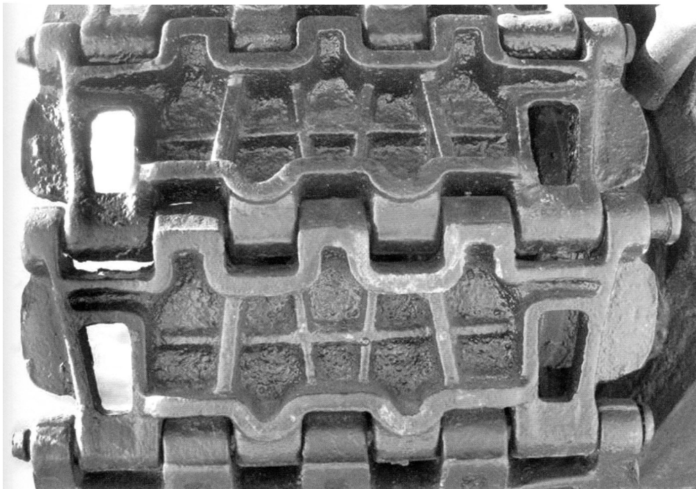
Трак гусеницы танка Т-50, второй (усиленный) вариант. Хорошо видна разница в деталях с трак, чертеж которого приведен ранее.
