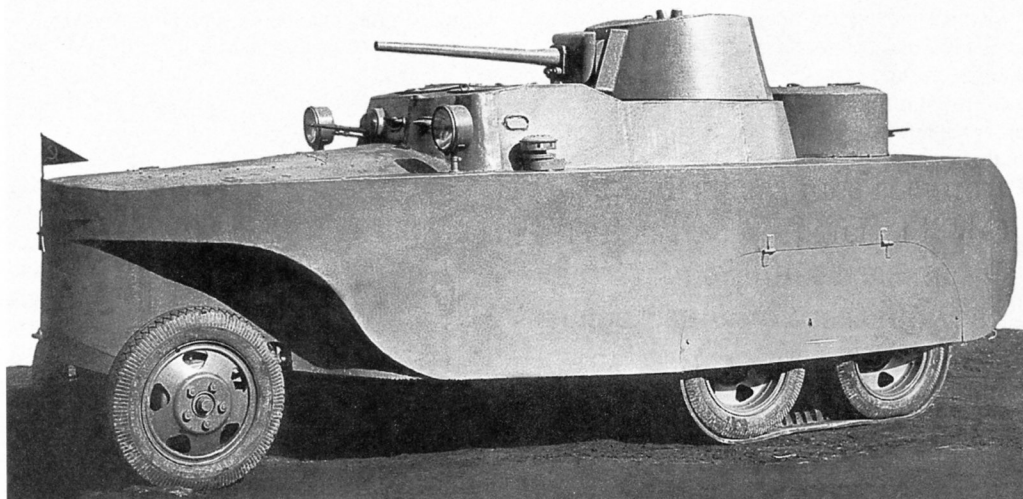
Бронеавтомобиль БАД-2 при движении по суше. Май 1933 года. На задние колеса одета резиновая лента для повышения проходимости (АСКМ).
