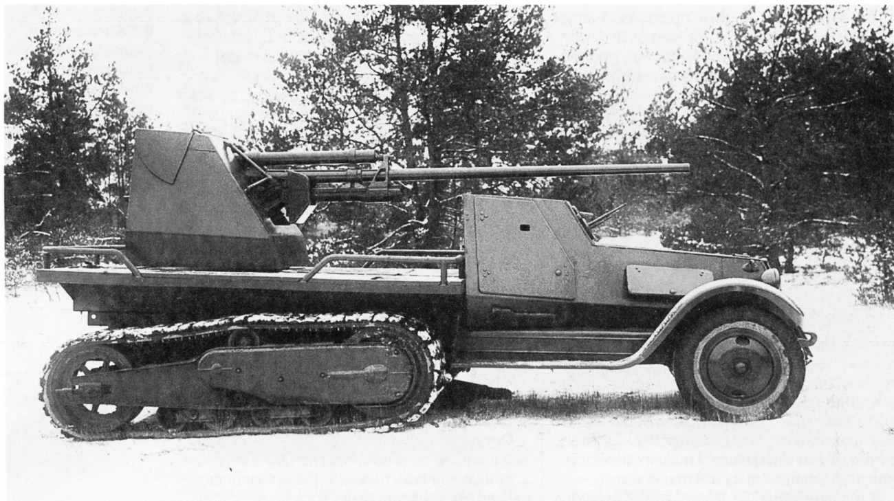
Самоходная установка ЗИС-41–57-мм противотанковая пушка ЗИС-2 на шасси грузовика ЗИС-22 – во время заводских испытаний. Горький, ноябрь 1941 года (Государственный архив Нижегородской области).
