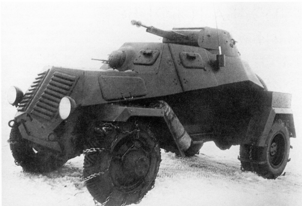
Бронеавтомобиль ЛБ-62 с задними двухскатными колесами (машина № 714). Январь 1941 года. На колеса одеты цепи противоскольжения (АСКМ).
