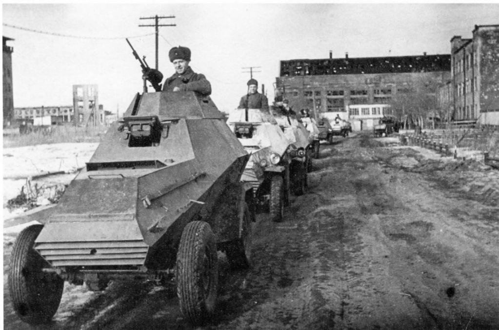
Колонна броневиков БА-64 после ремонта. Февраль 1943 года. На первой машине пулемет в положении для зенитной стрельбы (РГАКФД).
