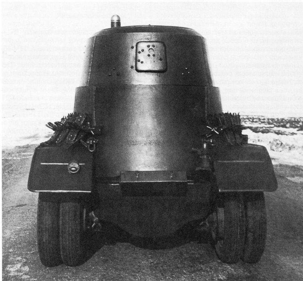
Броневая автомобиль БА-10А выпуска 1938 — первой половины 1939 годов, вид сзади. Виден ящик ЗИП на кормовом листе корпуса (АСКМ).
