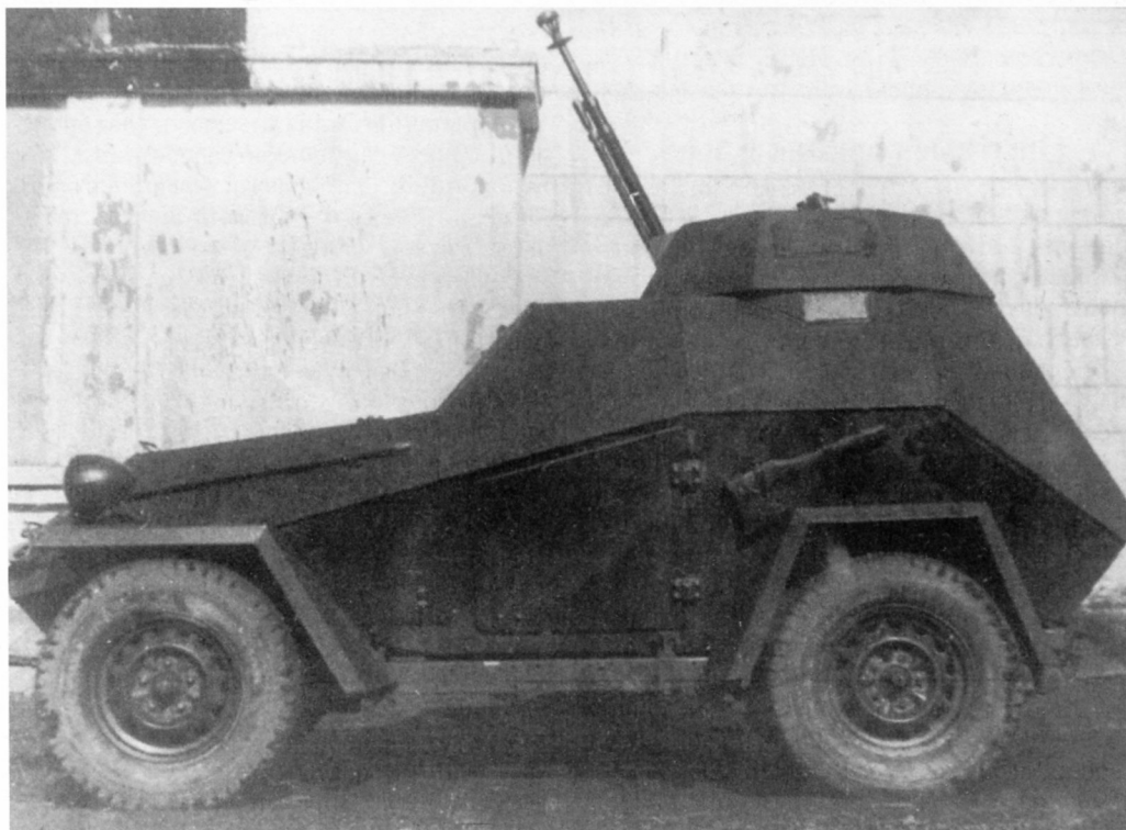
Броневая автомобиль БА-64Д, вид слева. Апрель 1943 года. Пулемет ДШК на максимальном угле возвышения (РГАЭ).
