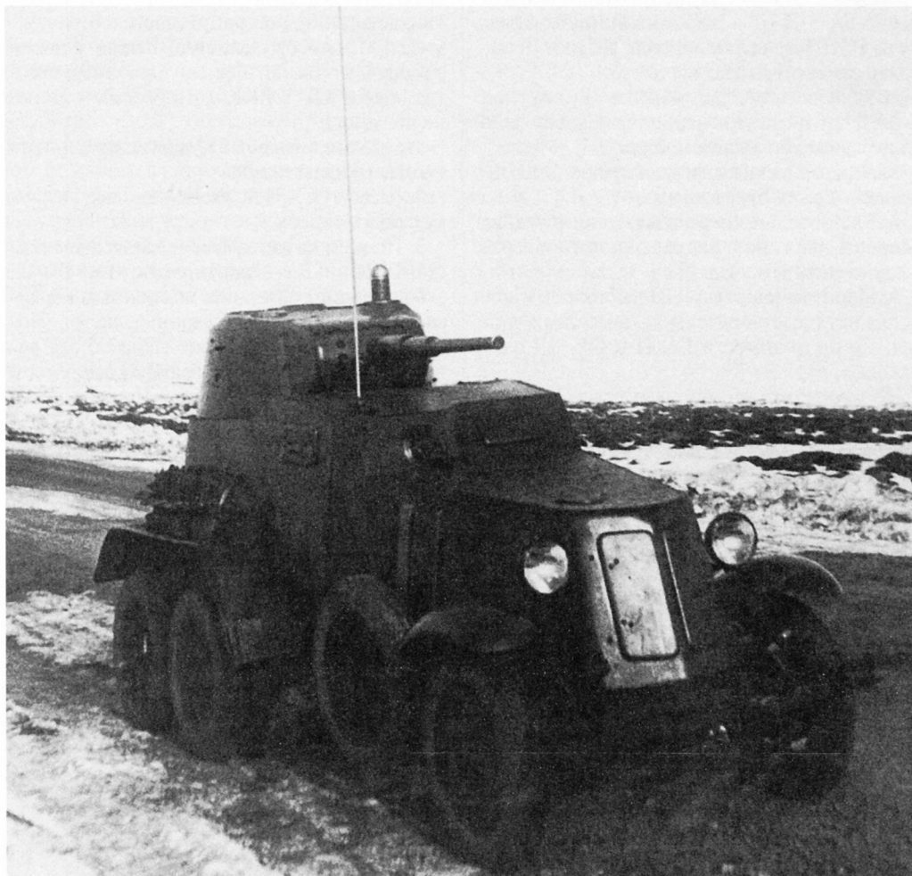
Общий вид бронеавтомобиля БА-10А с развернутой 4-метровой антенной (АСКМ).
