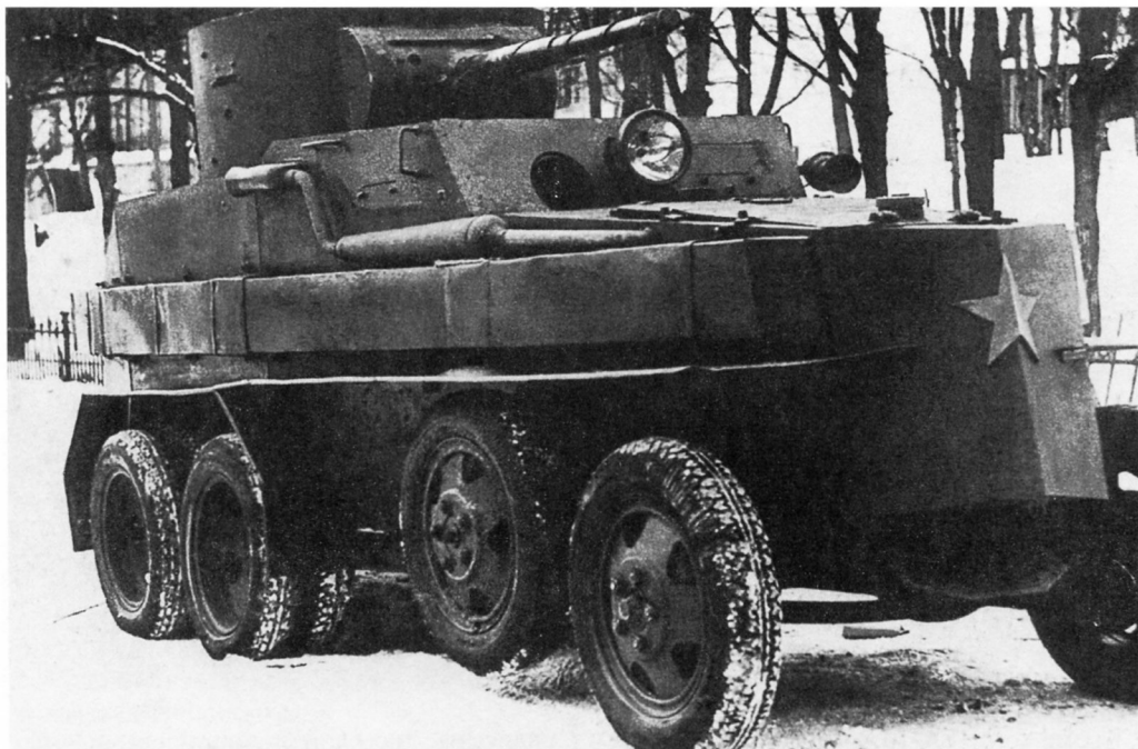
Один из трех первых бронеавтомобилей ПБ-4. Зима 1933 года. Деревянные поплавки установлены вдоль всего корпуса (музей Ижорского завода).
