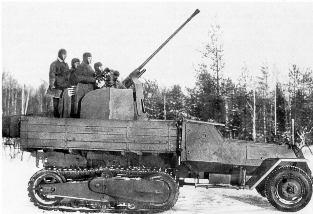
Самоходная установка ЗИС-43—37-мм зенитная пушка образца 1939 года в кузове грузовика ЗИС-42 с бронированной кабиной (АСКМ).
