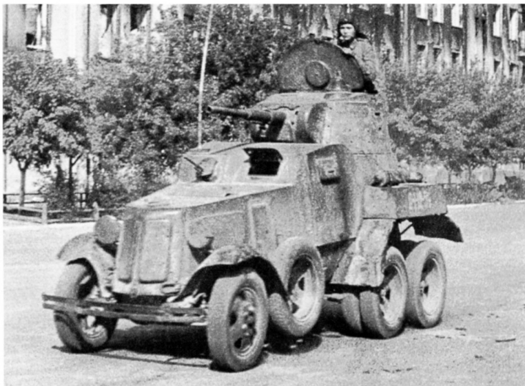
Бронеавтомобиль БА-10М. Хорошо видны наружные бензобаки и дополнительная бронезащита пулемета в лобовом листе корпуса (РГАКФД).
