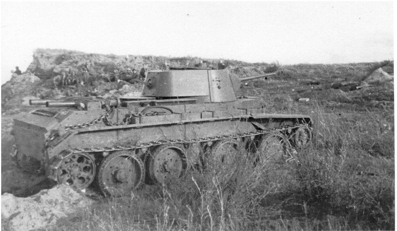
Танк БТ-7 на позиции. Август 1939 года. Предположительно, машина из состава 11-й танковой бригады. На надгусеничной полке закреплены дополнительные топливные баки, а также буксирная цепь, которая штатно должна была крепиться на корпусе спереди (АСКМ).
