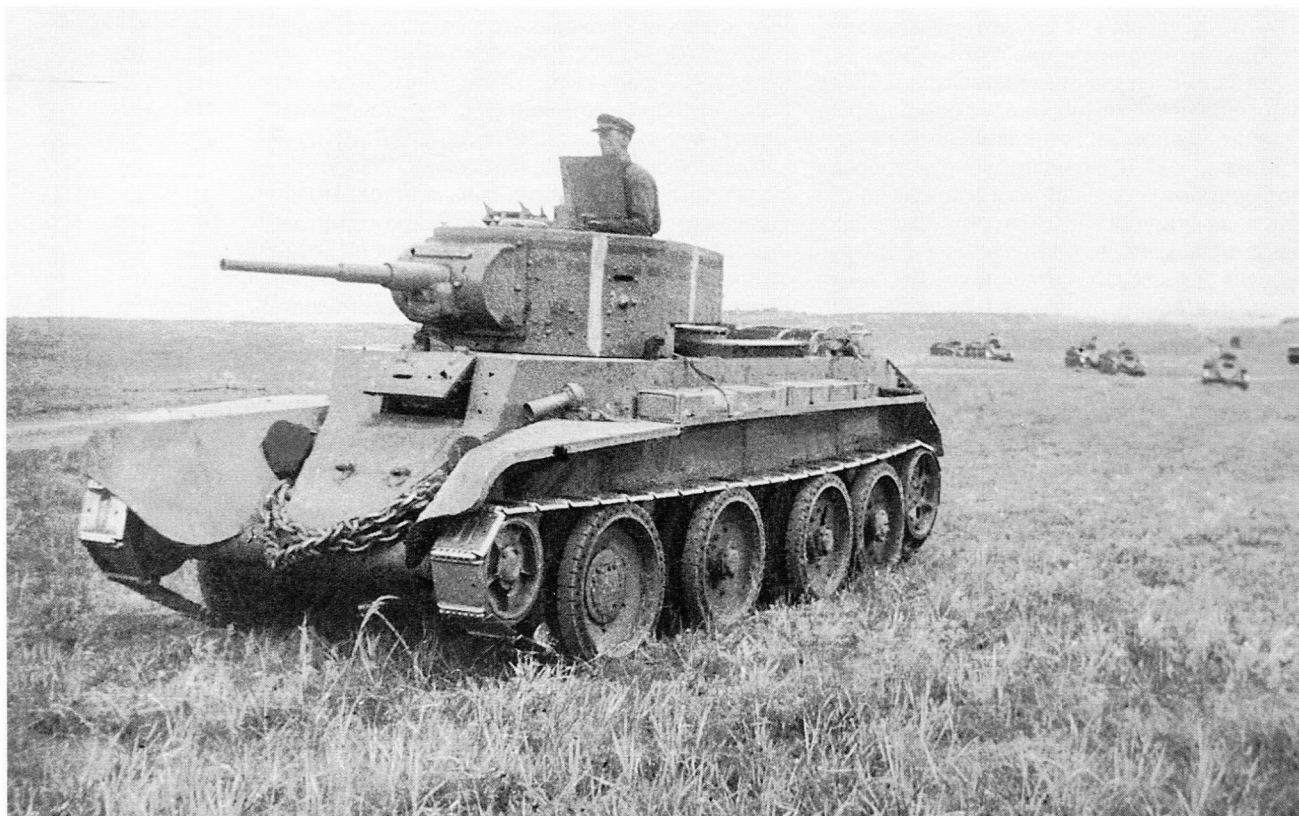
Танки БТ-7 6-й танковой бригады выходят на рубеж атаки. Две белых полосы, нанесенных поперек башни, служили для опознавания боевых машин своей авиацией. Август 1939 года (АСКМ).
