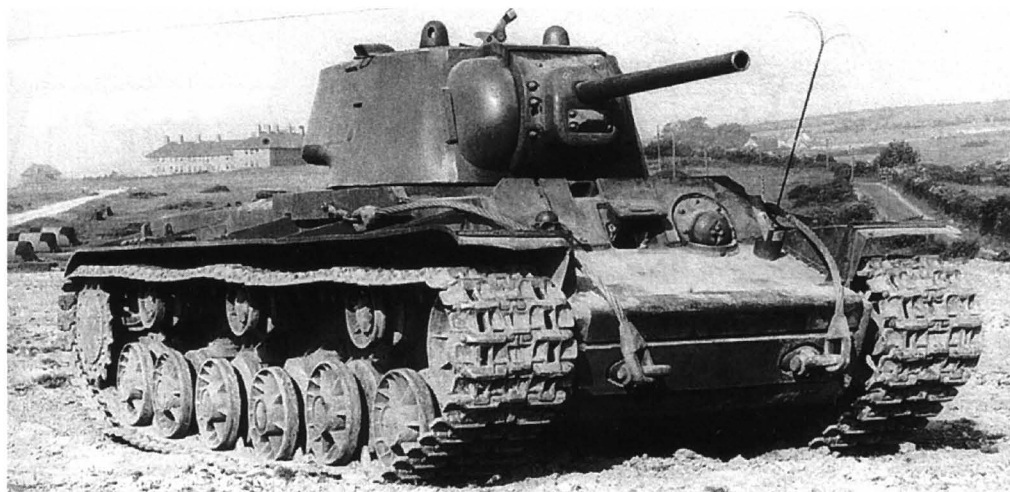
Танк КВ-1 с литой башней и корпусом изготовления завода № 200. Весна 1942 года.
