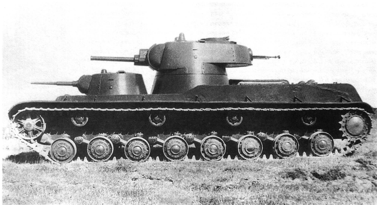
«Прародители» танка КВ — тяжелые двухбашенные танки SMK (вверху) и Т-100 (внизу).
