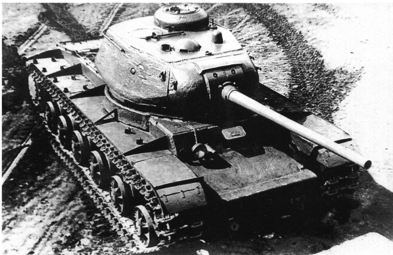
Общие виды первого экземпляра танка КВ-85. На нижнем фото хорошо видны крепления для установки дополнительных топливных баков на крыльях танка.
