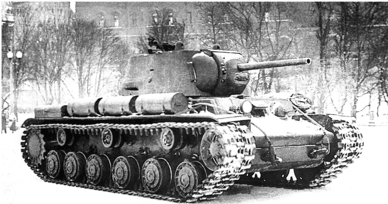
Танк КВ-1 с литой башней производства УЗТМ на улицах Москвы. Январь 1942 года. Машина оснащена катками с внутренней амортизацией.
