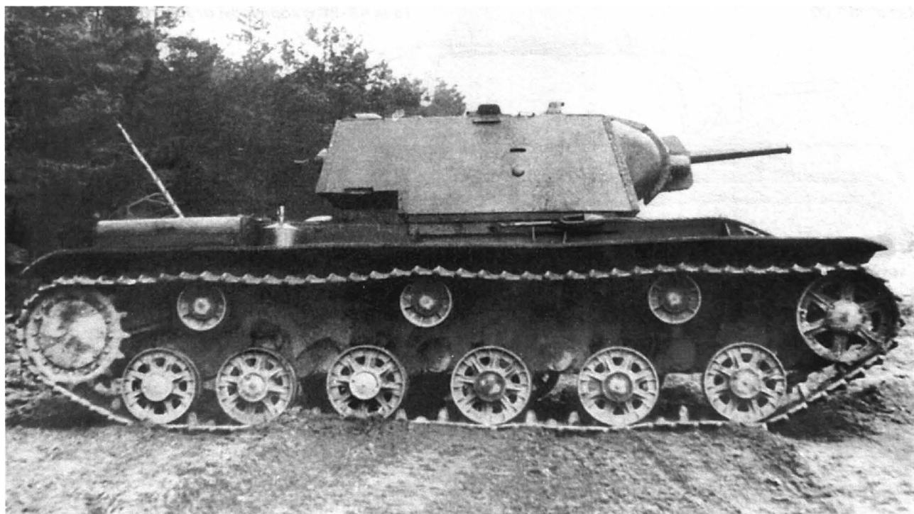
Танк КВ-8С (со сварной башней от танка КВ-8). Район Челябинска, лето 1942 года.
