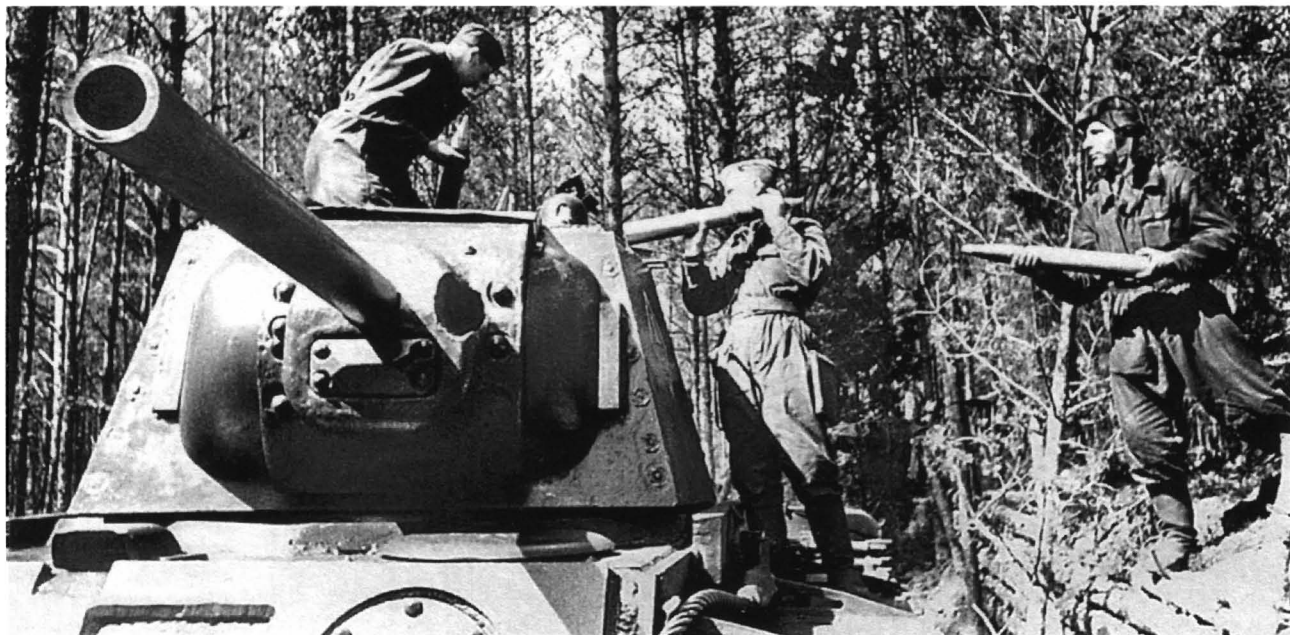
Загрузка снарядов в танк КВ-1 (со сварной башней). Западный фронт, 33-я танковая бригада, лето 1942 года.
