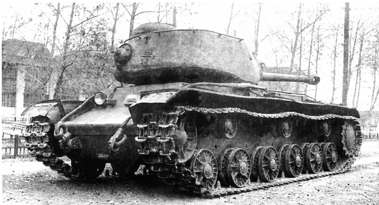
Танк KV-1С с установленной на нем башней от танка ИС-122. Челябинский Кировский завод, осень 1942 года.
