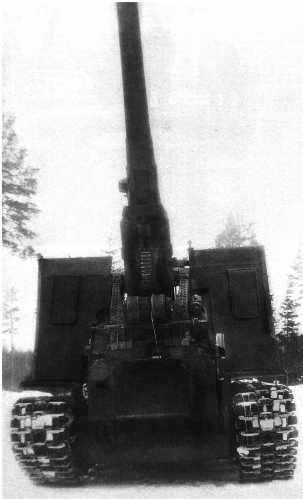
Самоходная установка С-51 (203-мм гаубица Б-4 на шасси танка КВ-1С) во время испытаний на Гороховецком артиллерийском полигоне, март 1943 года. Орудие находится на максимальном угле возвышения.
