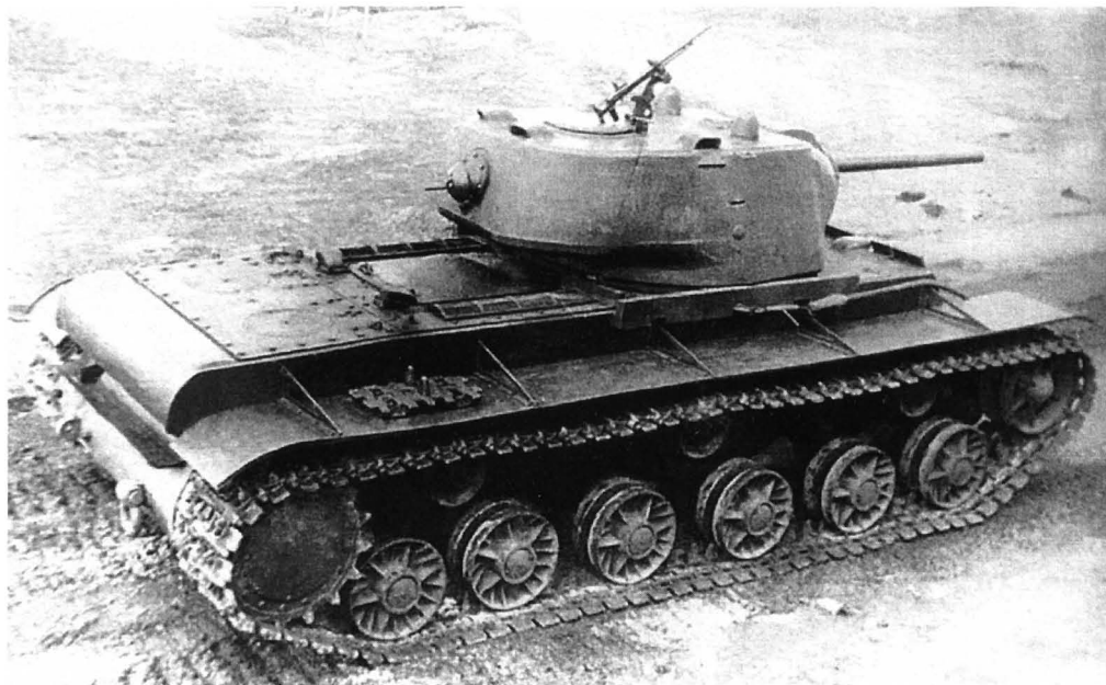
Танк КВ-1 с литой башней и корпусом изготовления завода № 200. Весна 1942 года.
