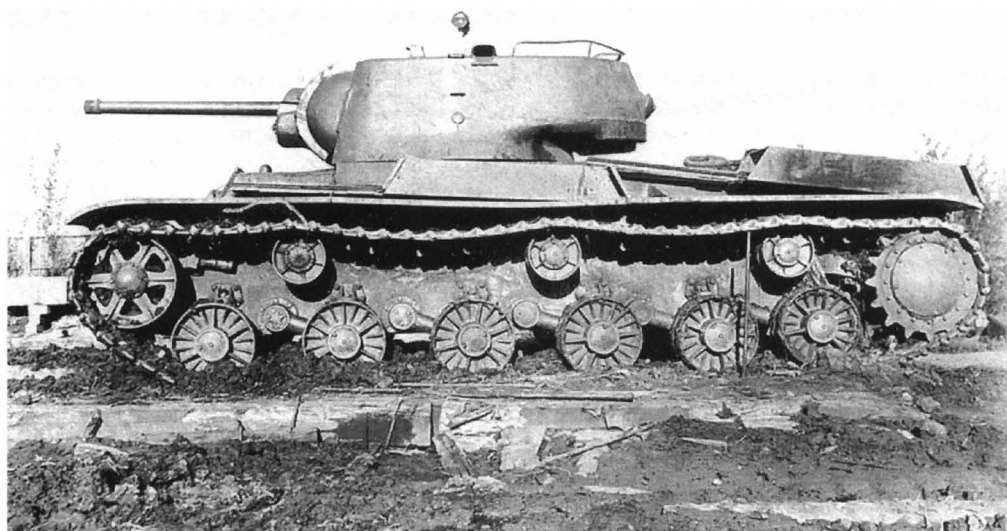
Танк КВ-1 с установками КРАСТ-1 (короткая артиллерийская ракетная система танковая). Челябинск, завод № 100, лето 1942 года (слева и внизу).
