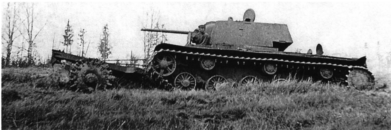
Танк KB-1 с катковым минным тралом из состава 260-го танкового полка. Ленинградский фронт, Карельский перешеек, лето 1944 года.
