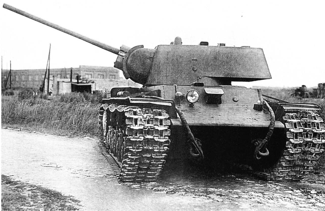
Танк КВ с установленной в нем экспериментальной 76-мм пушкой Ф-27. Горький, весна 1941 года.
