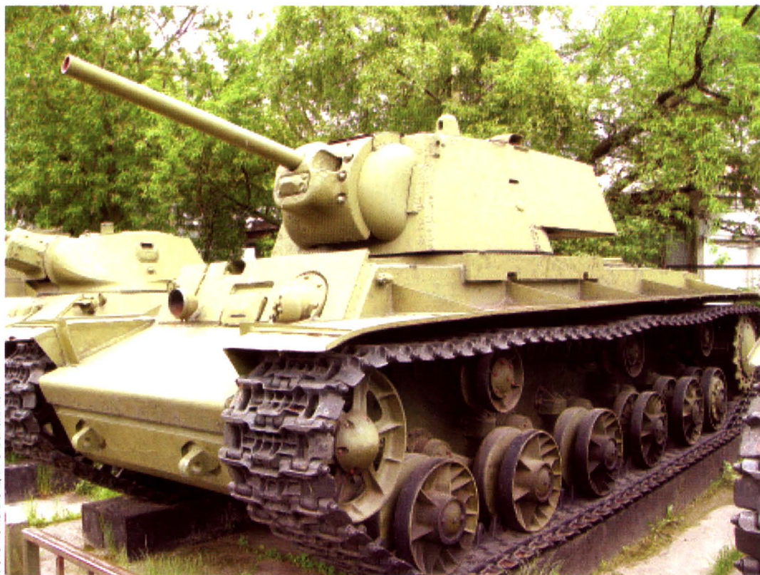
Танк КВ-1 со сварной башней, изготовленный Челябинским заводом весной 1942 года. Машина находится в экспозиции Центрального музея Вооруженных Сил в Москве.
