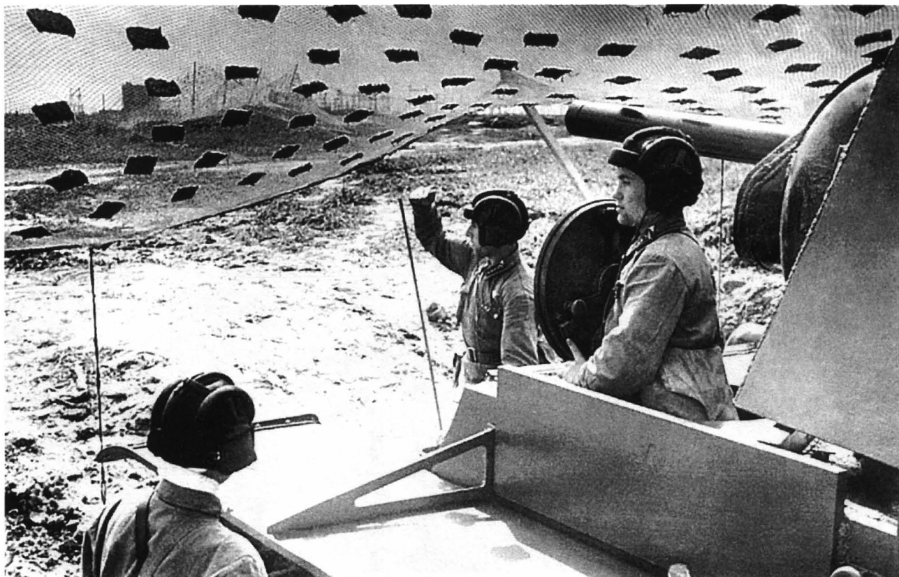
Экипаж танка КВ на боевой позиции. Ленинградский фронт, лето 1942 года. Хорошо видны дополнительные бронелисты для защиты погона башни.
