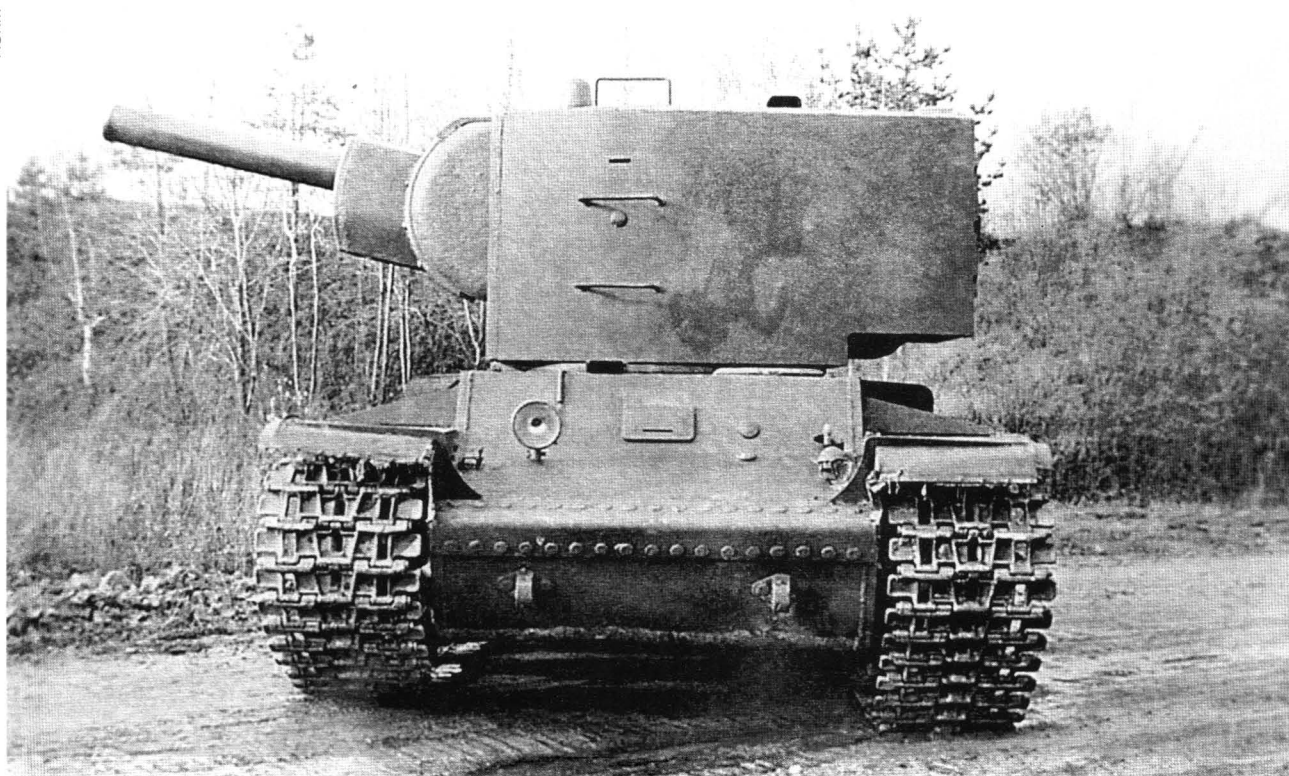
Танк У-7 с установленным на нем первым образцом «пониженной» башни для 152-мм гаубицы перед прохождением испытаний. Сентябрь 1940 года.
