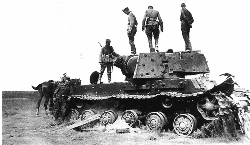
Немецкие солдаты осматривают подбитый танк КВ-1. Район Красногвардейска, 1941 год. Танк попал под сильный артиллерийский огонь — он имеет следы многочисленных снарядных попаданий, орудие сорвано с противоткатных устройств.
