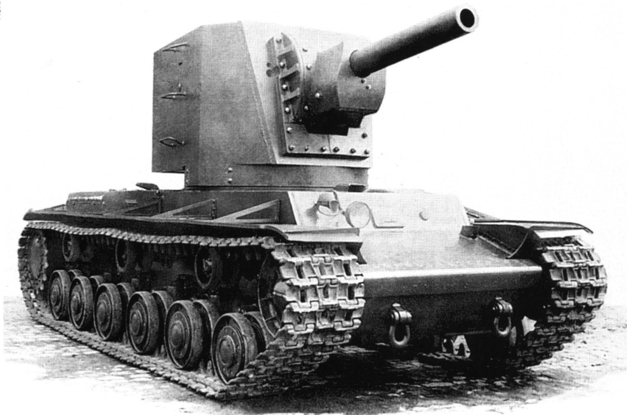
Общий вид танка КВ У-4, крылья «авиационного» типа уже демонтированы. Кировский завод, весна 1940 года.
