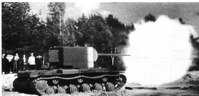
Испытания 107-мм орудия ЗИС-6 (для танка КВ-3) в башне танка КВ-2. Горький, май 1941 года.
