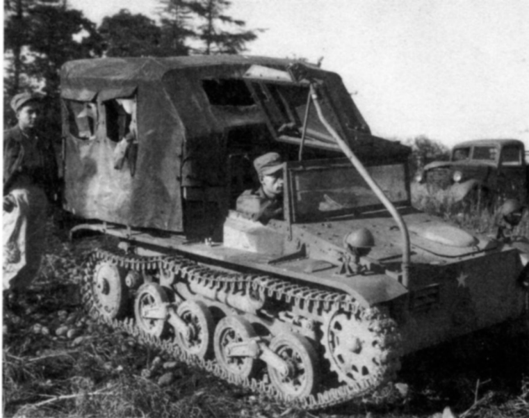
Трофейный транспортер-укладчик кабеля Тип 97 испытывается союзниками. Машина — в походном положении
