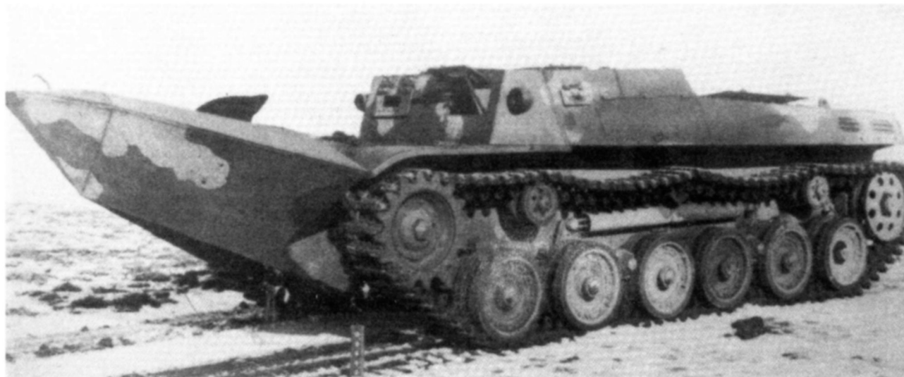
Бронированная инженерная машина разграждения «Хо-К» с приспособлением-«тараном» для проделывания проходов в зарослях
