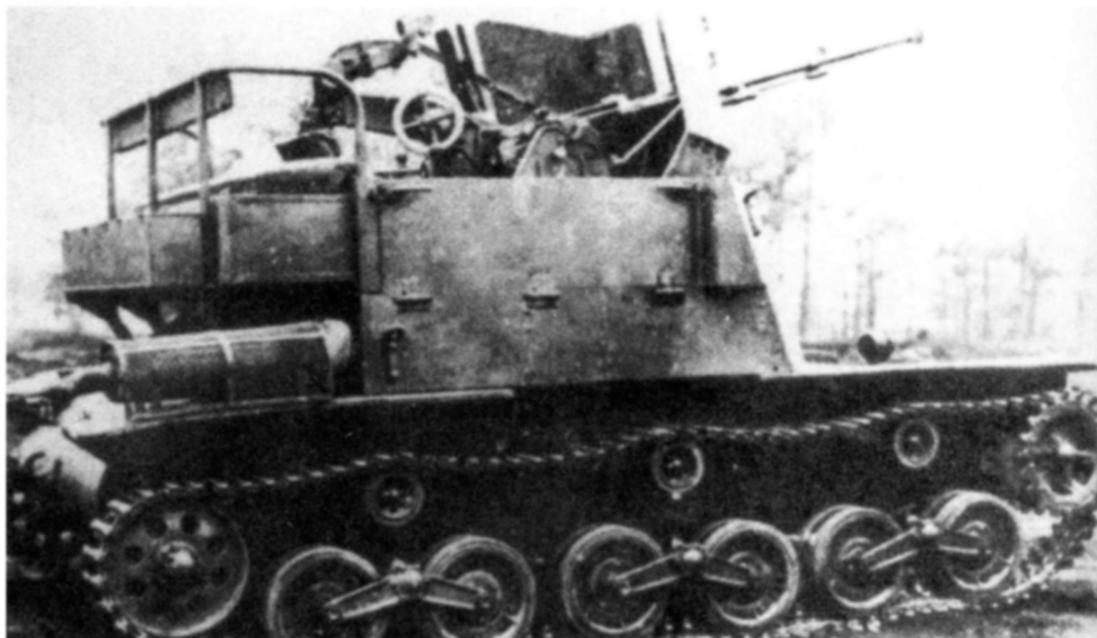
Спаренная 20-мм зенитная самоходная установка на шасси танка «Ке-ни» (автоматическая пушка Тип 2)
