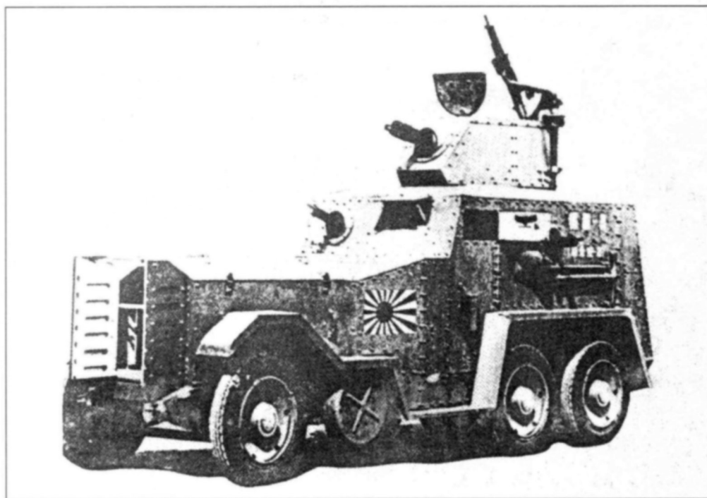
«Бронеавтомобиль морских десантных отрядов» Тип 2592 с зенитной установкой пулемета на башне и дополнительными барабанами для улучшения проходимости
