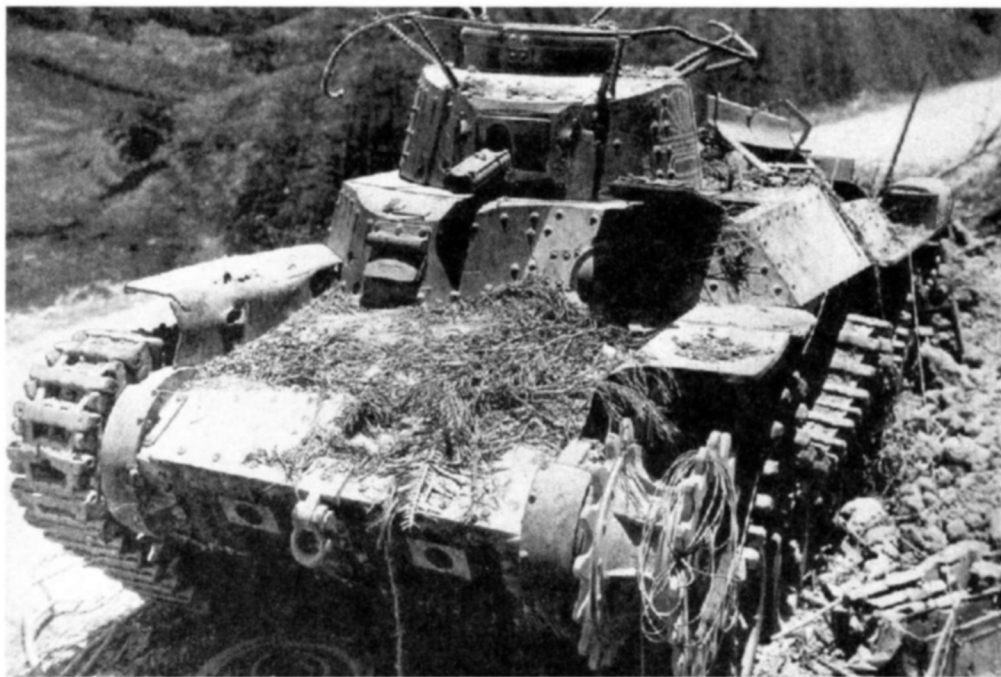
Подбитый командирский танк «Чи-ха» 9-го танкового полка со снятым вооружением. Кроме повреждения ходовой части видны две пробоины от 37-мм снарядов в башне. о. Сайпан, июнь 1944 г.
