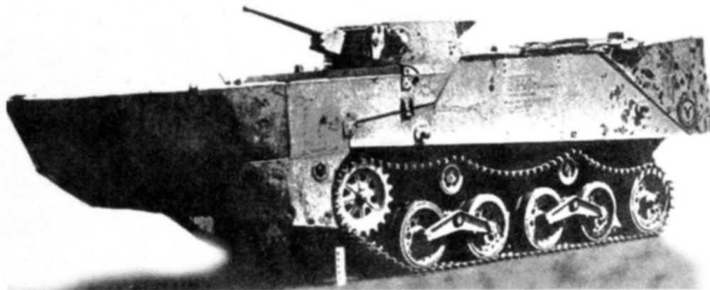
Плавающий танк Тип 2 «Ка-ми» с установленными пontoнами
