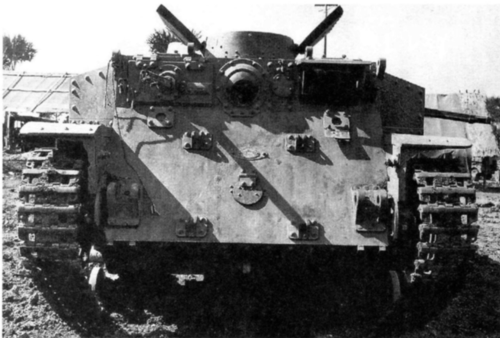
Инженерная бронированная машина SS «Тей Гата», оснащенная огнеметами и пулеметом. Обратим внимание на узлы крепления специальных приспособлений на лобовом листе корпуса, отсутствие передней двери (в отличие от машины «Бо Гата»), командирскую башенку
