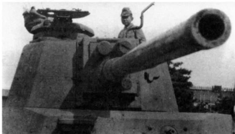
Башня танка Тип 4 «Чи-то» с установкой 75-мм пушки Тип 4
