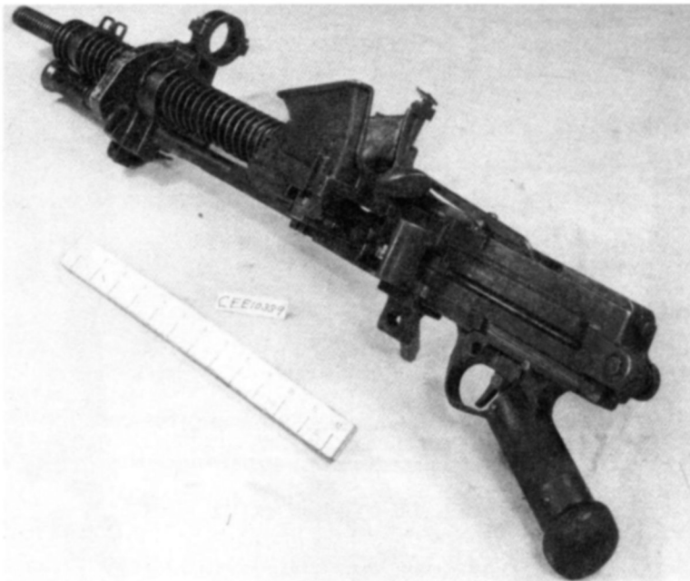
6,5-мм танковый пулемет Тип 91
