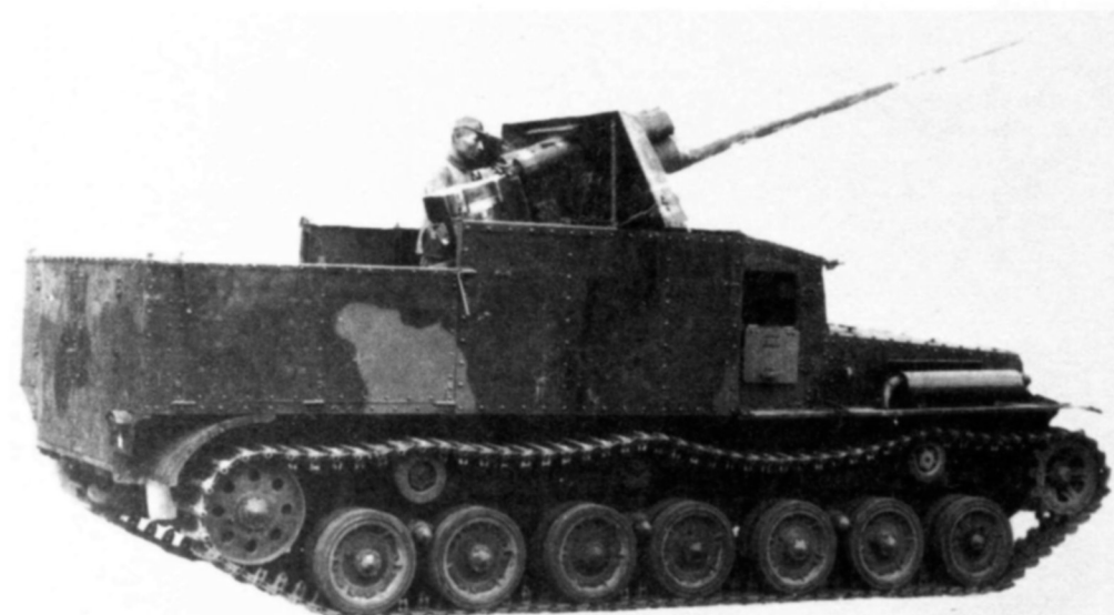
Опытная самоходная 75-мм противотанковая пушка «На-то»
