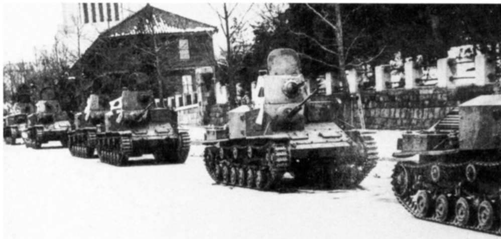
Легкие танки Тип 92, вооруженные 13-мм и 6,5-мм пулеметами, проходят парадным строем
