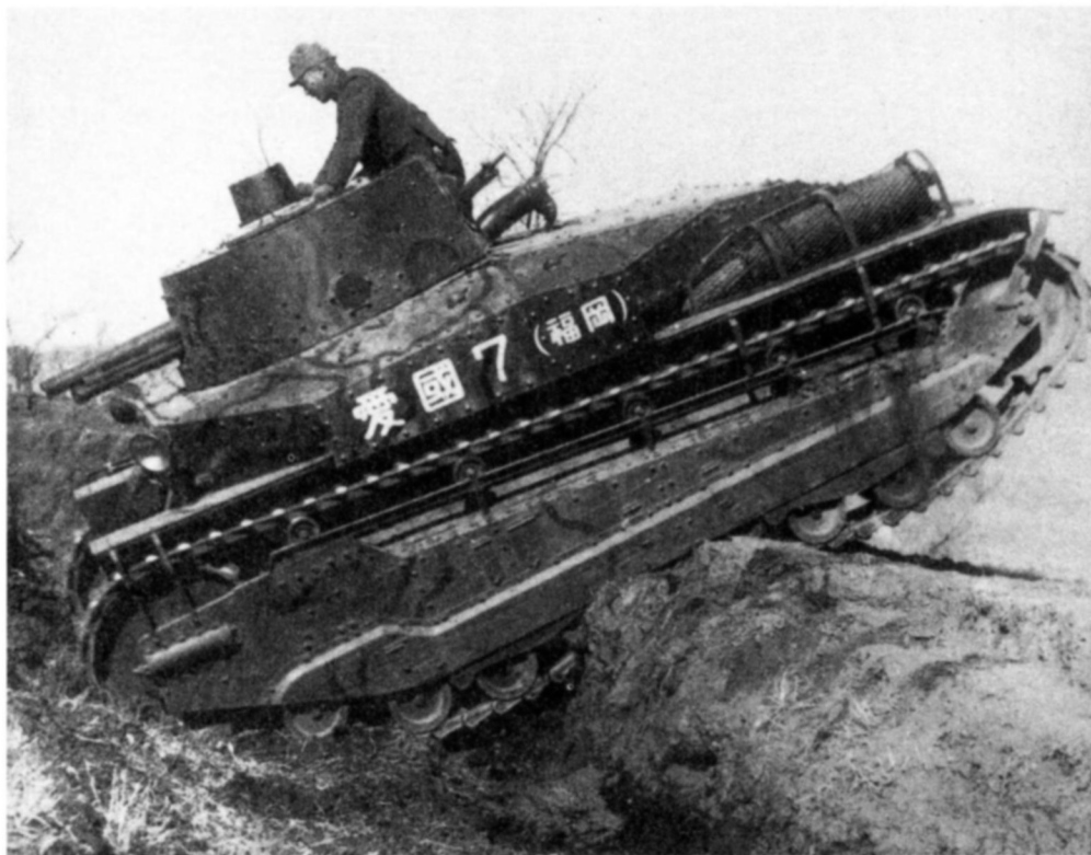
Средний танк Тип 89 на испытаниях преодолевают контрэскарп
