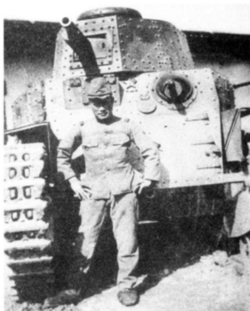
Член экипажа позирует перед средним танком Тип 94. Обратите внимание на поворот оружейной установки относительно башни
