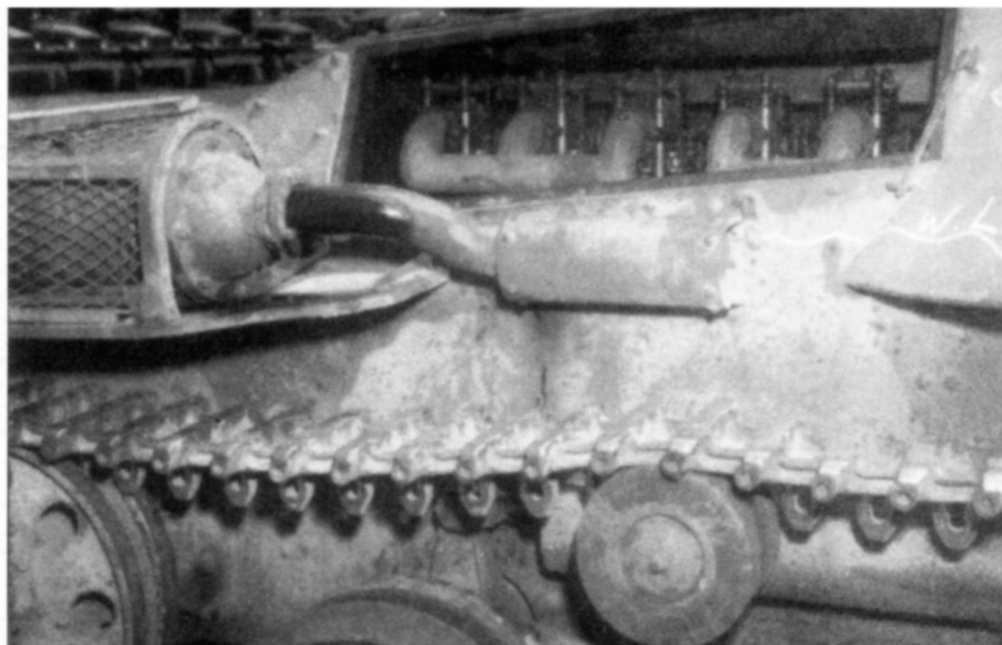
Рядный дизельный двигатель «Мицубиси» А (N) 6120 VD
