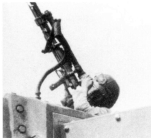
Работа с вертлюжной зенитной установкой пулемета Тип 97 на башне танка «Шинхото Чи-ха»
