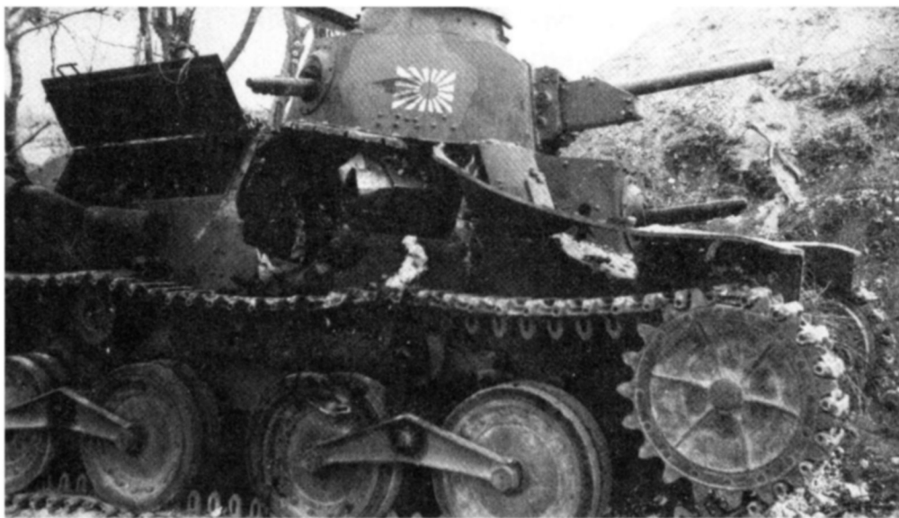
Танк Тип 95 «Ха-го» морского десантного отряда после попадания 75-мм фугасного снаряда. о.Сайпан, июнь 1944 г.
