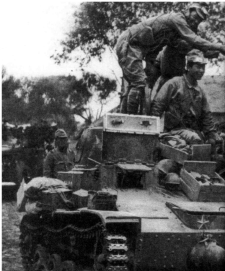
Малый танк Тип 94 ТК, нагруженный имуществом и стрелковыми боеприпасами. Люки рубки открыты для лучшей вентиляции
