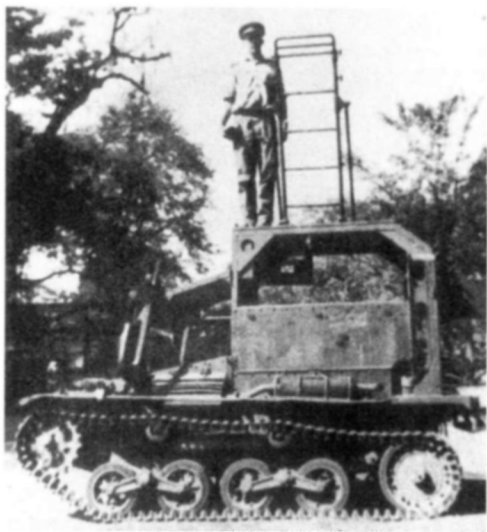
Транспортер-укладчик кабеля в рабочем положении для организации шестовых кабельных линий
