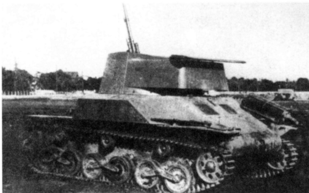
Одиная 20-мм зенитная самоходная установка на шасси танка «Ке-ни» (автоматическая пушка Тип 98)
