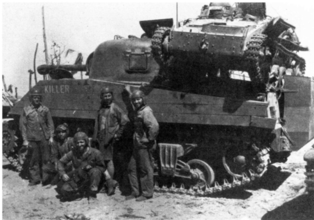
«Справились». Американские танкисты водрузили японский малый танк Тип 94 ТК на корму своего среднего М4А2 «Шерман». Остров Намур или Кваджелейн, март 1944 г. Заметим, что борта американского танка прикрыты брусками для защиты от магнитных мин и гранат
