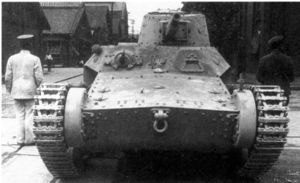
Опытный средний танк «Чи-ни», вид спереди. Видно стремление повысить защищенность, прежде всего, за счет больших углов установки бронелистов
