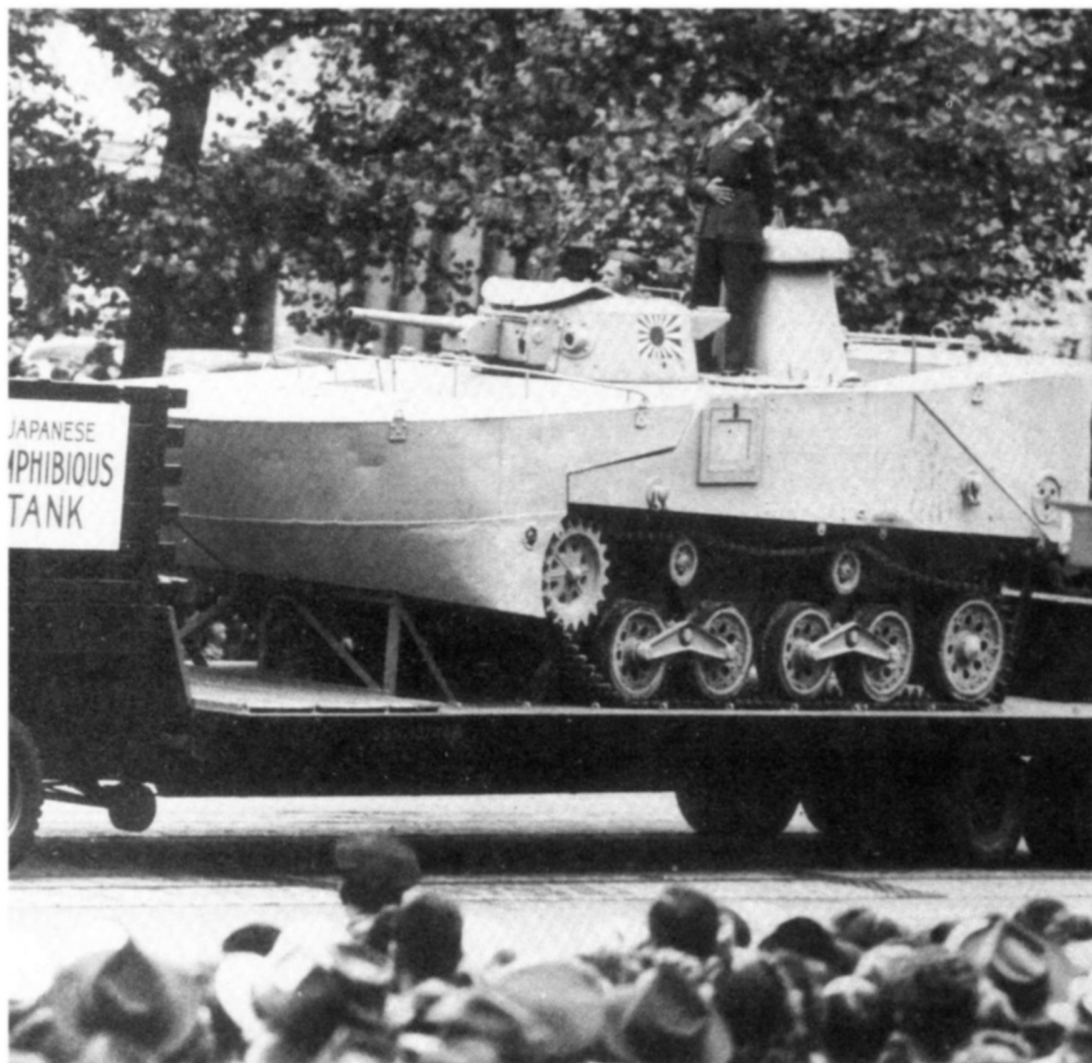
Плавающий танк «Тип 2» («Ка-ми») с установленными понтонами и воздухозаборным коробом — трофей американской армии — демонстрируется на параде в честь победы над Японией
