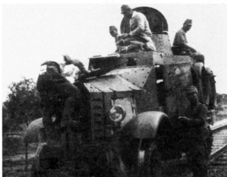
Бронеавтомобиль-дрезина Тип 2593 «Сумида» по своей вместимости был, по сути, легким бронетранспортером
