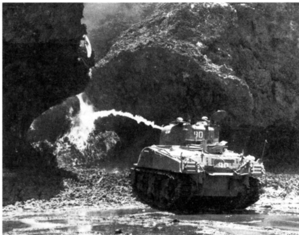
На Окинаве американцы для борьбы с японскими укреплениями широко применяли огнеметы и огнеметные танки вроде этого М4 с огнеметом Е7-7 из состава 713-го огнеметно-танкового батальона, апрель 1945 г.
