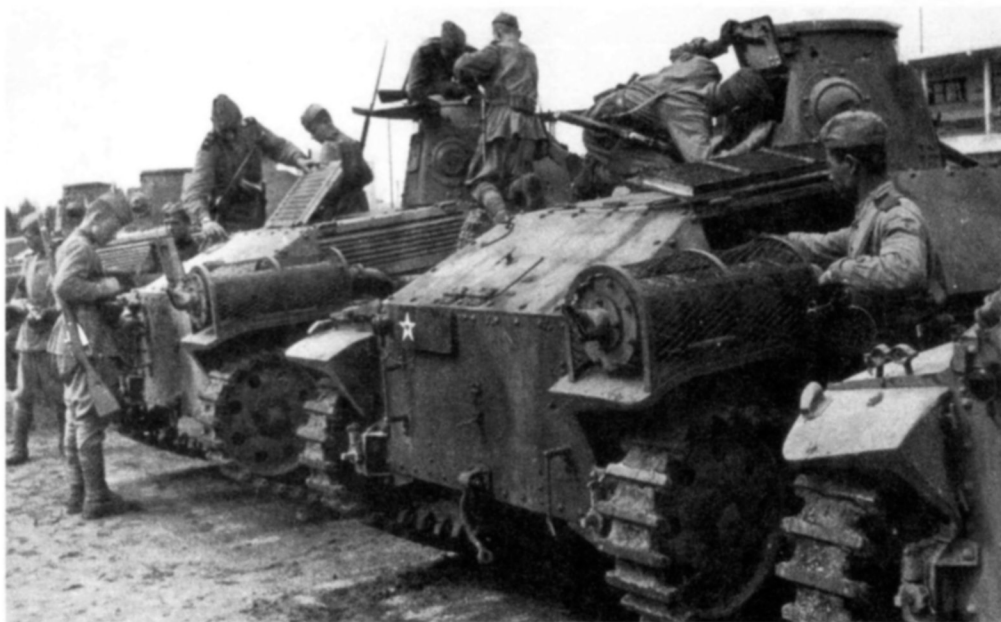
Советские солдаты осматривают трофейные танки Тип 95 «Ха-го». Обратим внимание на штатное обозначение танков, крепление крышек лючков и ЗИП
