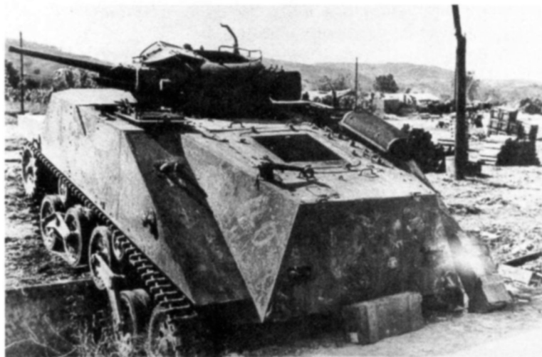
Плавающий танк Тип 2 «Ка-ми» со сброшенными понтонными после ночного боя на пляже Гарапан 16 июня 1944 г., о. Сайпан
