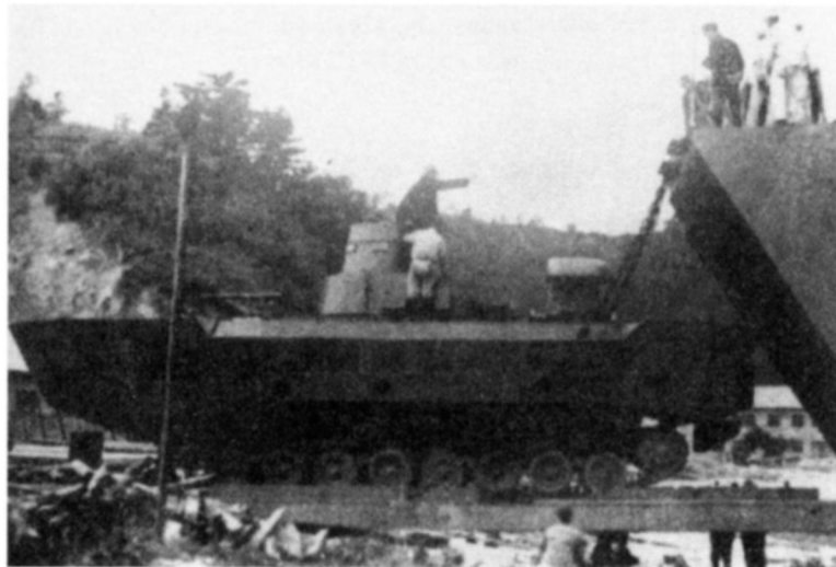
Выгрузка плавающего танка Тип 3 «Ка-чи» (с установленными понтонами, воздухозаборным коробом, защитным кожухом)
