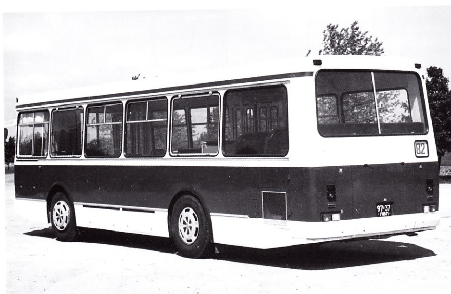
⚡ Корма автобусов ЛАЗ-4202 серьезно отличалась от более поздних ЛАЗ-42021
