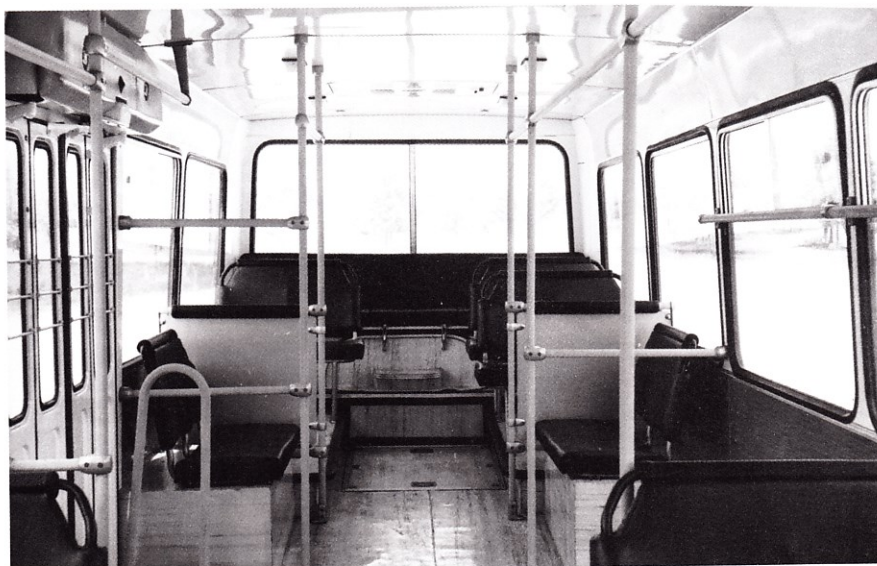
➤ Планировка салона ЛАЗ-4202 смешанная — сиденья стоят вперемешку одноместные и двухместные, поперек автобуса и вдоль бортов
