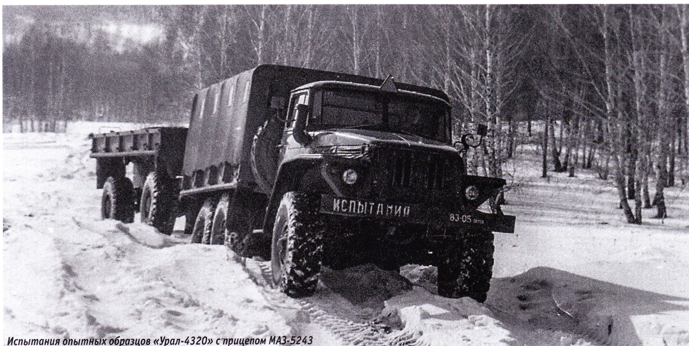
Испытания опытных образцов «Урал-4320» с прицепом МАЗ-5243
