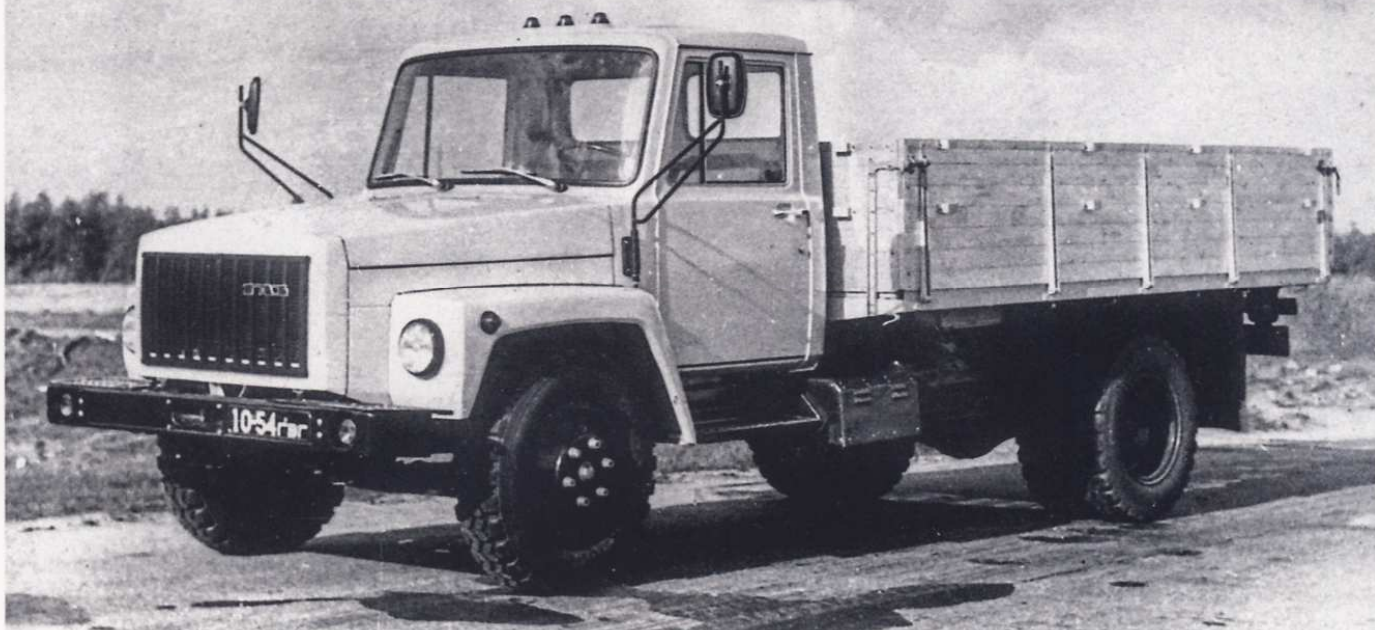
Опытный образец грузовика ГАЗ-4301 с дизельным двигателем с воздушным охлаждением
