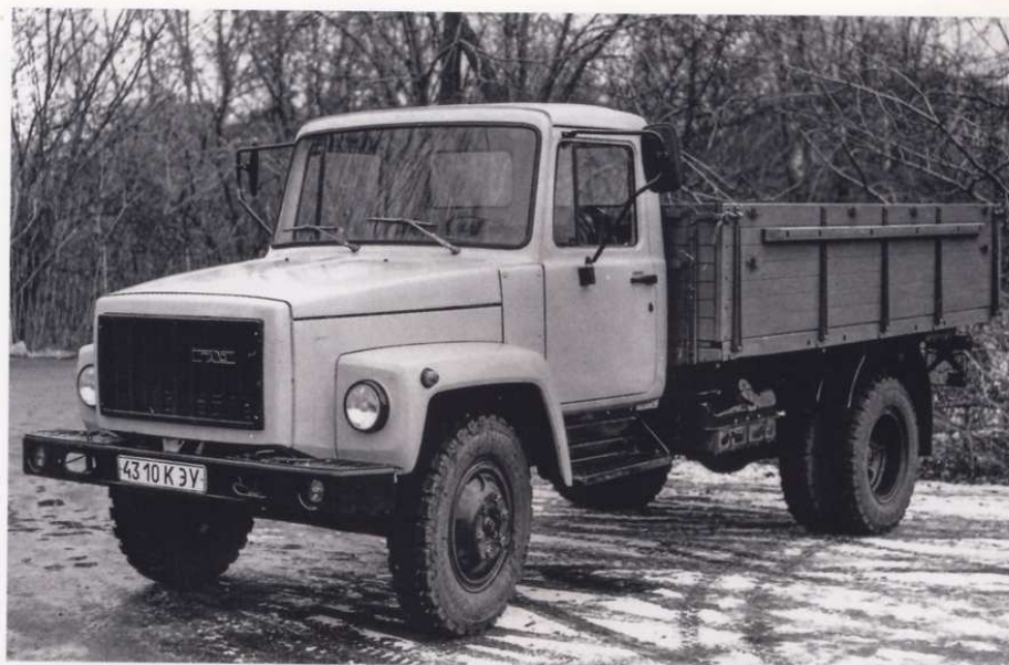
Бортовой грузовик ГАЗ-3307 с бензиновым мотором V-8
