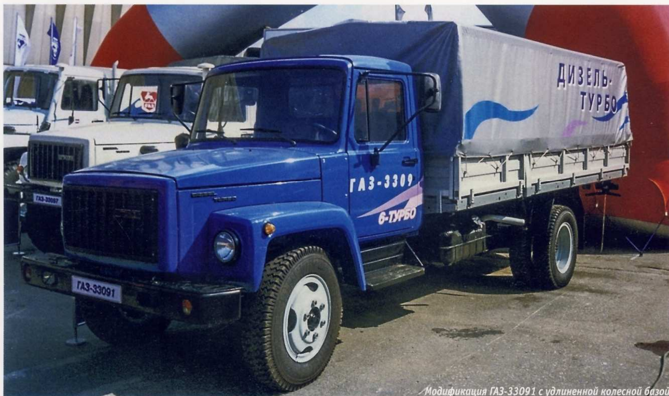
Модификация ГАЗ-33091 с удлиненной колесной базой
