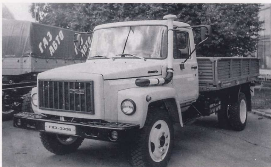
Опытный образец ГАЗ-3306 с «воздушным» дизелем меньшей мощности
