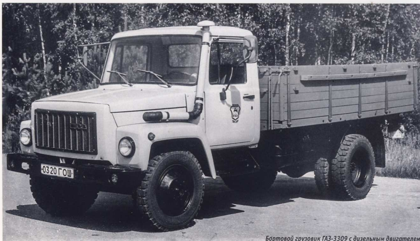
Бортовой грузовик ГАЗ-3309 с дизельным двигателем
