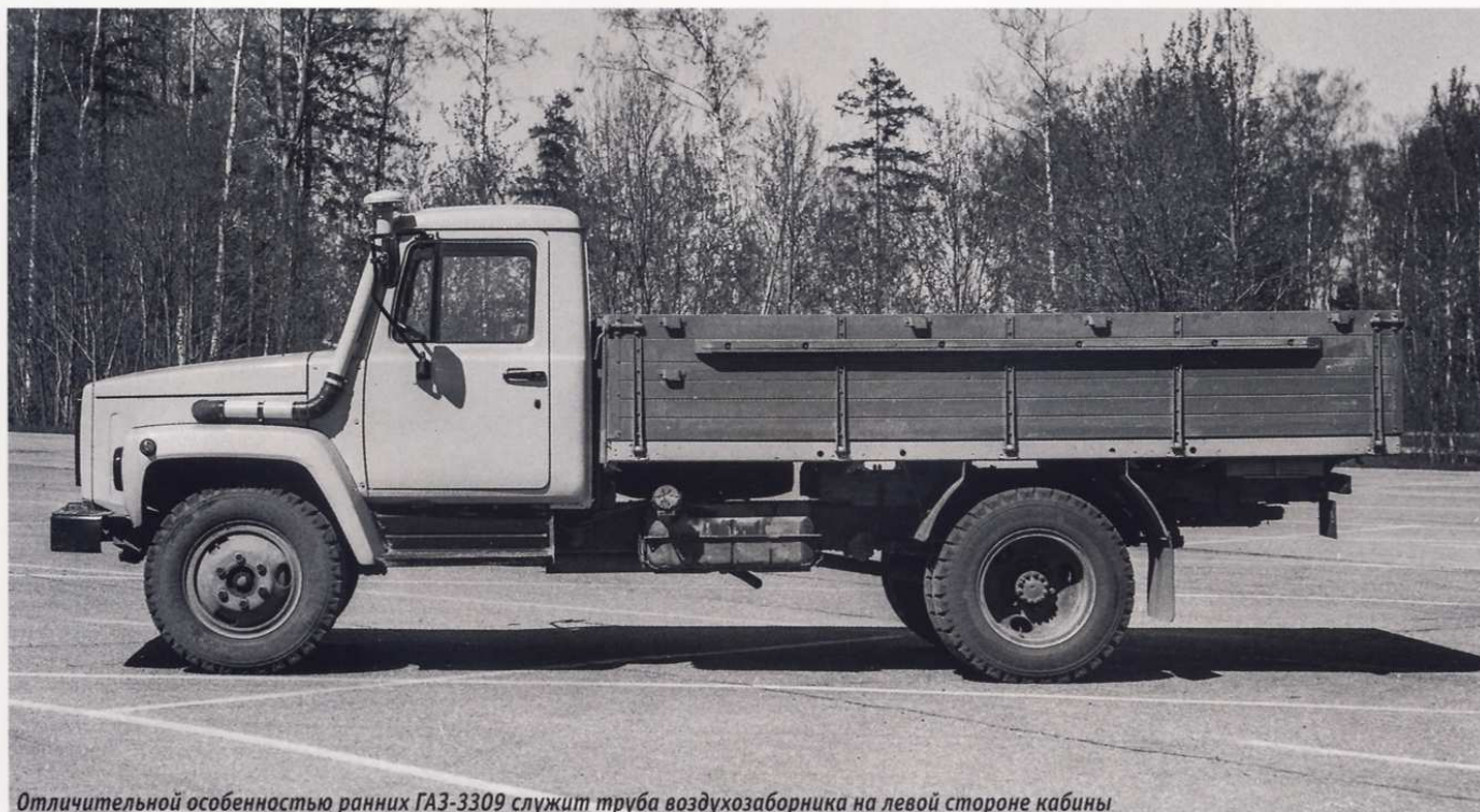
Отличительной особенностью ранних ГАЗ-3309 служит труба воздухозаборника на левой стороне кабины
