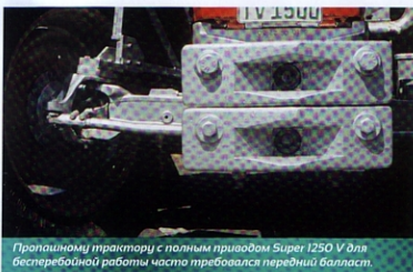
Концерн Die Zahnradfabrik Friedrichshafen (ZF) («Цанрадфабрик Фридрихсхафен») оснащал осями и трансмиссиями такие модели фирмы «Шлютер», как Super 950, Super 1250 и Super 1250 V.
