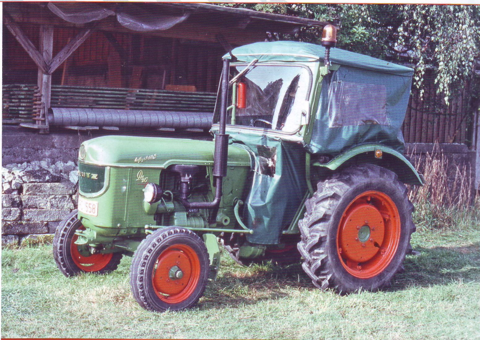
Трактор Deutz D 40 F 3 L 712, выпущенный в 1963 году. Благодаря смене трансмиссии машина сбросила вес, на что указывает дополнительная литера L, означающая «легкий».
