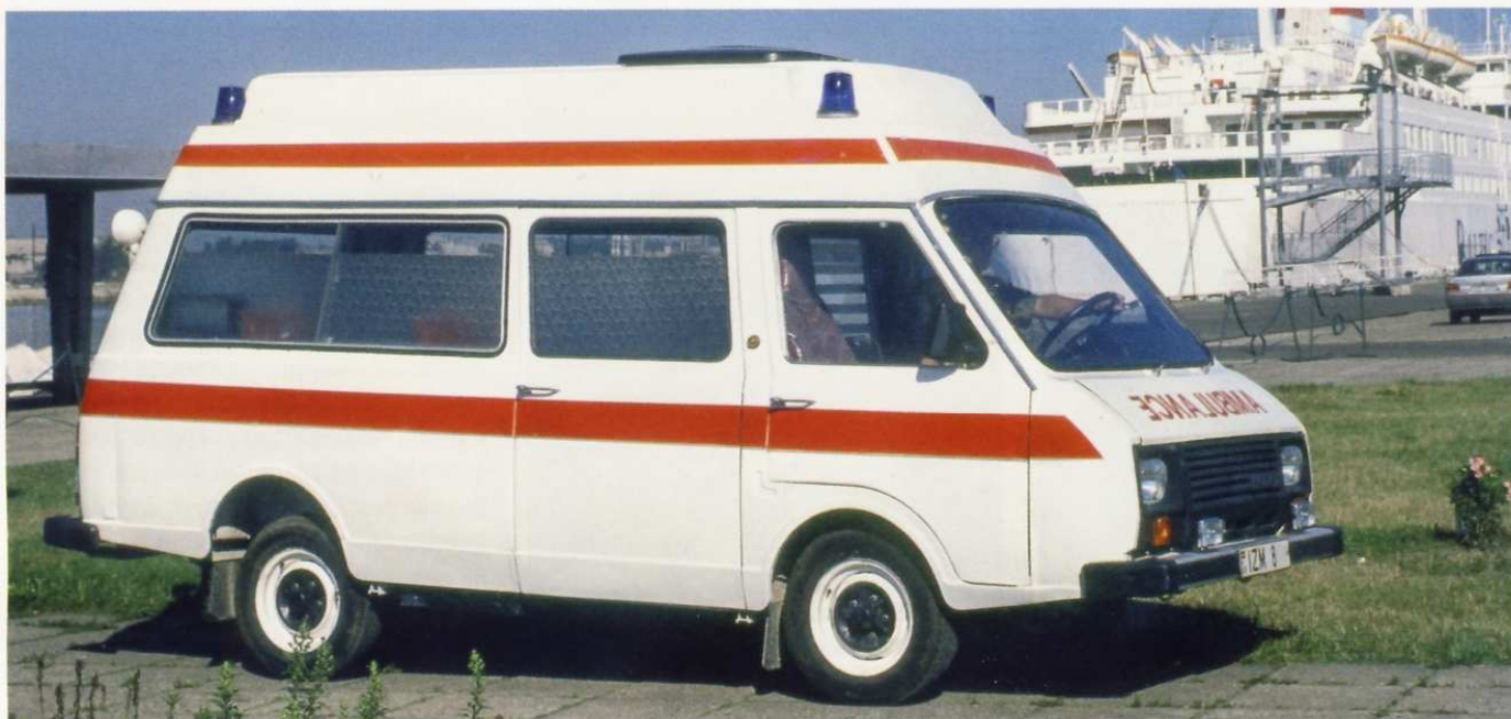
На этом экземпляре вместо штатных проблесковых маячков, закрытых плексигласовыми обтекателями, установлены самые обычные
