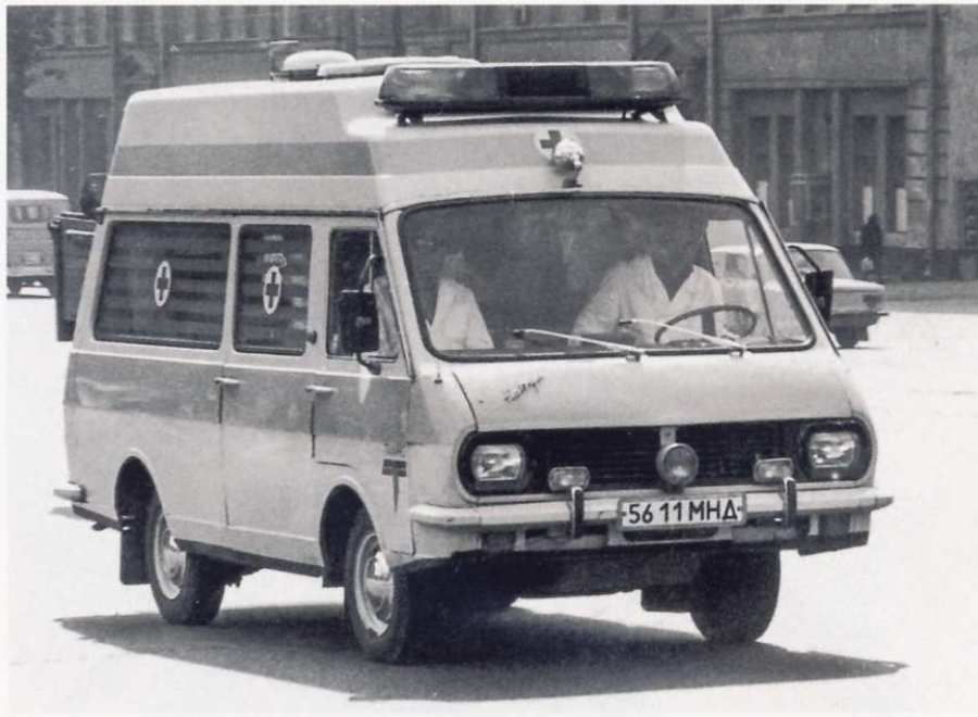
Реанимационный автомобиль скорой медицинской помощи на базе микроавтобуса РАФ, переоборудованный финской компанией Tamro
