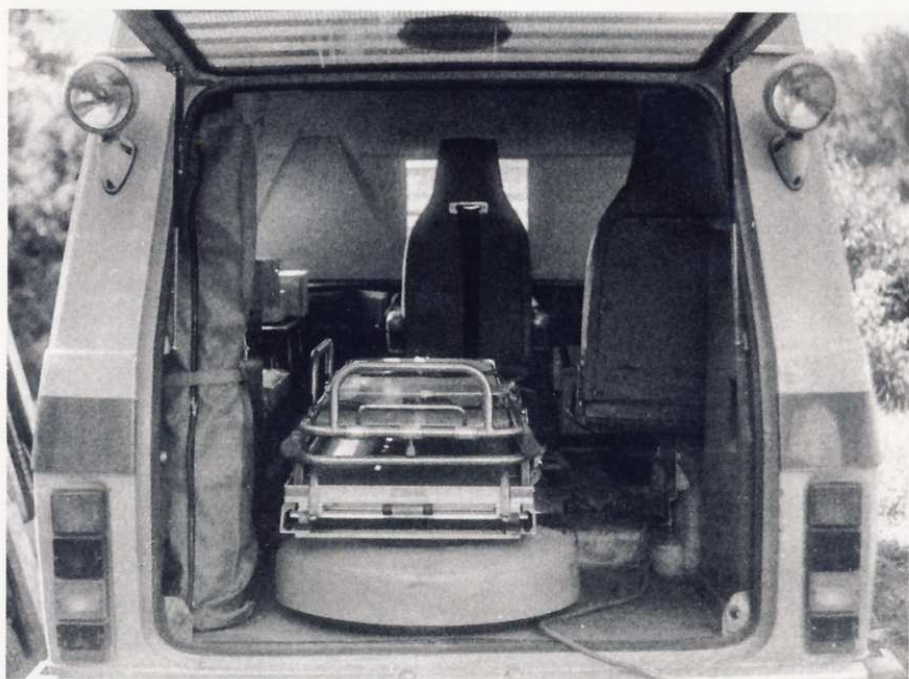
При открытой задней двери хорошо видна планировка медицинского салона
