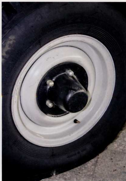
Пластмассовый колпак, закрывающий ступицу переднего колеса на УАЗ-33036
