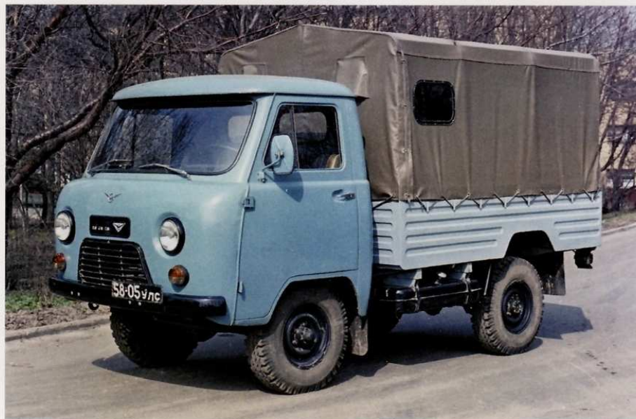
Опытный образец УАЗ-3303 с металлической бортовой платформой с пониженной погрузочной высотой
