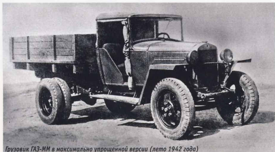
Грузовик ГАЗ-ММ в максимально упрощенной версии (лето 1942 года)
