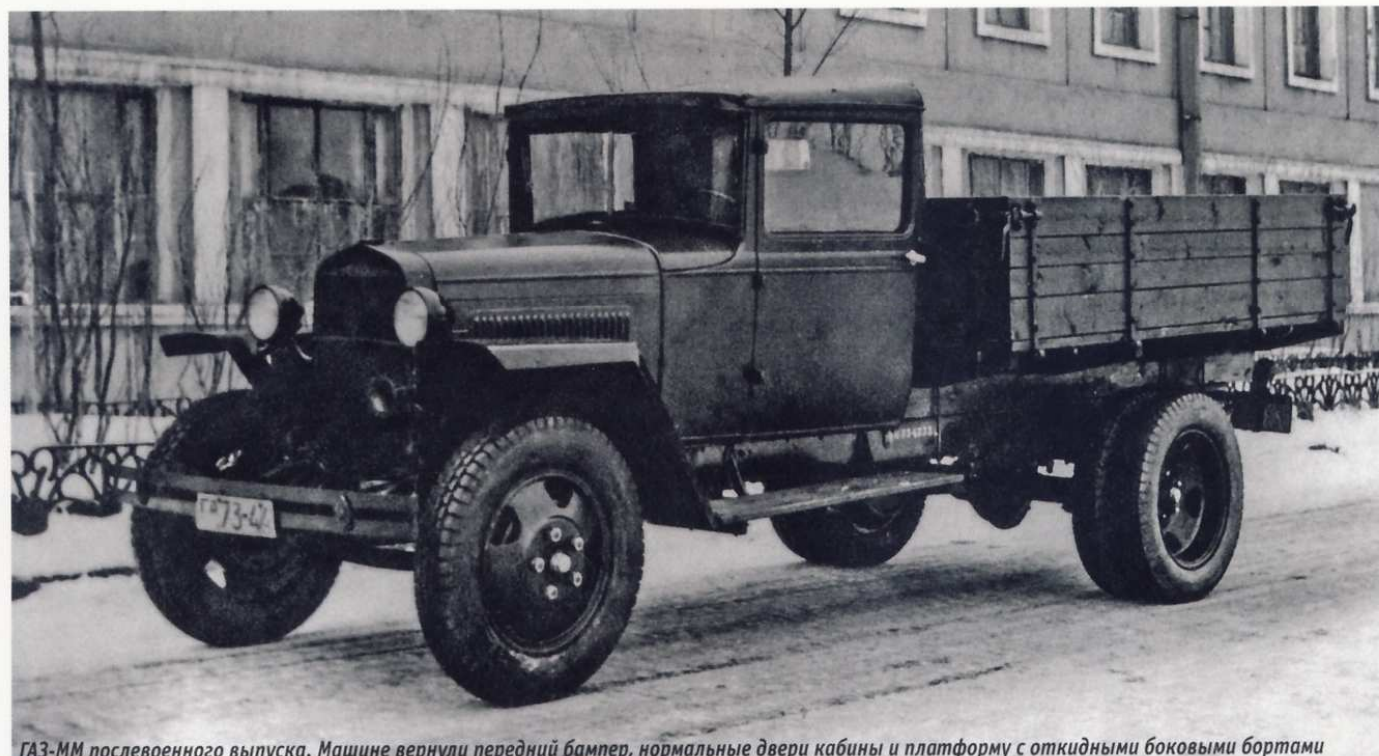
ГАЗ-ММ послевоенного выпуска. Машине вернули передний бампер, нормальные двери кабины и платформу с откидными боковыми бортами
