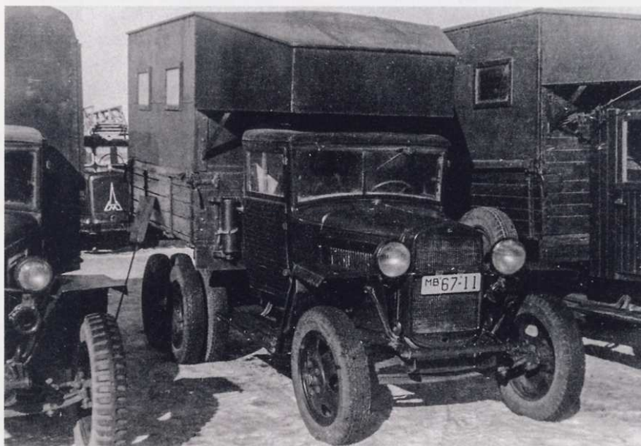
Мастерская, тип «А», на базе грузовика ГАЗ-ААА военного времени
