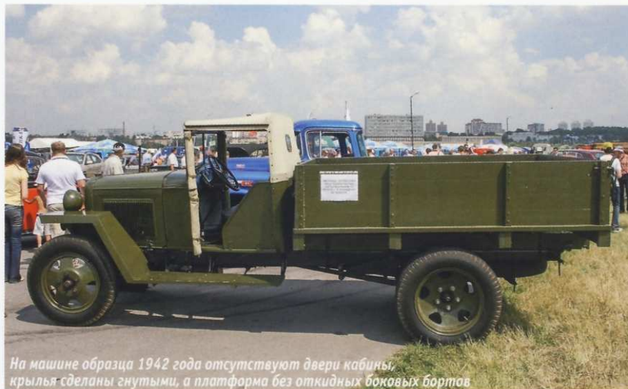
Машина без переднего бампера, тормозов передних колес, одной фары и т.д.
