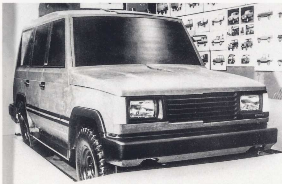
Проработка внешних форм гражданского варианта автомобиля УАЗ-3172 на пластилиновом полноразмерном макете
