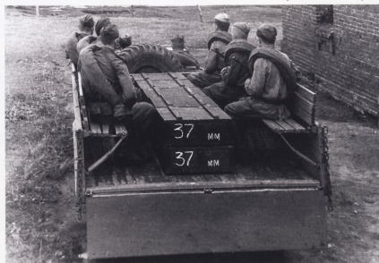
Размещение личного состава и боеприпасов на платформе ГАЗ-68 (образец №4)
