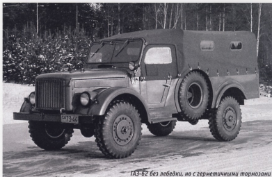
ГАЗ-62 без лебедки, но с герметичными тормозами
