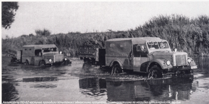
Автомобили ГАЗ-62 частично проходили испытание с одноосными прицепами, размещавшими по нагрузке артиллерийские орудия
