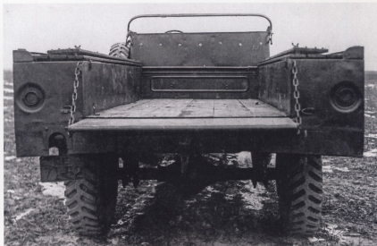
Грузовая платформа и места для размещения личного состава в кузове ГАЗ-НИИАП-2
