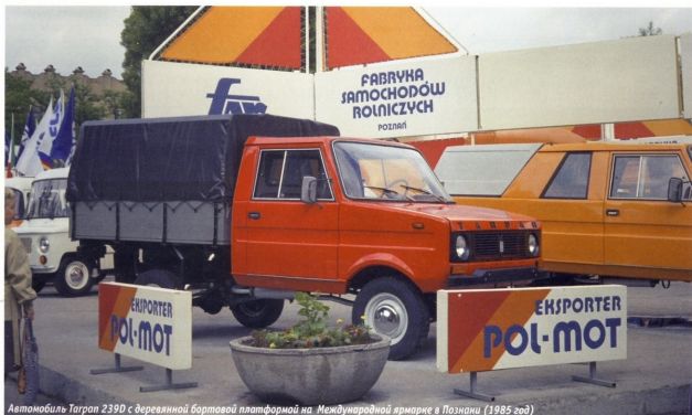
Автомобиль Tarpan 239D с деревянной бортовой платформой на Международной ярмарке в Познани (1985 год)
