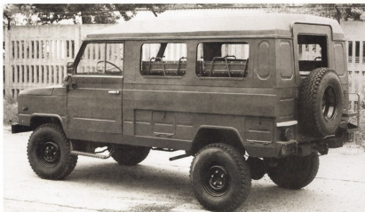
Прототип армейского джипа PW-1 (4x4) с закрытым кузовом
