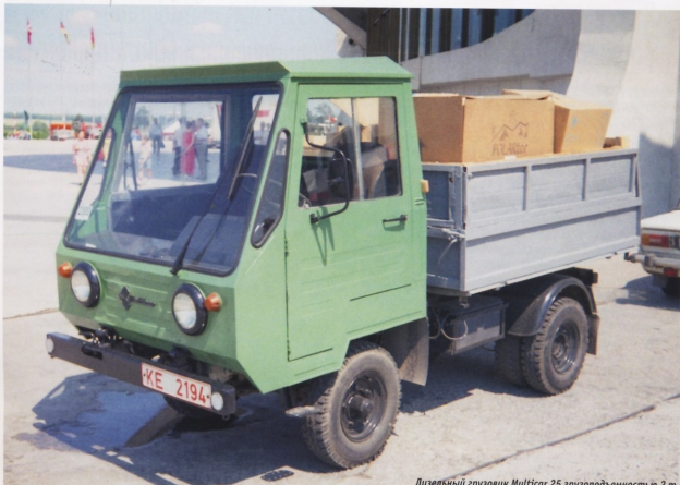
Дизельный грузовик Multicar 25 грузоподъемностью 2 т
