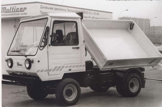
Полноприводной самосвал Multicar 25.1A с четырехцилиндровым дизелем Volkswagen 028.B
