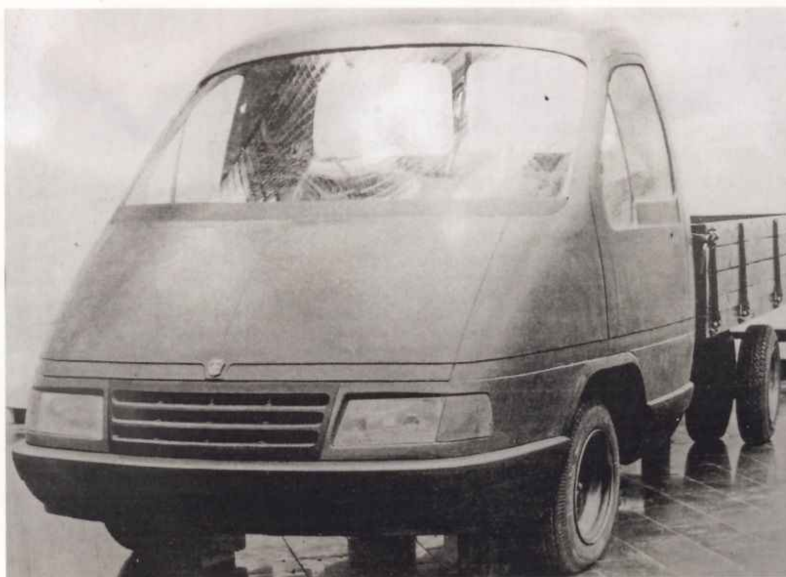
Пластилиновый натурный макет в заводском художественно-конструкторском бюро (ХБК)
