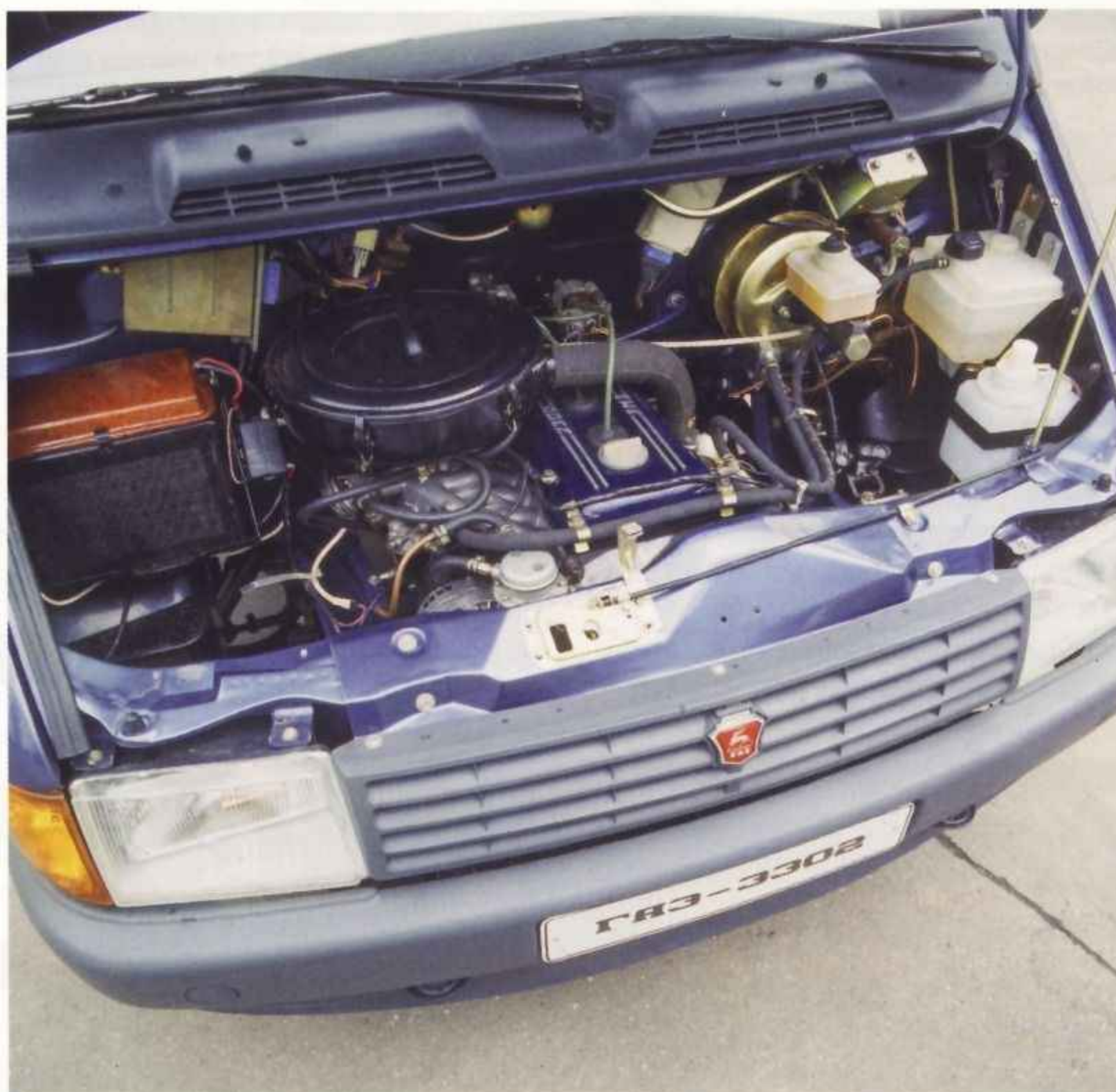
Под капотом «Газели» 16-клапанный мотор ЗМЗ-4061.10
