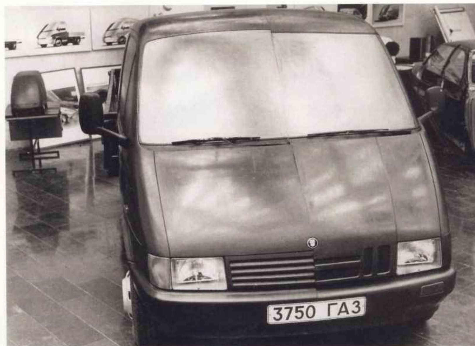
Двусторонний пластилиновый макет в натуральную величину (правая и левая стороны отличаются друг от друга).
