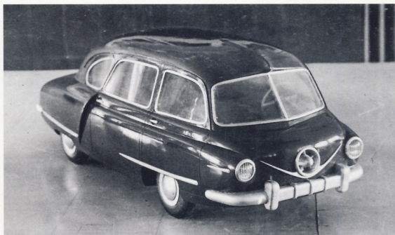
Макет автомобиля НАМИ-013 в масштабе 1:5 (вариант 1949 года)
