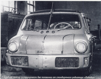
В передний бампер интегрировали две половинки от стандартного радиатора «Победы»
