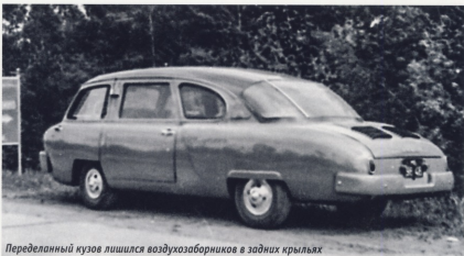
Переделанный кузов лишился воздуховодов на задних крыльях
