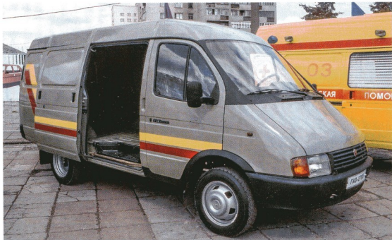
Сдвигающаяся дверь грузового отсека фургона ГАЗ-2705 «Газель»
