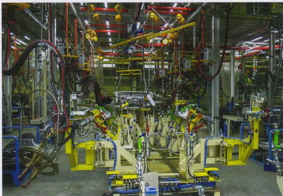
Сварочный кондуктор кузовов UAZ Patriot
