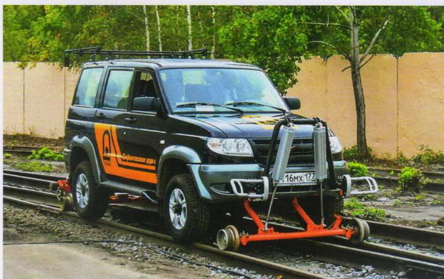
Дефектоскопическая лаборатория на базе автомобиля UAZ Patriot, оборудованного устройством для передвижения по железной дороге
