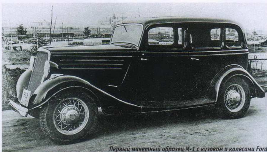
Первый макетный образец М-1 с кузовом и колесами Ford
