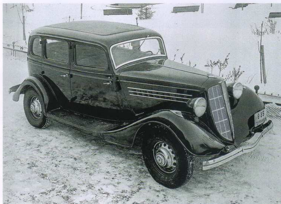
Опытный образец М-1 с кузовом Ford и колесами советского производства
