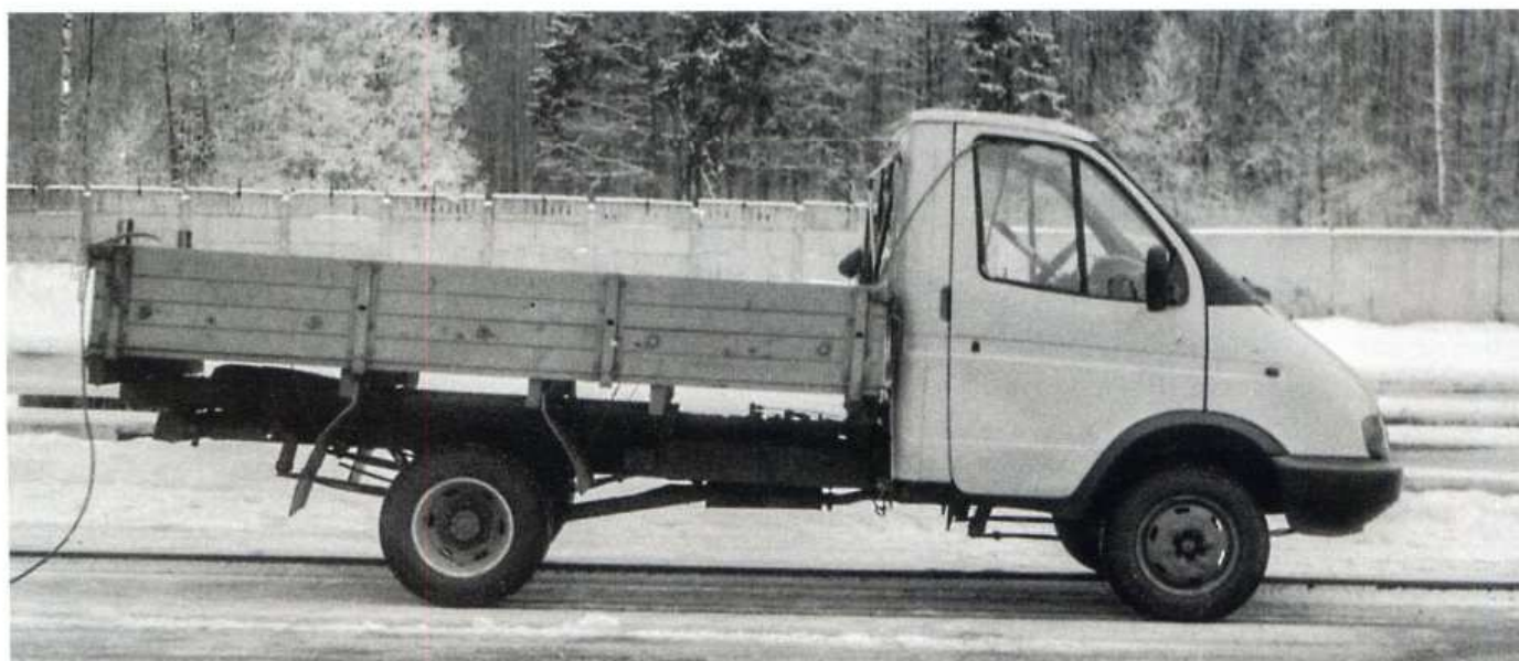
На опытных образцах ГАЗ-3302 применялась деревянная платформа
