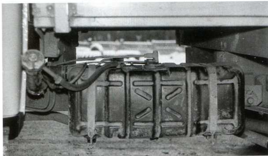
«Газели» первых выпусков оснащались пластиковым топливным баком
