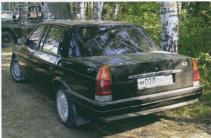
«Князь Владимир» позднего выпуска без вентиляционных решёток и накладки на крышку багажника
