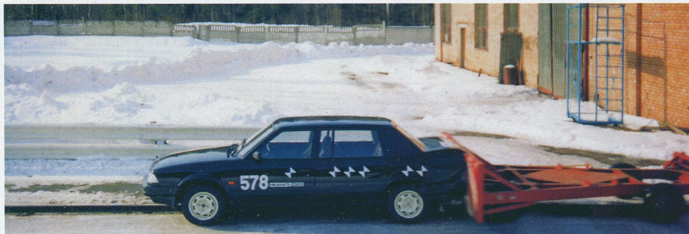
Испытания на пассивную безопасность (краш-тест) автомобиля «Князь Владимир» на Дмитровском автополигоне
