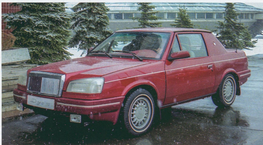
Купе «Дуэт», первый вариант: передок от «Калиты», двигатель Renault
