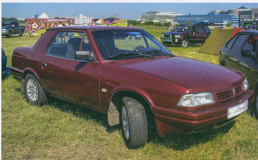
Купе «Дуэт», второй вариант: передок от «Святогора», двигатель ВАЗ
