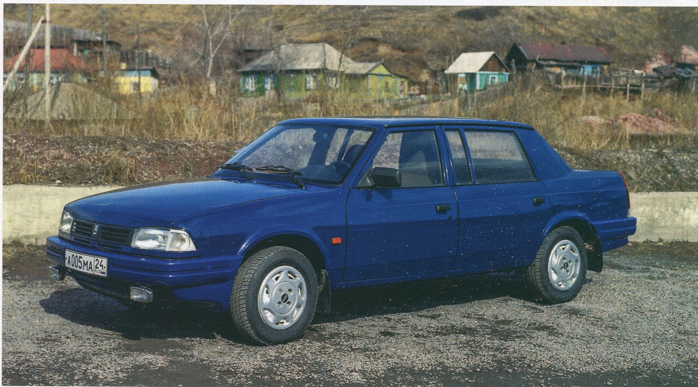
Серийный автомобиль «Князь Владимир» с удлиненной на 200 мм колесной базой
