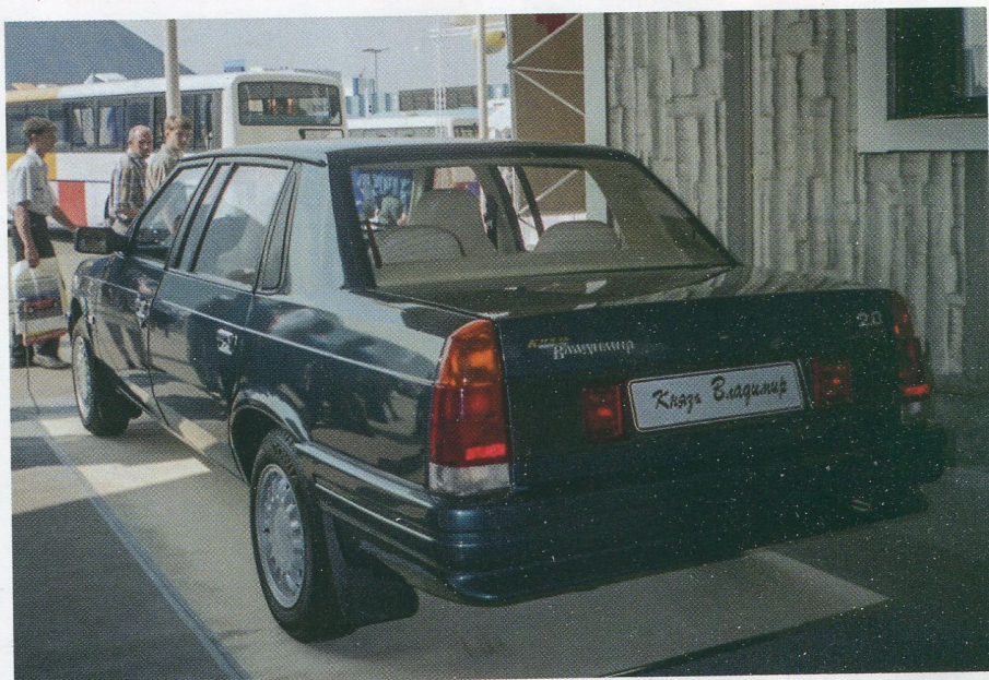
«Князь Владимир» в первоначальном варианте с решетками вытяжной вентиляции на стойках и накладкой на багажник от АЗЛК-2142
