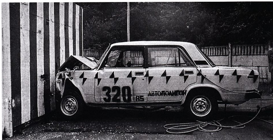
Испытание на пассивную безопасность (краш-тест) ВАЗ-2105 с правым рулем на автополигоне НАМИ
