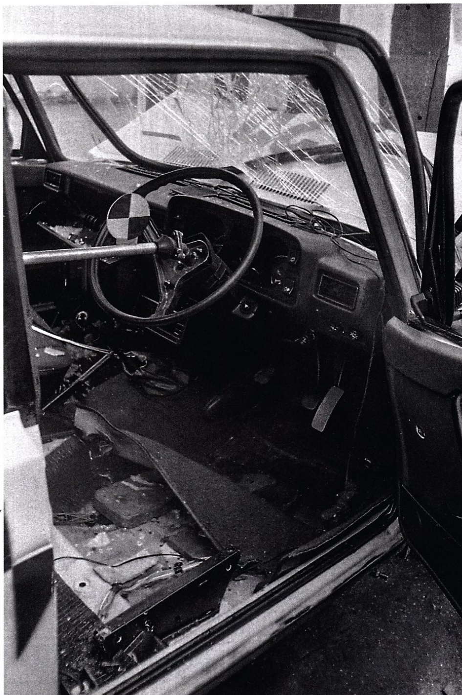
Салон ВАЗ-2105 с правым рулем после испытания на пассивную безопасность
