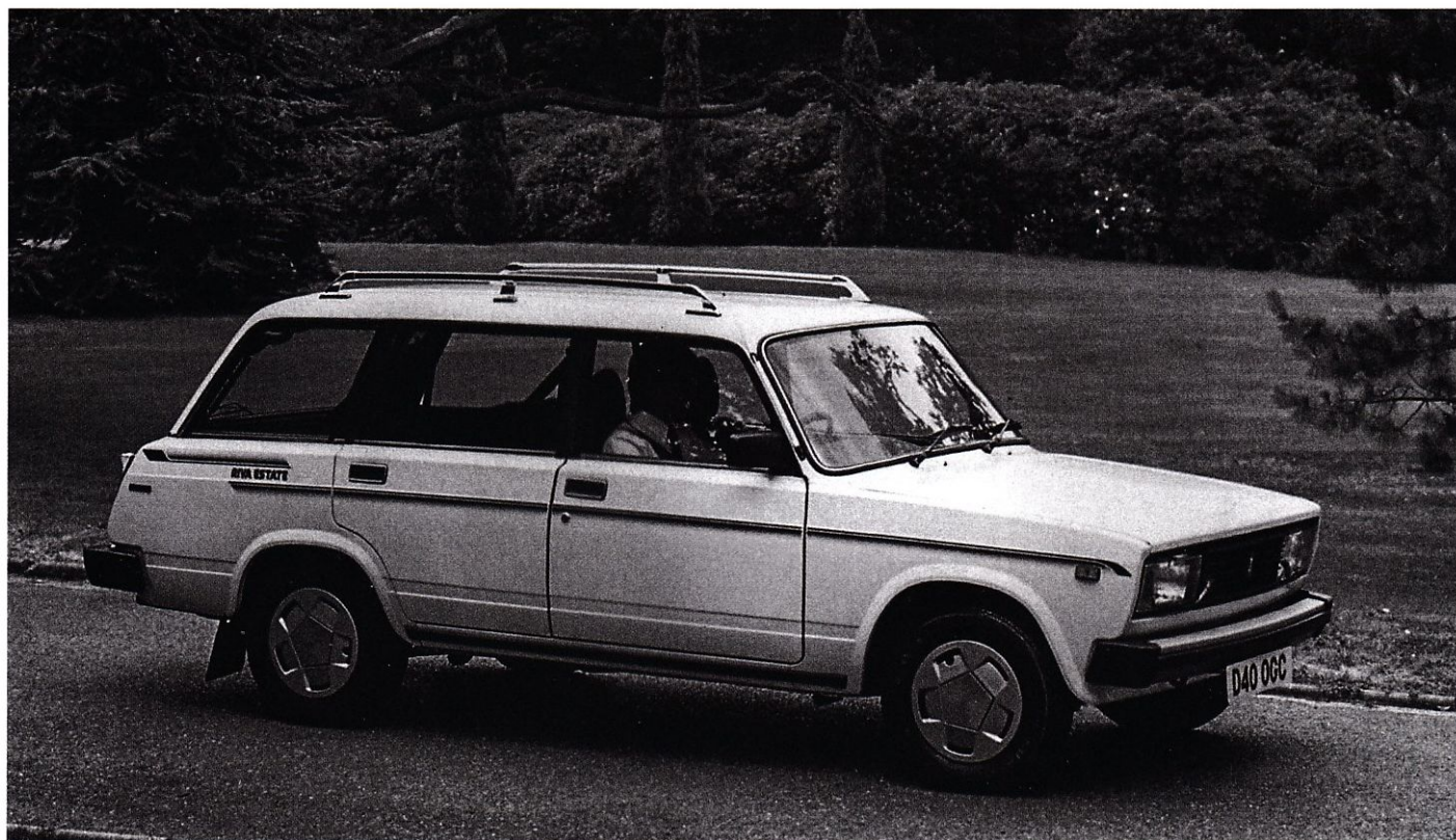
Lada Riva Estate. Приметы экспортного автомобиля: поручни на крыше, наружные зеркала, колесные колпаки, стеклоочистители фар, декоративные полосы на борту
