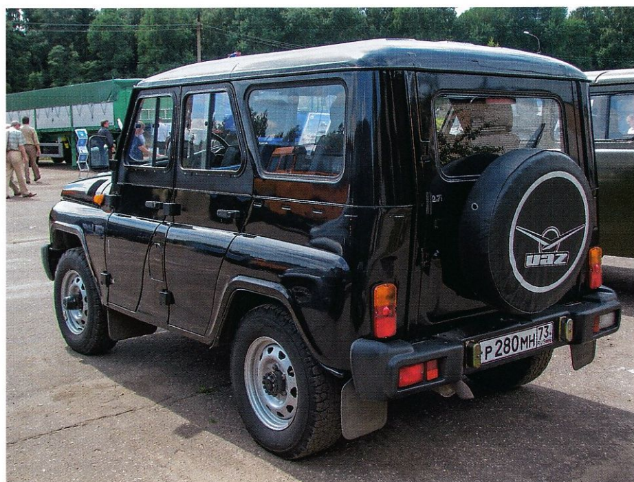
Hunter отличался от УАЗ-31514 цельной задней дверью вместо заднего борта и открывающейся застекленной части и запасным колесом, закрепленным прямо на двери, а не на откидной консоли
