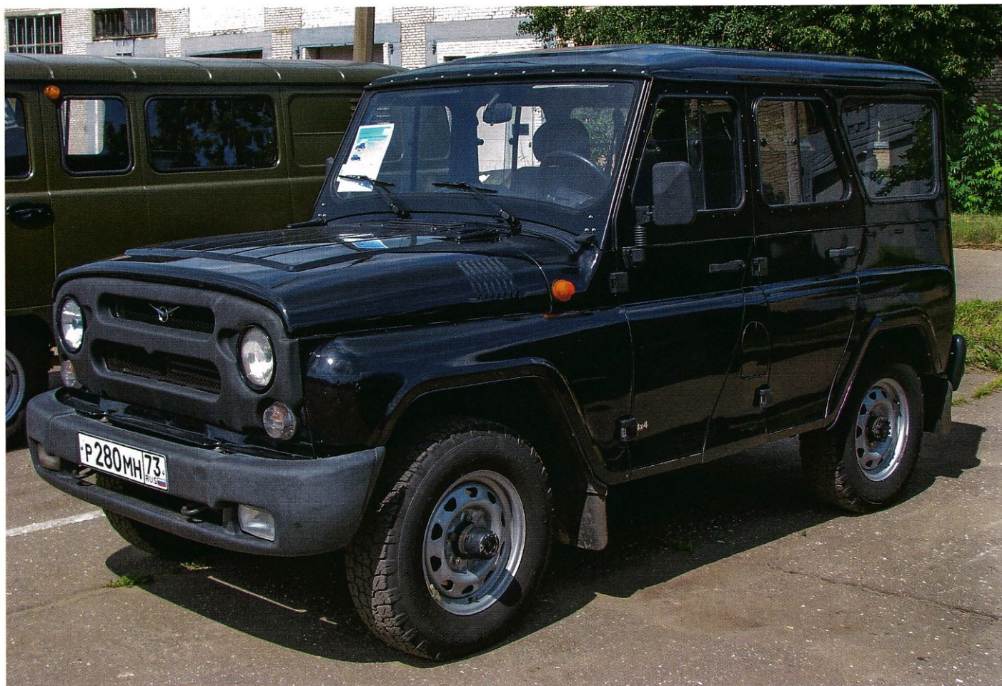
UAZ Hunter первых лет выпуска выделялся пластмассовой накладкой на решетке радиатора и «пухлыми» пластмассовыми бамперами
