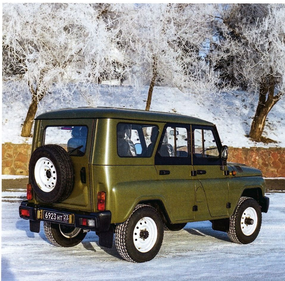
Задний номерной знак, установленный между половинками бампера, отличал модификацию УАЗ-315195 (UAZ Hunter)
