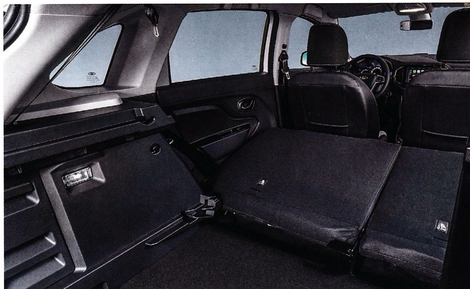
Для перевозки грузов заднее сиденье LADA XRAY складывается по частям в соотношении 2:1
