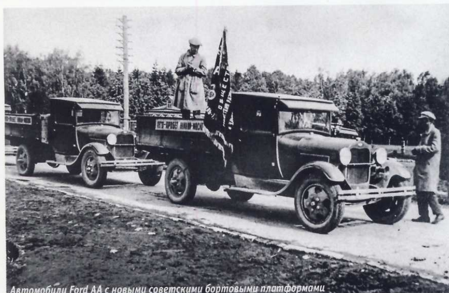
Автомобили Ford AA с новыми советскими бортовыми платформами
