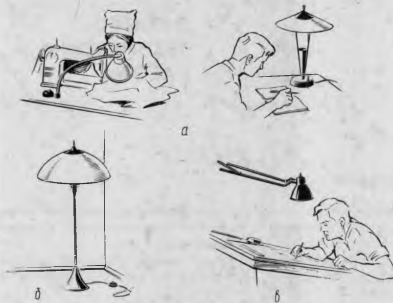
Рис. 67. Светильники местного освещения: а — настольный, б — напольный, в — настенный
