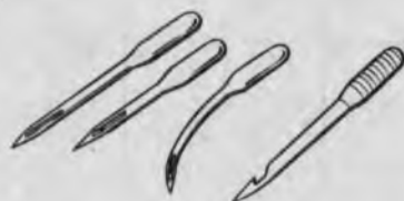
Рис. 31. Виды машинных игл.
