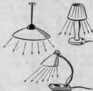
Рис. 71. Светильники направленного света.
