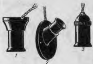
Рис. 80. Ламповые патроны: 1 — прямой потолочный, 2 — настенный, 3 — подвесной.
