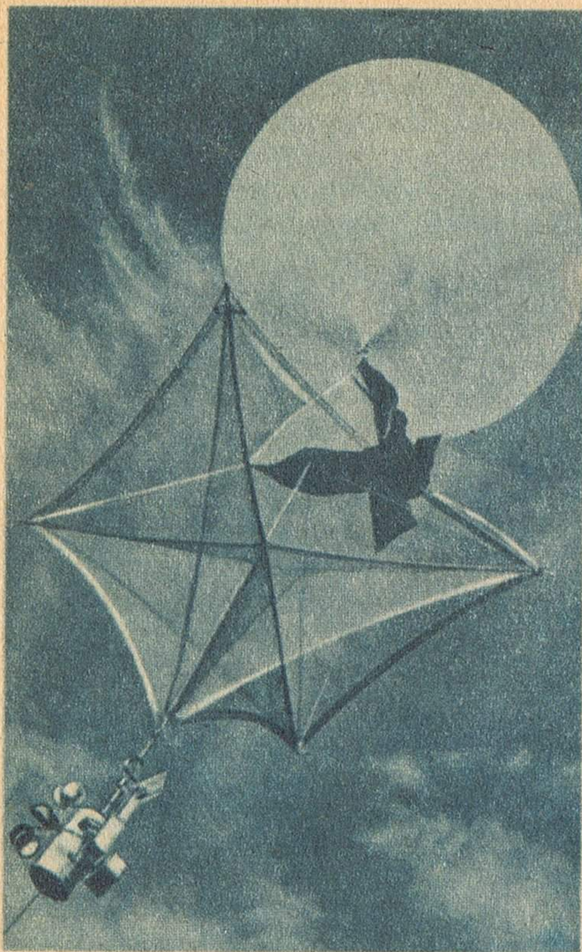
Радиозонд с парашютом и приборами (расстояние между отдельными элементами радиозонда сильно уменьшено).
