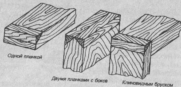
Рис. 1.4.2. Обработка торцов перед фанерованием
