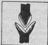
Рис. 2.4.5. Подготовка концов под горновую сварку
