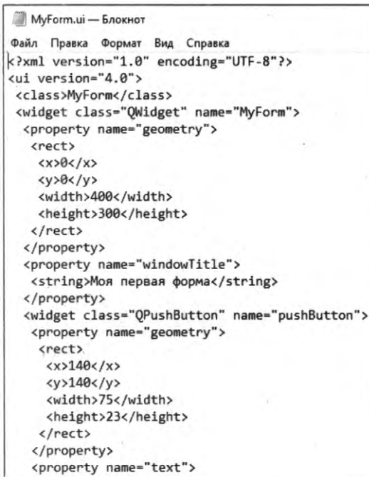
Рис. 2.20. Фрагмент содержимого файла MyForm.ui
