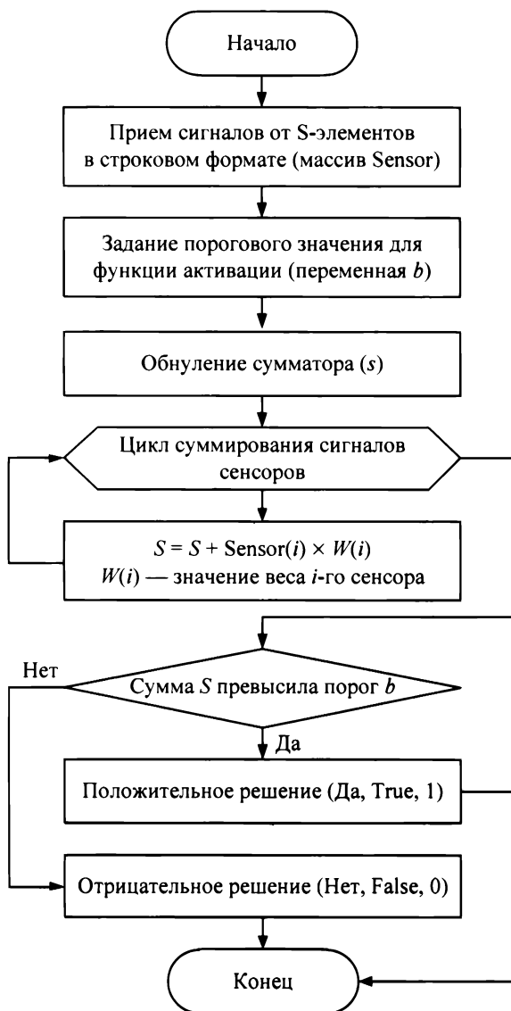
Рис. 4.9. Блок-схема алгоритма работы программы, моделирующей персептрон
