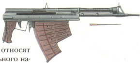
Автомат подводный специальный АПС (СССР/Россия) калибра 5,6 мм с магазином на 26 патронов создан для подразделений борьбы с подводными диверсантами.
