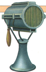
Фонарь Ратьера. Поднимешь ручку — откроются шторки на стекле, луч света прорежет туму.
