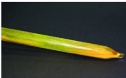
Рис. 4. Запаянная ампула с жидким хлором
