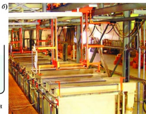
Рис. 115. Очистка меди гальваническим рафинированием: а — схема электролизёра; б — медные аноды перед погружением в гальваническую ванну
