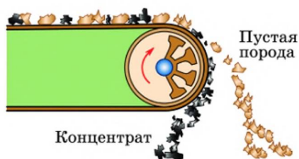
Рис. 167. Обогащение руды на магнитном сепараторе
