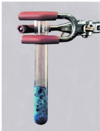
Рис. 102. Получение хлорида хрома(II) взаимодействием хрома с соляной кислотой под слоем бензина
