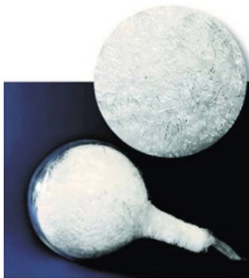
Рис. 28. Игольчатые кристаллы серного ангидрида \text{SO}_3
