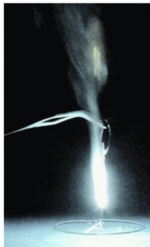
Рис. 74. Горение магния на воздухе
