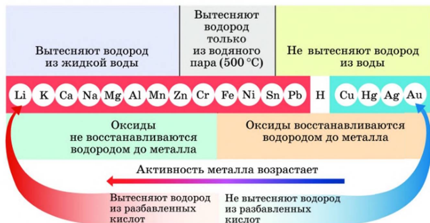
Рис. 63. Электрохимический ряд напряжений металлов
