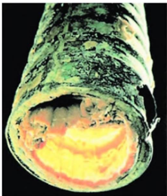
Рис. 79. Разрез трубы, покрытой слоем накипи
