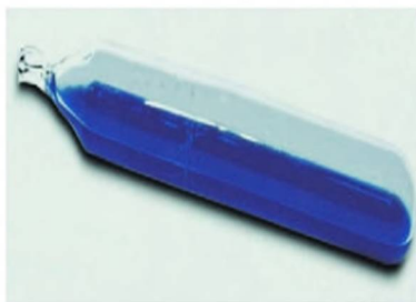
Рис. 41. Ампула с жидким оксидом азота(III)
