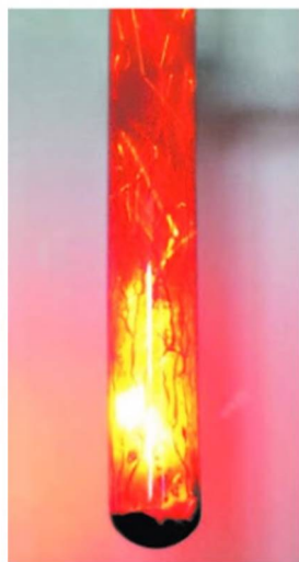
Рис. 85. Взаимодействие алюминия с бромом
