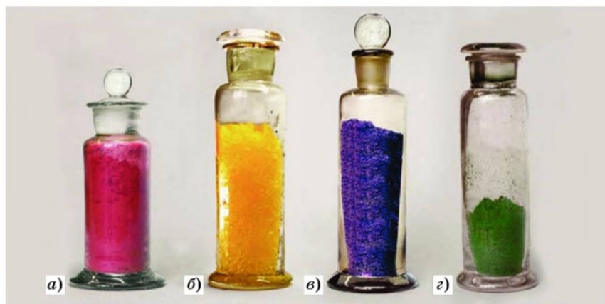
Рис. 103. Соединения хрома: а — хромовый ангидрид \text{CrO}_3 ; б — хромат натрия \text{Na}_2\text{CrO}_4 ; гидраты хлорида хрома: в — [\text{Cr}(\text{H}_2\text{O})_6]\text{Cl}_3 ; г — [\text{Cr}(\text{H}_2\text{O})_5\text{Cl}]\text{Cl}_2 \cdot \text{H}_2\text{O}
