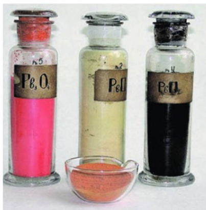
Рис. 93. Оксиды свинца — сурик, массикот, глёт (в чашке), оксид свинца(IV)
