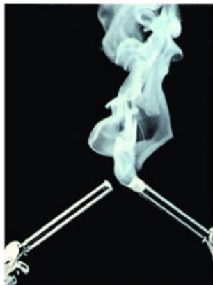
Рис. 36. Взаимодействие аммиака с концентрированной соляной кислотой
