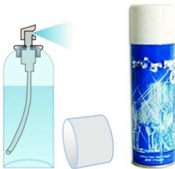
Рис. 196. Устройство аэрозольного баллончика и средство для мытья окон
