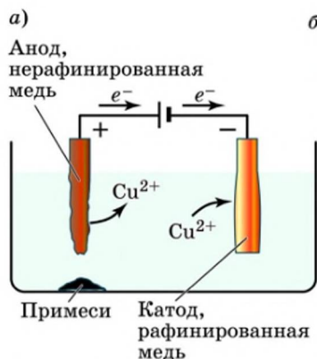
Рис. 115. Очистка меди гальваническим рафинированием: а — схема электролизёра; б — медные аноды перед погружением в гальваническую ванну
