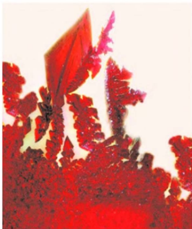
Рис. 14. Кристаллы брома под микроскопом
