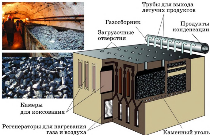
Рис. 176. Каменный уголь и батарея коксовых печей
