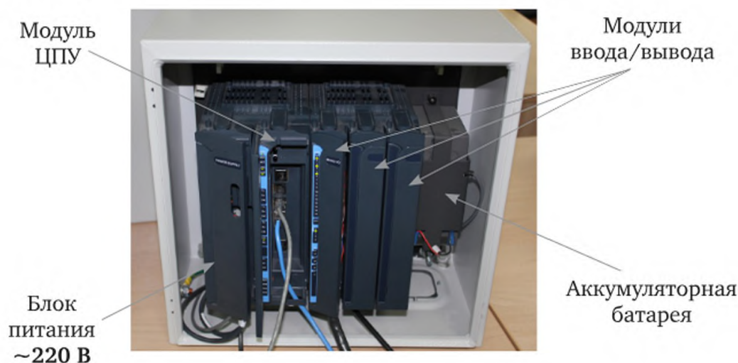
Рис. 6.24. Устройство ПЛК ACE3600 фирмы Motorola
