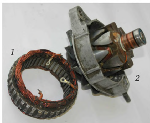
Рис. 3.32. Статор (1) и ротор (2) автомобильного синхронного генератора
