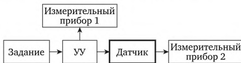
Рис. 2.30. Обобщенная функциональная схема стенда для испытаний датчиков
