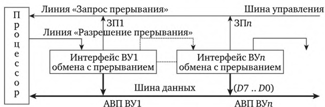
Рис. 5.23. Блок-схема алгоритма идентификации источника запроса прерывания в ЭВМ на основе единого магистрального канала
