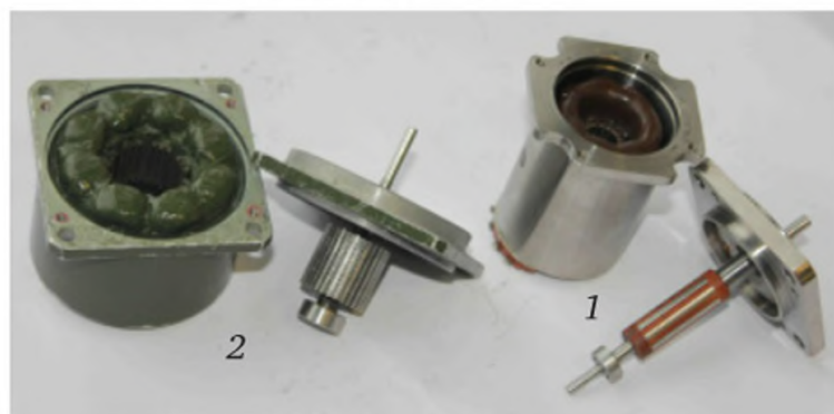
Рис. 3.54. Конструкции шаговых двигателей:
