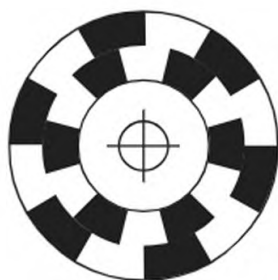
Рис. 2.26. Оптический диск квадратурного энкодера
