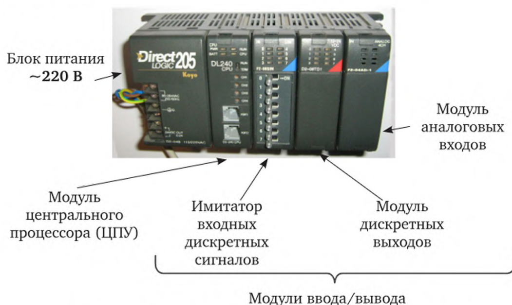
Рис. 6.17. Устройство ПЛК Direct LOGIC серии DL205 фирмы KOYO
