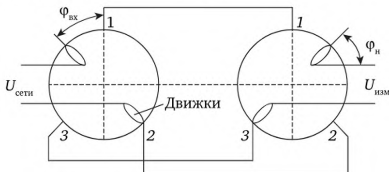
Рис. 3.66. Устройство ИР на потенциометрах без ограничения угла поворота
