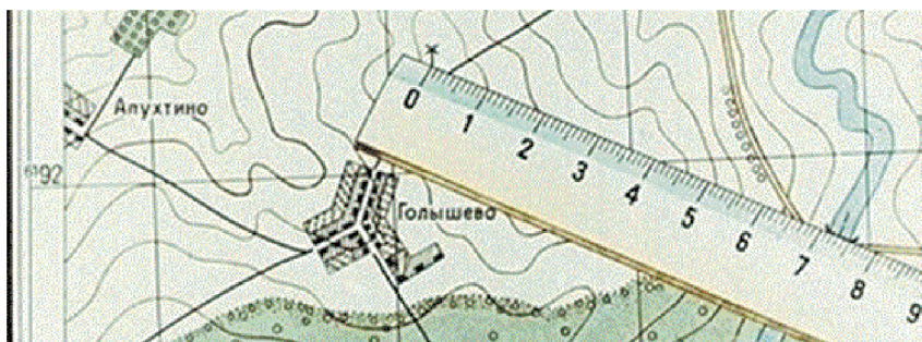
Рис. 10.17. Определение по карте расстояния между точками местности с помощью линейки
