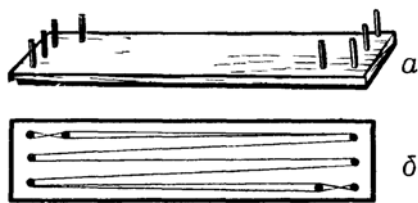
106. Схема снования на настольной сновальной раме.
